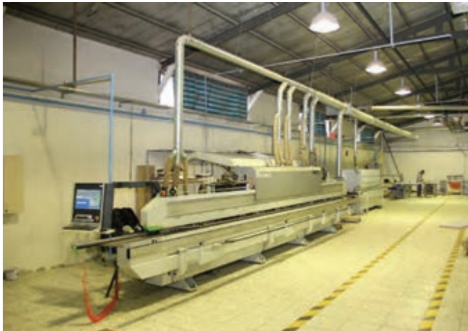
شکل ۱۲- نحوه اتصال مکنده‌های ثابت
