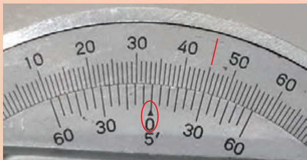
شکل ۱۲- اندازه تنظیمی با زاویه‌سنج
