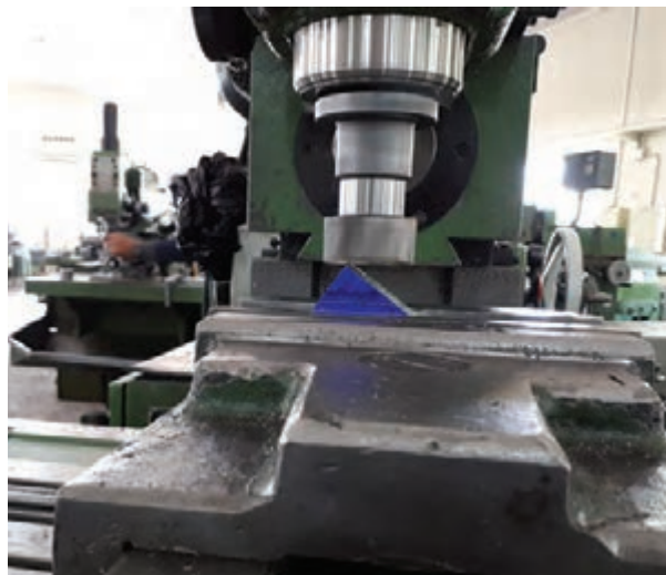
شکل ۱۸- خط‌کشی و بستن قطعه در گیره
