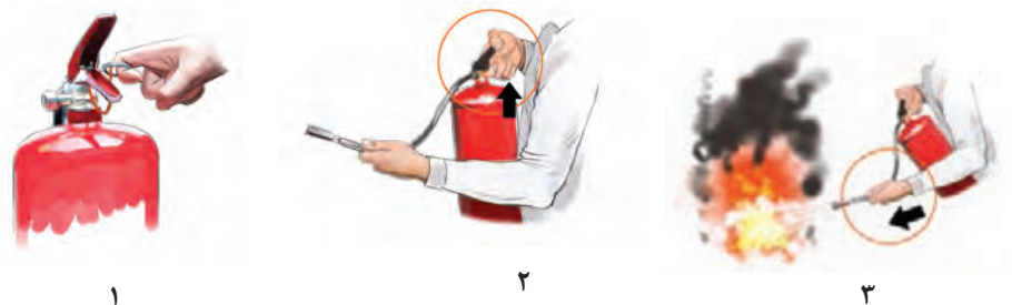
شکل ۳-۳- نحوه استفاده از کپسول آتش‌نشانی ۱
