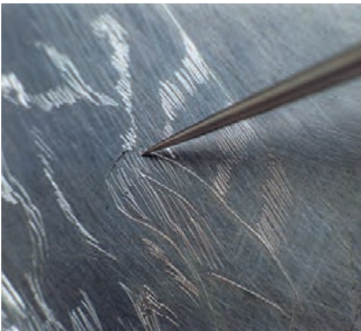
تصویر ۱۷۸- حکاکی خطوط و بافت‌ها با مغار
