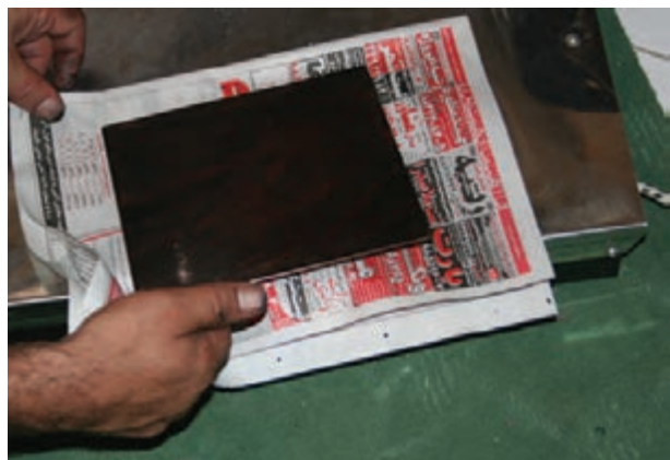
تصویر ۱۸۲- لازم است کلیشه در دو مرحله (قبل از مرکب زدن و پس از پاک کردن مرکب‌های اضافه یعنی درست قبل از چاپ) روی هیتر گذاشته شده و گرم شود.
