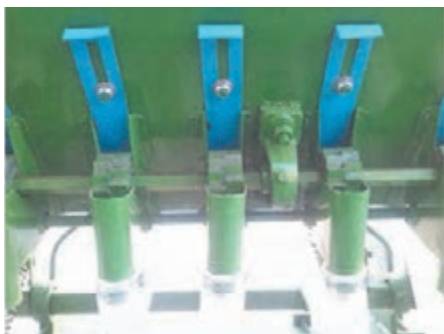
شکل ۲۶-۳. دریچه تغذیه در خطی کار
