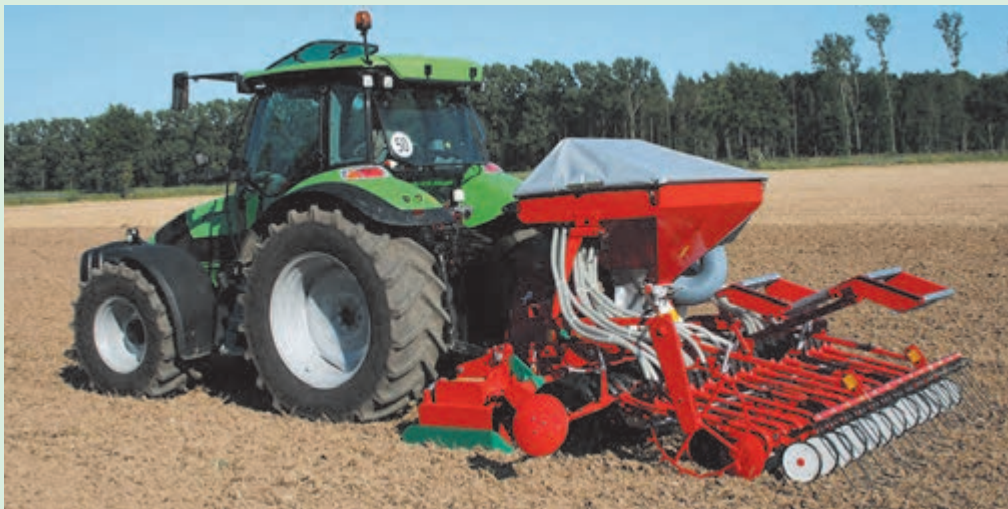
شکل ۱۱-۳. کمبینات (خطی کار مرکب)
