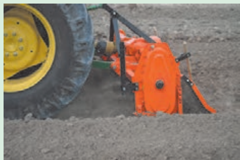
شکل ۴۸-۱. تاثیر درپوش بر خرد شدن خاک
