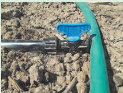
شکل ۱۹-۵. اتصال نوار به لوله و شیر
