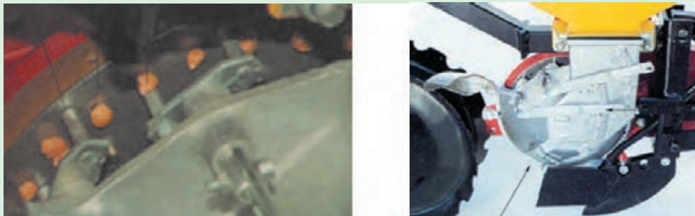
شکل ۳۶-۳. تنظیم تک‌دانه‌کن در ردیف‌کار نیوماتیکی
