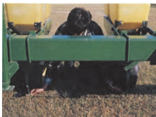
شکل ۲۵-۳. جابجایی ردیف‌های کاشت در ردیف کار
