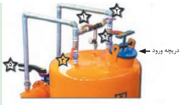
۱ و ۲- شیرهای برگشت (by pass)، ۳ و ۴- شیرهای ورودی و خروجی مخزن، ۵- شیر فلکه روی لوله اصلی
