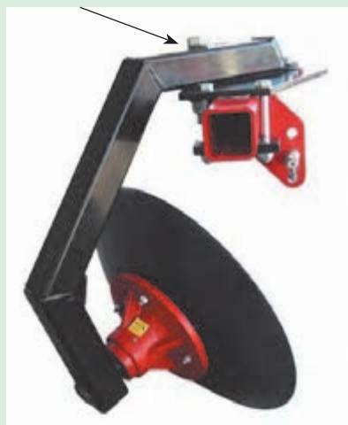
شکل ۴۱-۲. اتصال بشقاب به شاسی
