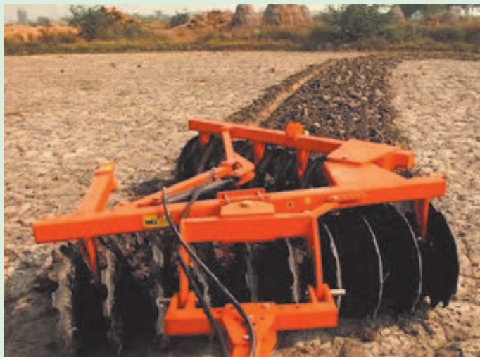
الف. تنظیم زاویه برش به وسیله جک
