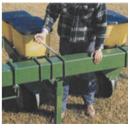
شکل ۲۵-۳. جابجایی ردیف‌های کاشت در ردیف کار
