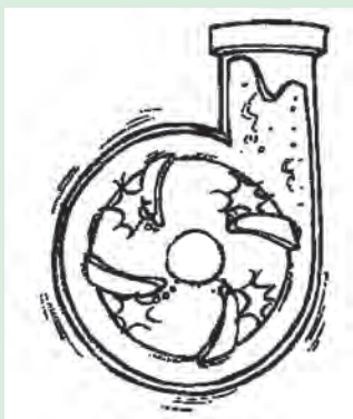
شکل ۲۹-۵. کاویتاسیون در پروانه پمپ
