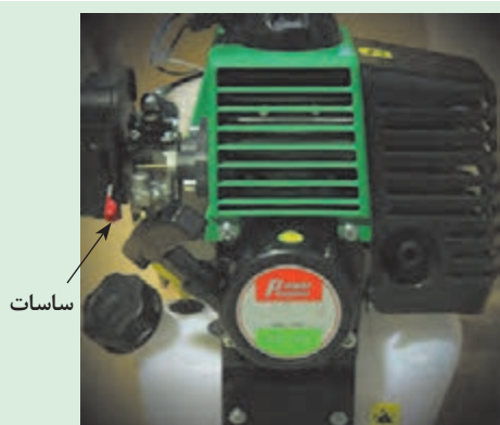
شکل ۵۴-۴. تجهیزات روشن کردن موتور
