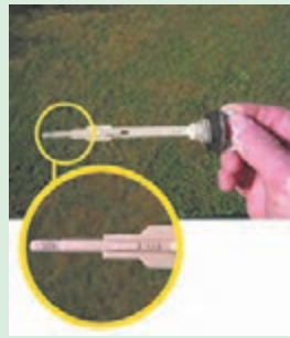
شکل ۵۷-۴. بازدید روغن موتور و شمع موتور
