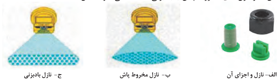
شکل ۳۲-۴. انواع نازل و اجزای آن در سم پاش های تراکتوری بوم دار
