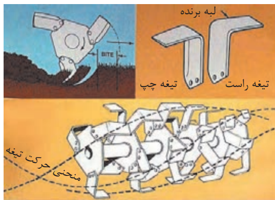
شکل ۱۵-۱. آرایش مارپیچ تیغه‌های گاواهن دوار
