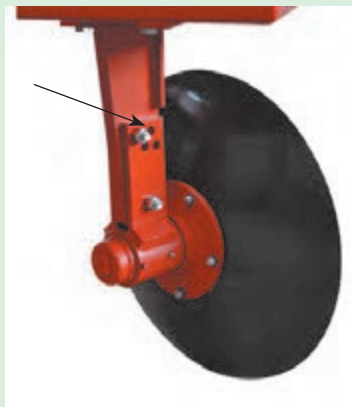
شکل ۴۲-۲. تنظیم زاویه بشقاب
