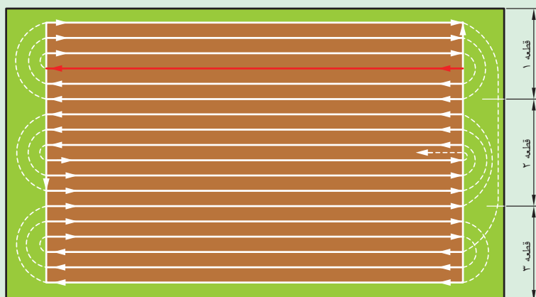
شکل ۳۸-۱. اجرای شخم به روش مداوم
