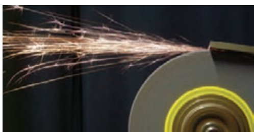
شکل ۴۸-۵- جرقه‌های حاصل از سنگ‌زدن فلزات
