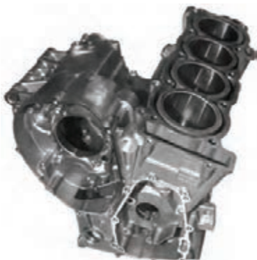
شکل ۲۰-۵- بدنه موتور (چدن خاکستری)
