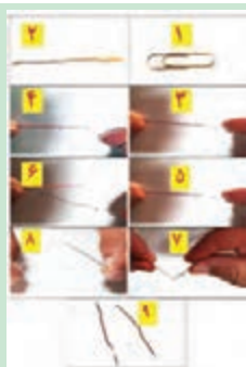
شکل ۱۳-۴- آزمایش بارگذاری روی یک مفتول گیره کاغذ
