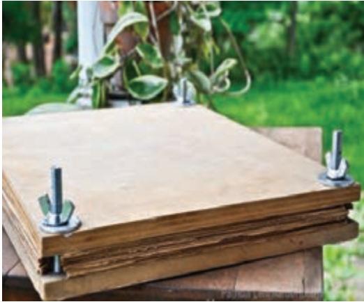
شکل ۱۷- تخته پرس مخصوص خشک کردن نمونه‌های گیاهی
