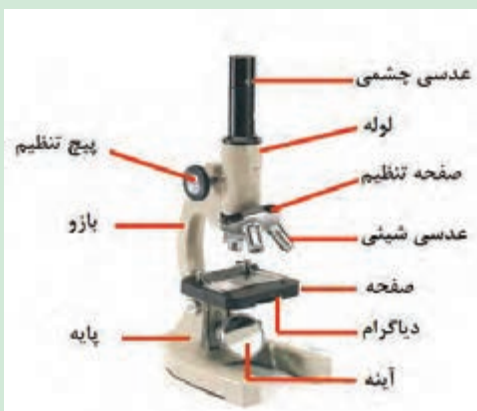
شکل ۲۳- اجزای مختلف نوعی میکروسکوپ
