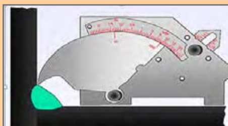
شکل ۱۲-۳- اندازه ساق جوش
