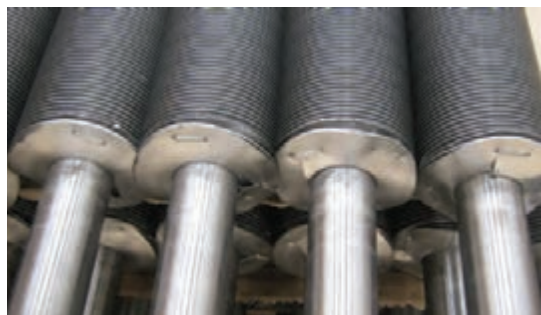
شکل ۲۶- لوله‌های پره‌دار در خنک‌کننده‌های هوایی
