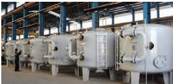
شکل ۵- نمای درونی و بیرونی صافی صنعتی
