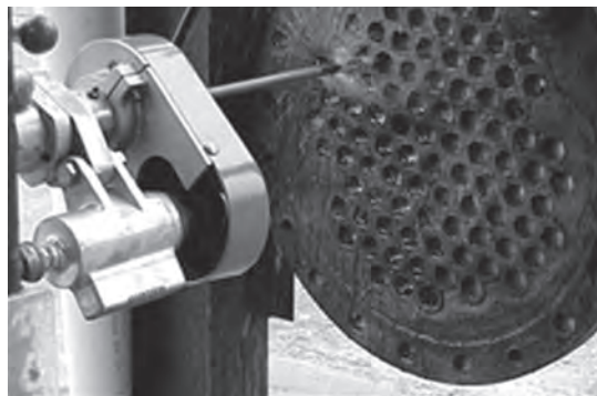
شکل ۲۱- دستگاه تزریق هیدروفورز مکانیکی
