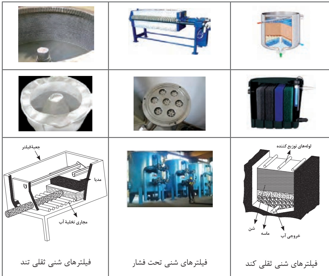
شکل ۱۵- انواع فیلترهای ثقیلی، تحت فشار، گریز از مرکز، بیوفیلتر و غشایی
