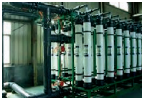
شکل ۱۰- نمایی ساده و واقعی از فرایند اولترافیلتراسیون
