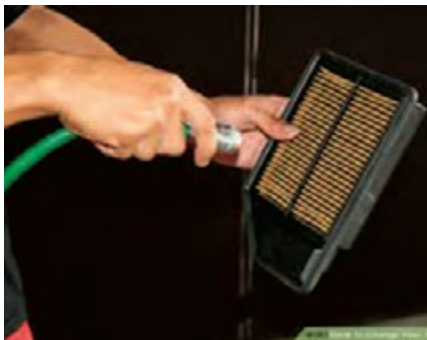
شکل ۳۲- چگونگی تمیز کردن فیلتر با فشار هوا و آب
