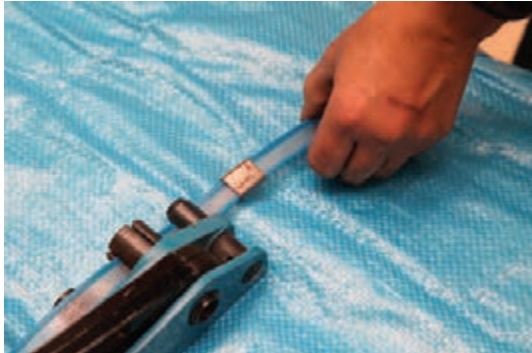
شکل ۸۶- قرار دادن بست فلزی روی نوار پلاستیکی
