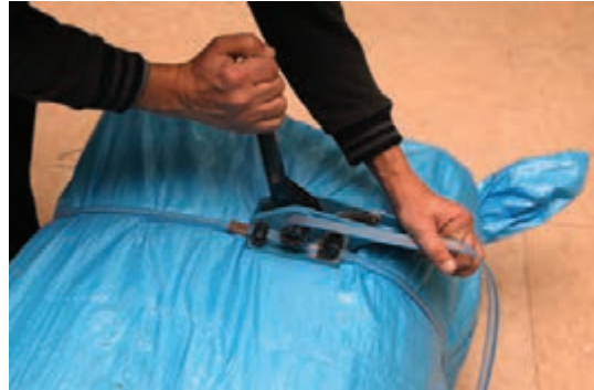
شکل ۸۵- کشیدن نوار به کمک ابزار نوارکش
