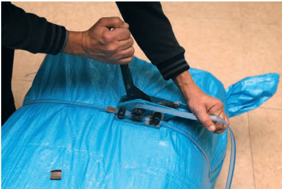
شکل ۲۲- نوارکشی روی بسته با نوار پلاستیکی
