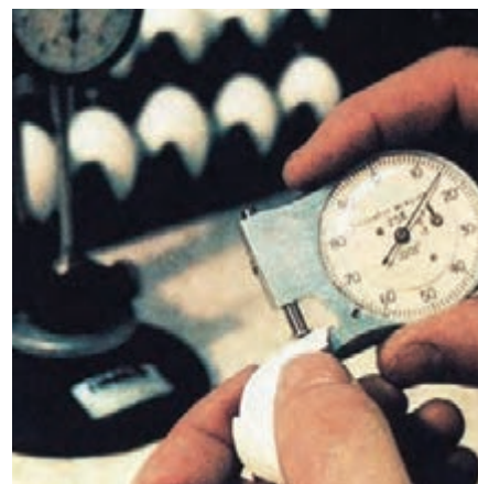
تصویر ۱-۲۵ - اندازه‌گیری ضخامت پوسته با میکرومتر
