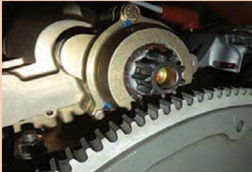
شکل ۱۰۰- ارتباط دنده فلاپیول با دنده استارتر
