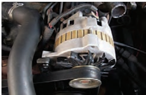
بررسی تسمه از نظر خرابی، پارگی
