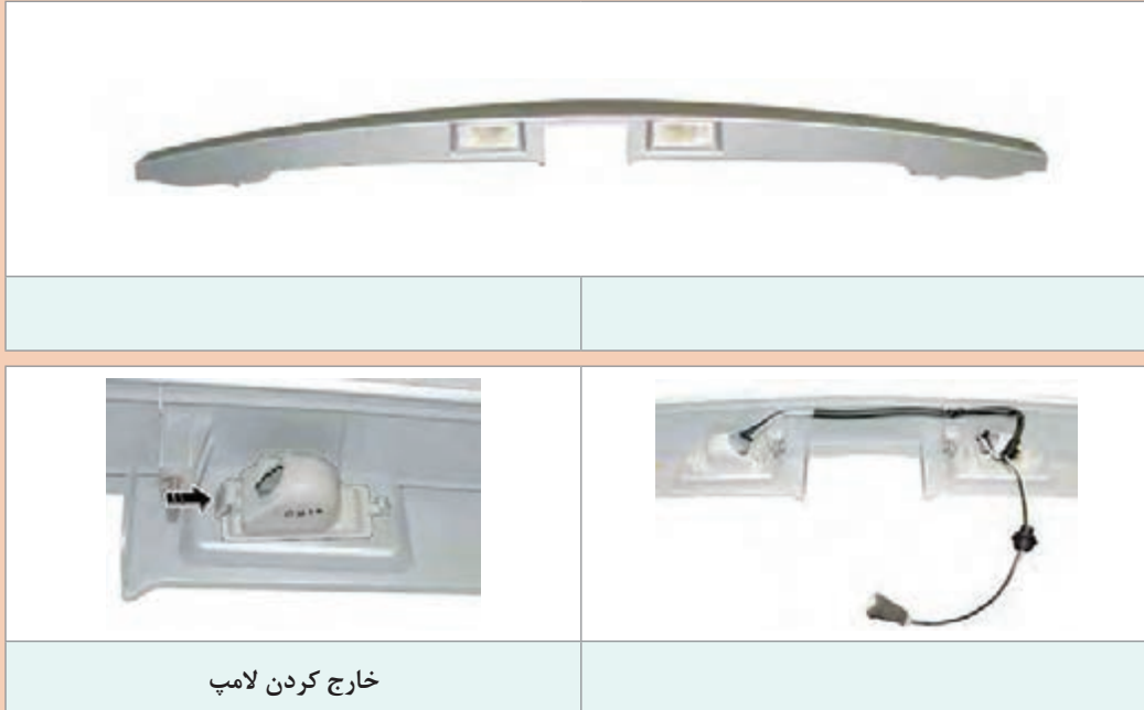
شکل ۳۵- روش باز کردن و بستن چراغ پلاک
