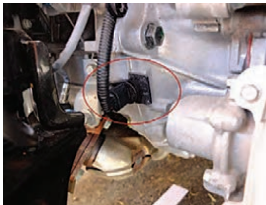
شکل ۱۸- حسگر دور موتور و محل بستن آن
