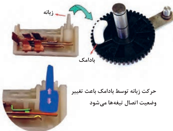
شکل ۸- کلید پارک از نوع پلاتین و بادامک
