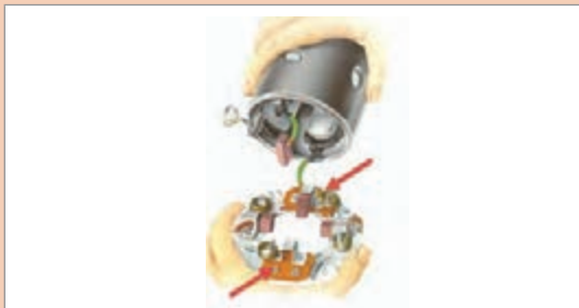
- بررسی عایق بودن پایه‌های زغال مثبت
