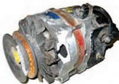
بررسی بدنه از نظر شکستگی یا صدا
