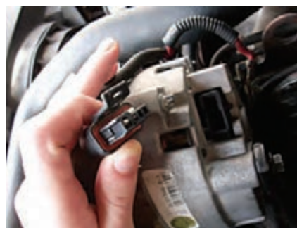
بررسی ظاهری کانکتورها از نظر شکستگی
