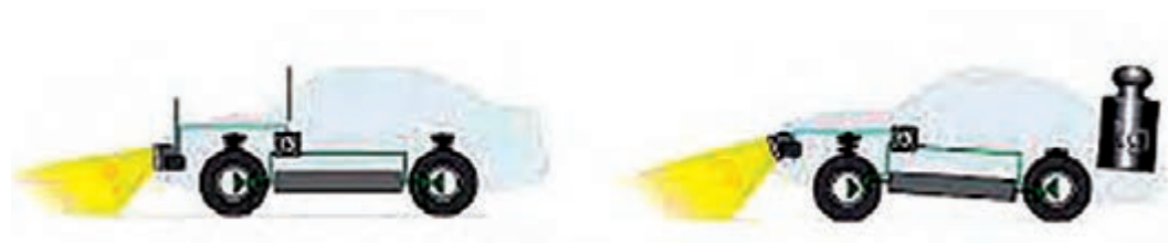
شکل ۹- دلیل نیاز به سیستم تنظیم ارتفاع چراغ
