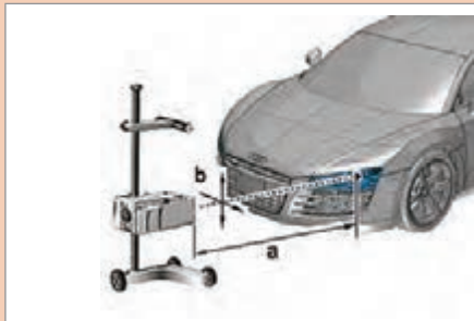
۱- تنظیم فاصله a و b براساس راهنمای کاربر دستگاه
