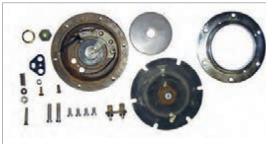
شکل ۴۵- اجزای داخلی بوق الکترومغناطیسی
