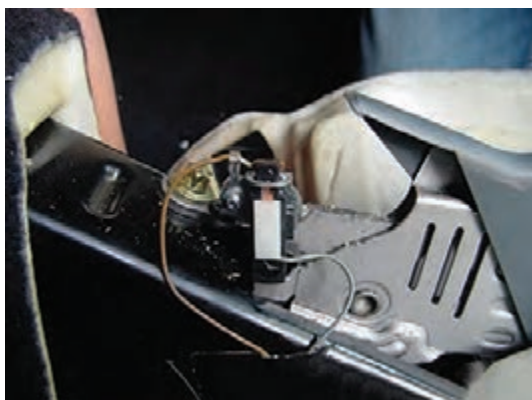
شکل ۲۴- میکروسوییچ ترمز دستی و محل بستن آن
