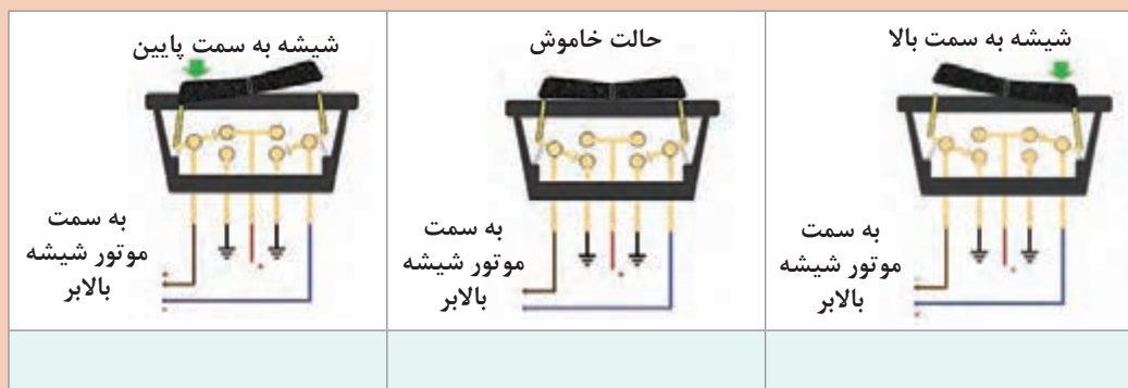
شکل ۶- عملکرد کلید شیشه بالابر الکتریکی
