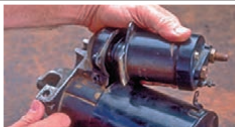
- خارج کردن اتوماتیک استارتر
