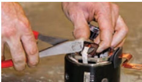
شکل ۹۹ – برخی نکات لحیم کاری زغال‌های استارتر
