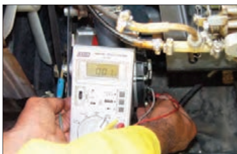
شکل ۳۰- آزمایش اجزای داخلی آلترناتور
