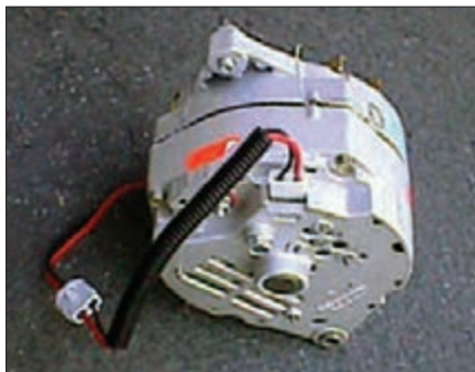
شکل ۱۸- آلترناتور مجهز به آفتامات الکترونیکی
