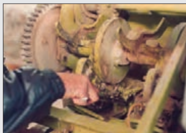
شکل ۴۴- باز کردن کفشک گره زن
