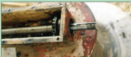
شکل ۲۸- خارج کردن محور افقی از محل درپوش
