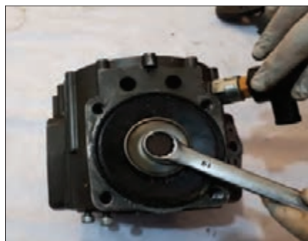
شکل ۴۶- باز کردن دیافراگم
