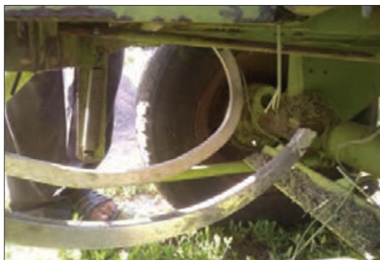
شکل ۵۷- سوزن شکسته
