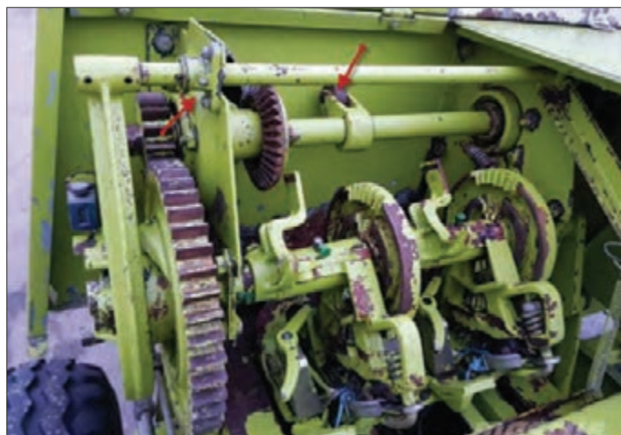
شکل ۷۵- یاتاقان‌ها و نگهدارنده فرمان‌دهنده گره‌زن
