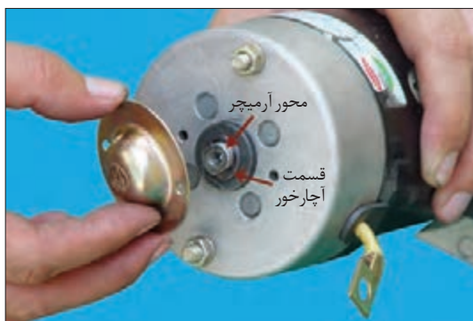
شکل ۴۴- درپوش انتهایی موتور استارت
