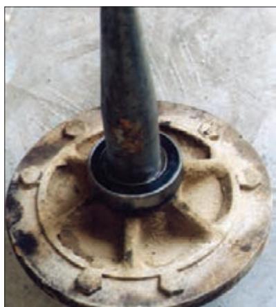
شکل ۴۹- محور استوانه و بلیرینگ
