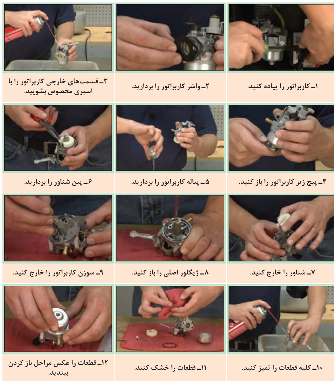
شکل ۲۵- باز کردن و تمیز کردن قطعات کاربراتور
