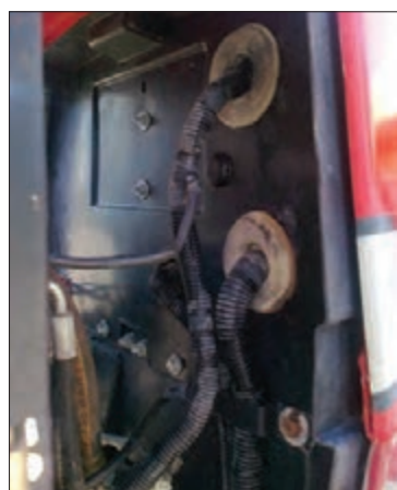
شکل ۳- ثابت کردن کلاف روی بدنه تراکتور
