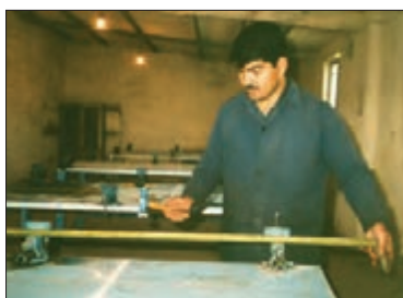
شکل ۱۱- صاف کردن محور انگشتی
