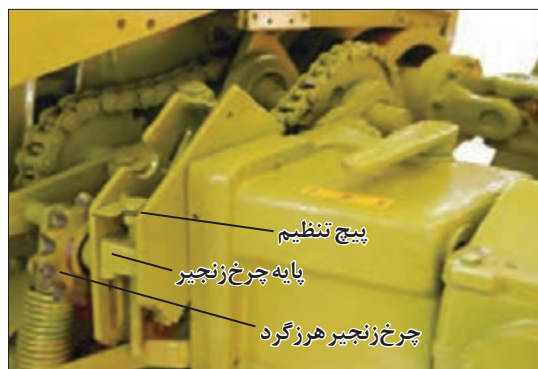
شکل ۷- زنجیر سفت کن با چرخ زنجیر واسطه
