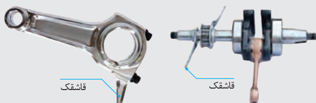
شکل ۴- قاشقک‌های روی شاتون و میل لنگ
