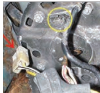
شکل ۲۶- جدا کردن کائوچویی سیم‌کشی لامپ شارژ
