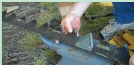
۶- وضعیت تیغه و پرچ‌ها را بررسی کنید.
