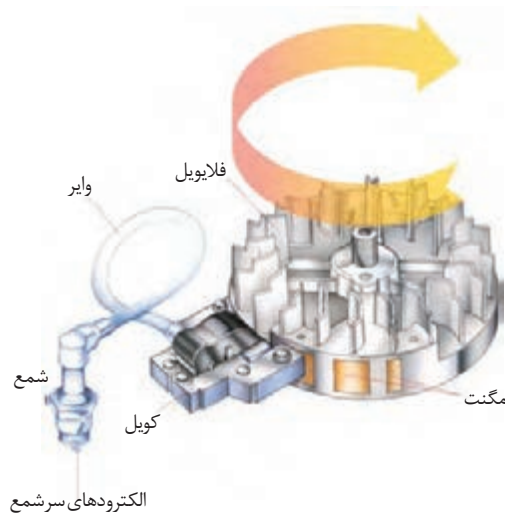
شکل ۷- طرز کار سیستم جرقه زنی
