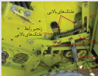
شکل ۴۰- قطعات مرتبط با غلتک‌های بالایی
