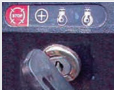
شکل ۹- مراحل سوئیچ تراکتور MF399
