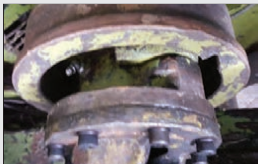
شکل ۴۸- پیچ‌های اتصال کلاچ به یوک چهارشاخه گاردان
