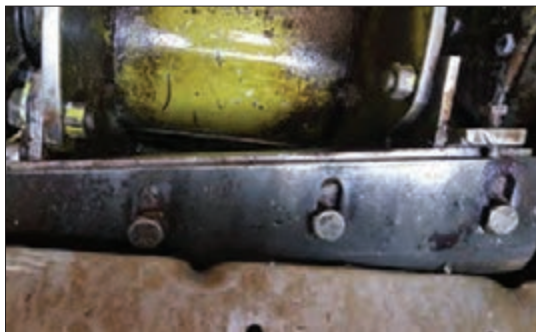
شکل ۴۴- پیچ و شیارهای رگلاژ تیغه متحرک
