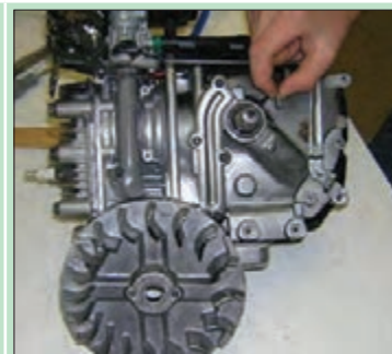
۱- کوئل را با باز کردن پیچ‌های اتصال و جدا کردن فیش آن پیاده کنید.
