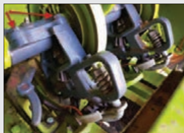
شکل ۴۵- پیچ‌های پوسته گره زن
