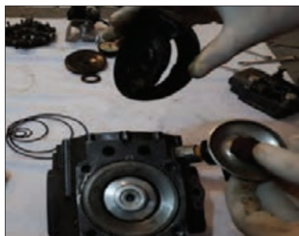
شکل ۴۷- برداشتن دیافراگم
