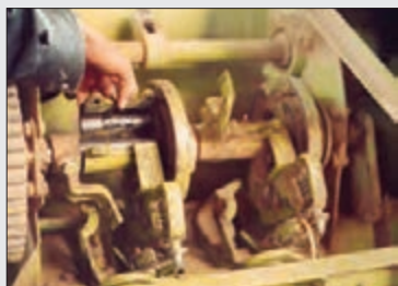
شکل ۴۶- برداشتن پوسته گره زن
