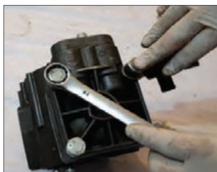
شکل ۴۵- باز کردن درپوش
