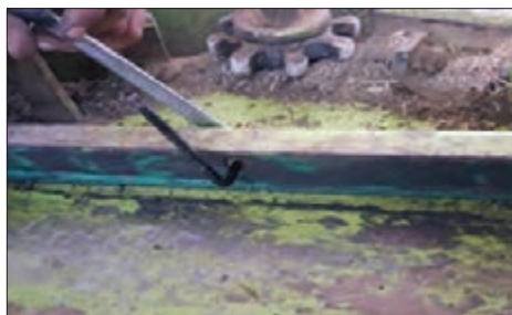
شکل ۲۰- باز کردن راهنمای زنجیر
