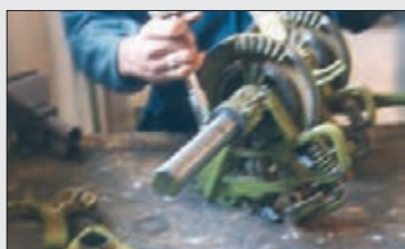
شکل ۷۶- پیاده کردن محور گره زن و اجزای آن
