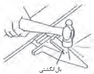
شکل ۶۶- کم کردن فاصله بال با تیغه
