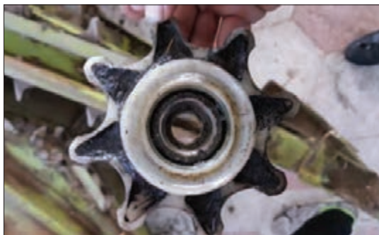
شکل ۱۹- چرخ زنجیر زنجیرهای هدایت‌کننده
