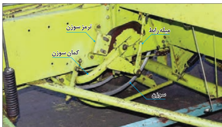
شکل ۵۴- اجزای قسمت سوزن ها
