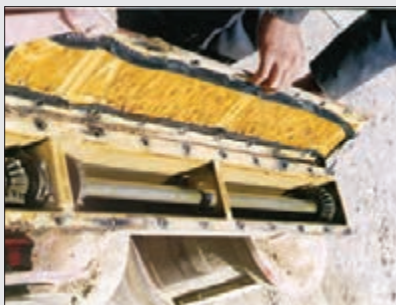
شکل ۲۱- برداشتن سرپوش جعبه دنده
