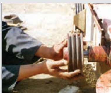
شکل ۱۱- برداشتن چرخ تسمه
