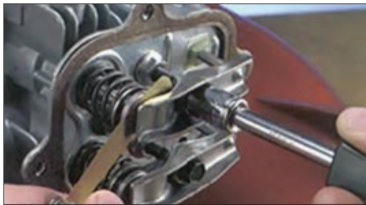
شکل ۳۵- فیلر کردن سوپاپ
