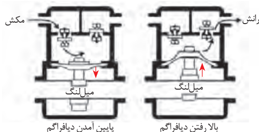
شکل ۴۱- طرز کار پمپ دیافراگمی
