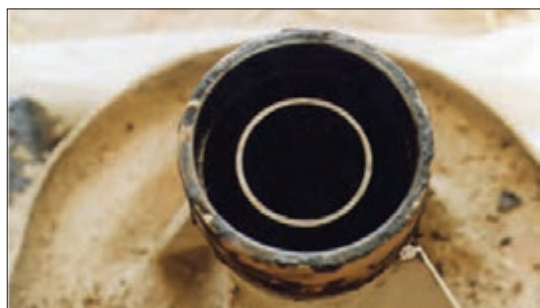
شکل ۴۳- ساییدگی جای بلبرینگ
