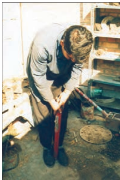
شکل ۲۷- آزمایش کمک فنر
