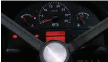
شکل ۵۹- هشداردهنده‌های روی داشبورد
