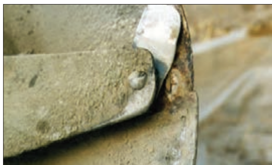
شکل ۴۲- خوردگی لبه استوانه
