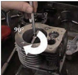
شکل ۲۸- کنترل دو پهنی سیلندر
