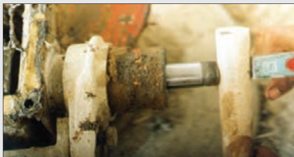
شکل ۲۳- خارج کردن محور ورودی
