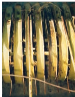
شکل ۲۲- تسمه ساییده و کج شده
