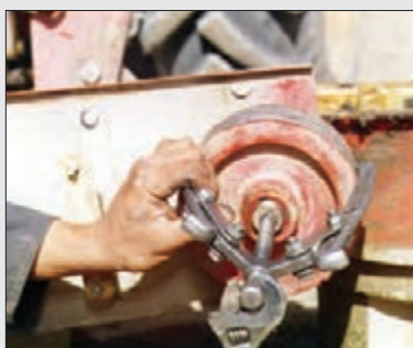
شکل ۱۰- خارج کردن چرخ تسمه
