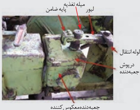
شکل ۹- قطعات بیرونی جعبه‌دنده معکوس کننده
