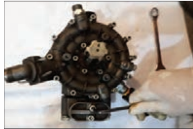
شکل ۴۸- باز کردن درپوش سوپاپ‌ها
