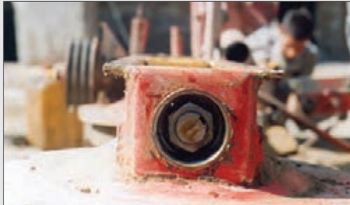
شکل ۲۵- پیچ محور افقی
