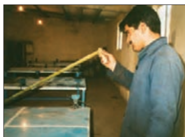
شکل ۱۰- آزمایش کجی محور انگشتی
