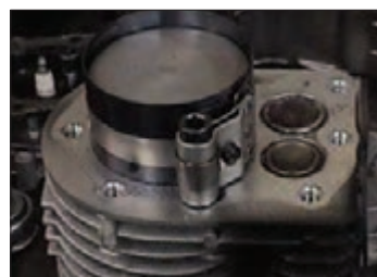
شکل ۳۲- جا زدن پیستون
