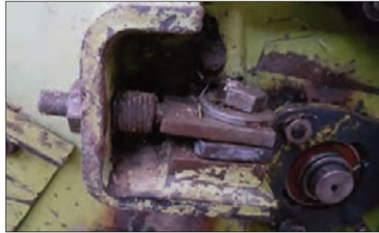
شکل ۴۲- پیچ تنظیم تیغه ثابت
