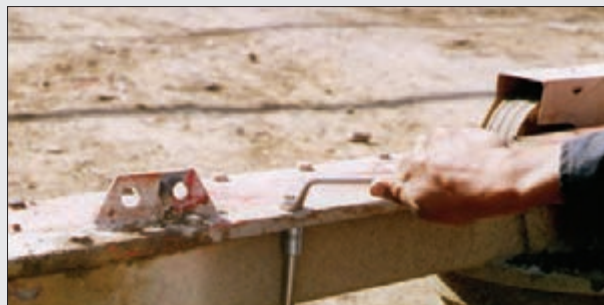
شکل ۲۰- باز کردن پیچ‌های سرپوش جعبه دنده
