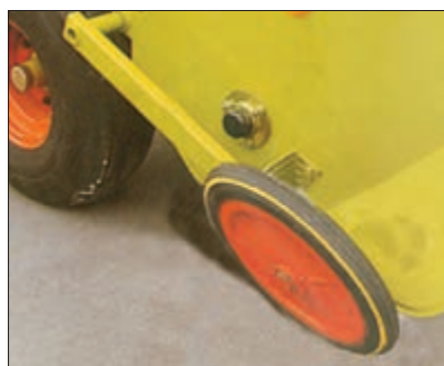
شکل ۲۸- چرخ تنظیم کج شده
