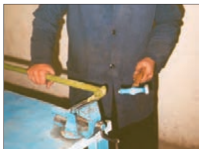
شکل ۱۵- صاف کردن پایه بلبرینگ
