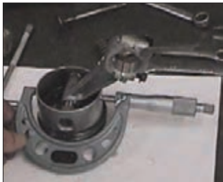
شکل ۳۰- اندازه‌گیری پیستون
