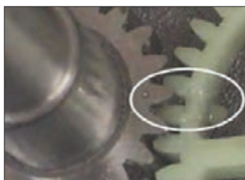
شکل ۳۳- علامت تایم کردن میل بادامک
