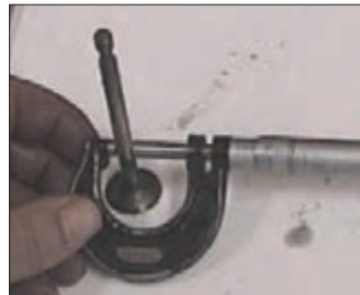
شکل ۲۹- اندازه‌گیری سوپاپ
