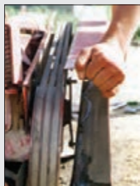
شکل ۸- برداشتن قاب تسمه‌ها
