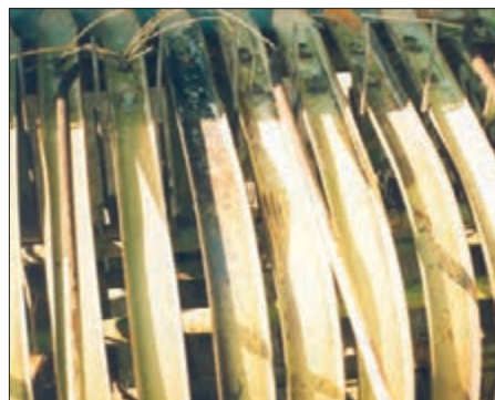
شکل ۶- ساییده شدن انگشتی‌ها به تسمه‌های راهنما
