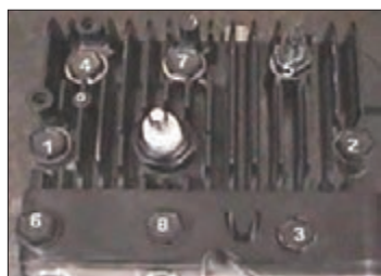
شکل ۳۴- ترتیب بستن پیچ‌های سرسیلندر
