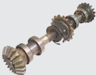
شکل ۳۵- محور افقی و اجزای آن
