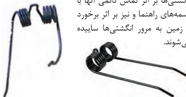
شکل ۴- تفاوت انگشتی سالم و انگشتی معیوب
