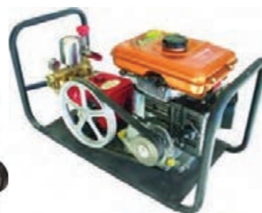
شکل ۱۹- انتقال قدرت در سم‌پاش‌های زنبه‌ای
