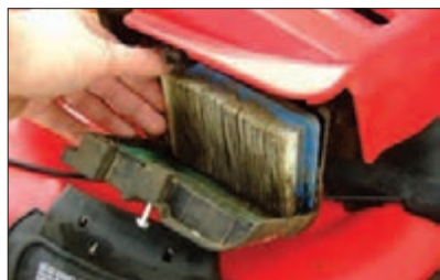
شکل ۱۲- فیلتر هوای کاغذی
