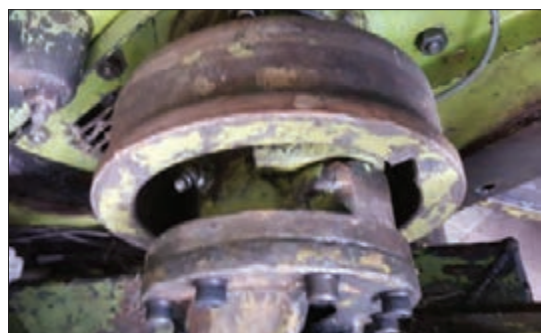
شکل ۴۵- کلاچ سوتکی
