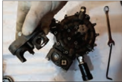
شکل ۴۹- برداشتن درپوش
