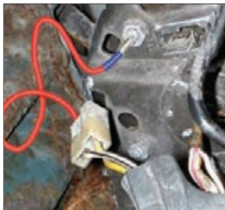
شکل ۲۷- آزمایش مدار لامپ شارژ
