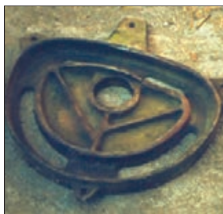
شکل ۱۸- صفحه بادامکی معیوب
