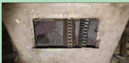
شکل ۲۶- درپوش روغن کاری زنجیر محرک واحد درو
