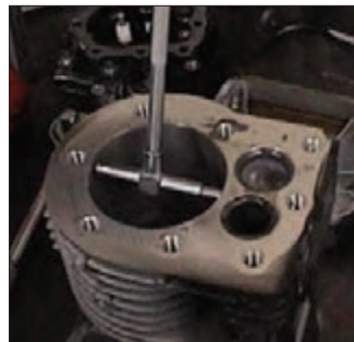
شکل ۲۸- کنترل دو پهنی سیلندر
