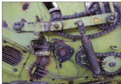
شکل ۳۷- فنر شناوری غلتک‌های بالایی
