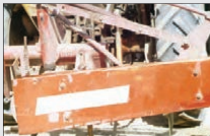
شکل ۷- باز کردن حفاظ تسمه‌ها
