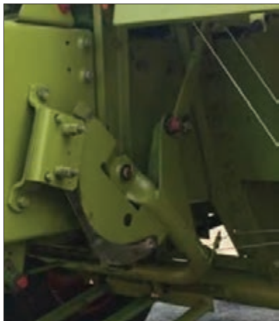
شکل ۶۳- دیسک و ترمز سوزن
