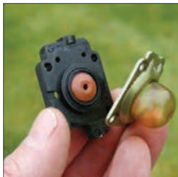
ب) پمپ دستی شکل ۱۶- کاربراتور دیافراگمی
