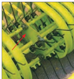
شکل ۱۶- یاتاقان محور انگشتی و محل نصب آن
