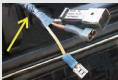
شکل ۲۳- عایق‌بندی اتصالات
