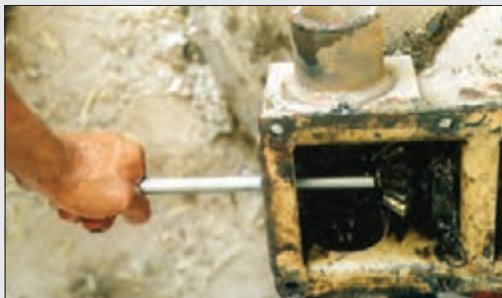
شکل ۲۷- ضربه از طرف درپوش توسط میله
