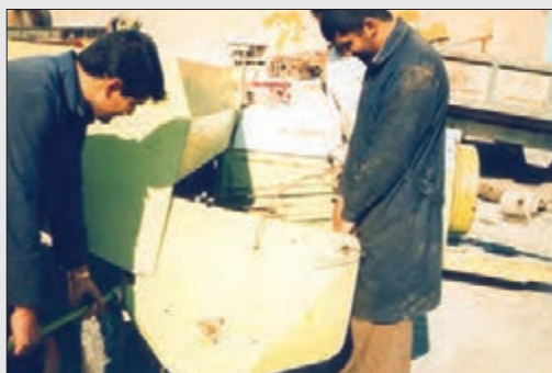
شکل ۳۳- جدا کردن واحد بردارنده
