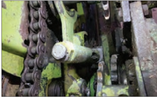
شکل ۴۳- اهرم و پیچ تنظیم تیغه ثابت
