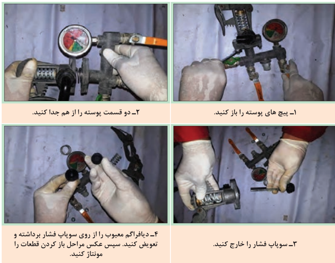
شکل ۵۲- تعویض دیافراگم رگولاتور مدل کمت
