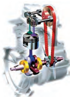
شکل ۳- میل سوپاپ بالای سیلندر
