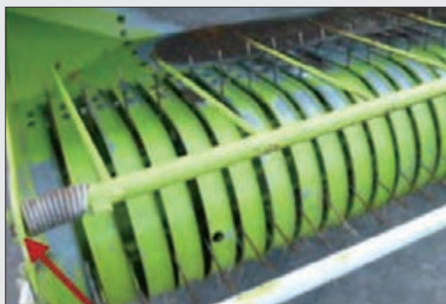
شکل ۳۴- خار میله راهنما (میله فشاردهنده)
