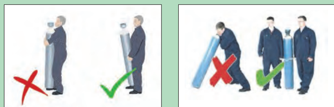
شکل ۱۲- حمل و نقل ایمن کپسول‌ها
