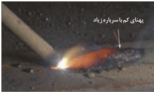
شکل ۳۰- جوشکاری با طول قوس بسیار کم
