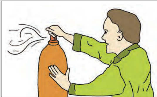
شکل ۱۳- روش تمیز کردن محل اتصال کپسول
