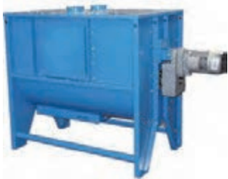
شکل ۸- مخلوط‌کن افقی و مارپیچ‌های آن
