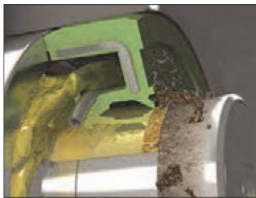
شکل ۶۸- کاسه نمد و نحوه عمل آن
