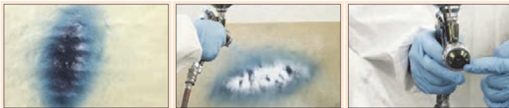
شکل ۶۶- تنظیم جهت پاشش
