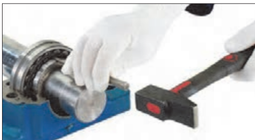
شکل ۶۲- جدا کردن بیرینگ از بوش مخروطی
