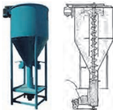
شکل ۷- مخلوط‌کن عمودی و نحوه عملکرد آن
