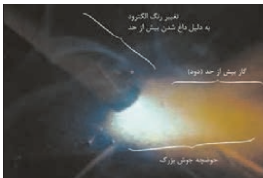
شکل ۲۷- جوشکاری با آمپر بسیار بالا
