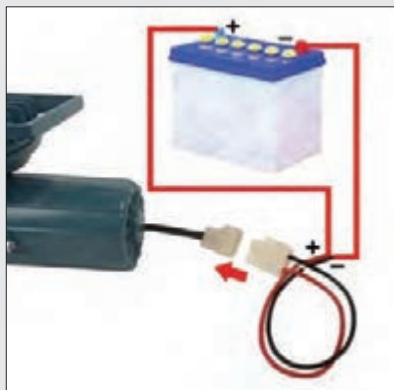
شکل ۴۲- اتصال پمپ با سوکت به باتری
