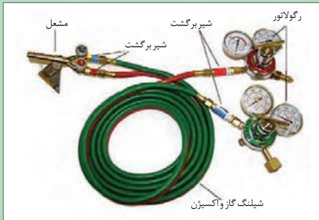
شکل ۱۸- محل نصب سوپاپ‌های یک طرفه (شیر برگشت)
