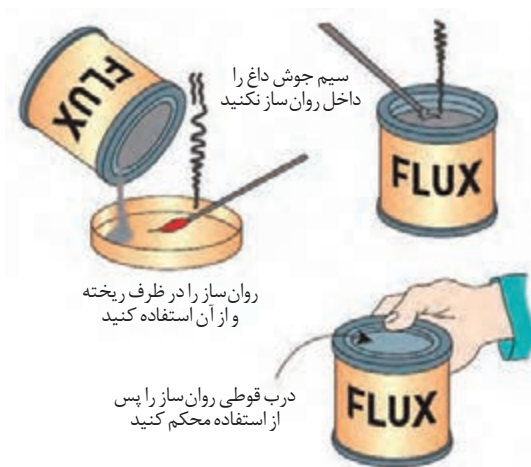
شکل ۲۸- روش استفاده از روان‌ساز
