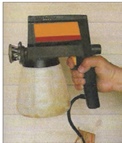
شکل ۶۱- پیستوله بدون کمک هوای فشرده (Airless)
