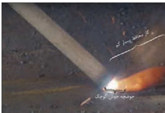
شکل ۲۶- جوشکاری با آمپر بسیار پایین
