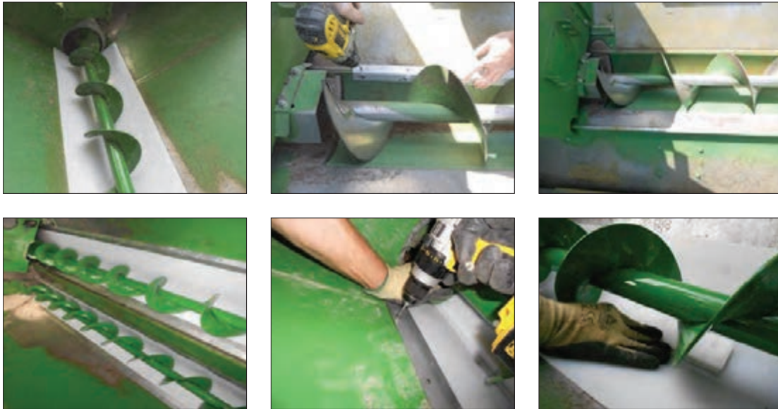
شکل ۳۵- تعمیر محفظه زیرین هلیس مخزن کمباین
