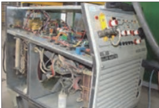
شکل ۱۱- ساختمان داخلی رکتیفایر
