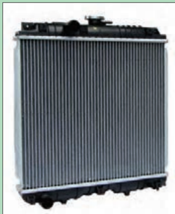
شکل ۳۳- رادیاتور پلی آمید (رادیاتور تراکتور Kioti CK۲۵)
