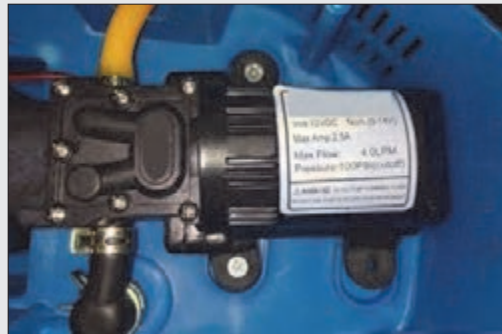
شکل ۳۲- اتصال پمپ و رعایت جهت حرکت سیال
