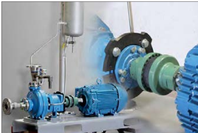
شکل ۸- انتقال قدرت مستقیم از موتور به دستگاه
