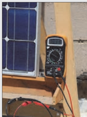
شکل ۲۲- اندازه‌گیری ولتاژ بی‌باری
