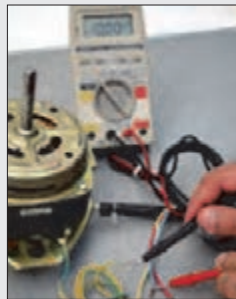
شکل ۷- آزمایش اتصال بدنه
