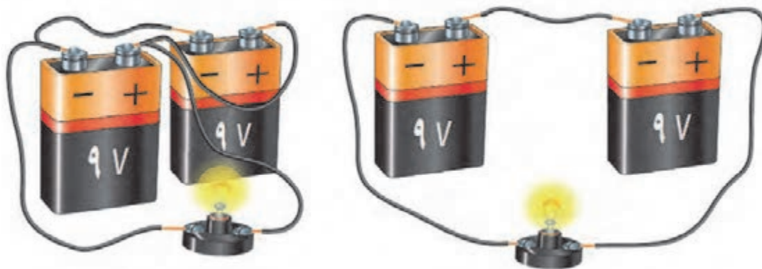
شکل ۱۵- اتصال سری و موازی پیل الکتریکی
