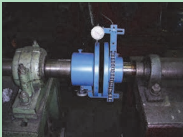
شکل ۷۷- هم‌راستا کردن محورها با ساعت اندازه‌گیری
