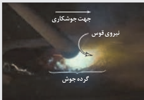
شکل ۳۹- جوشکاری با زاویه پیشران
