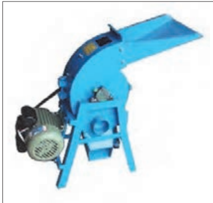
ب) تغییر دور موتور با تسمه در کاه خردکن
