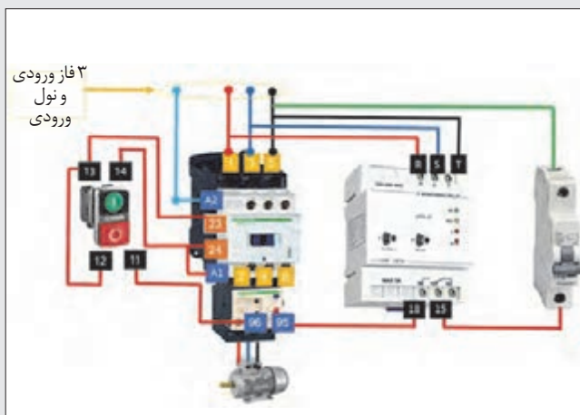
شکل ۳۴- مدار راه اندازی موتور سه فاز با حفاظت کامل و با استفاده از شستی استپ-استارت
