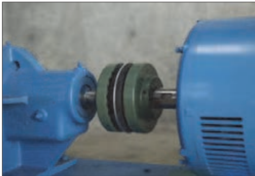
شکل ۷۱- اتصال موتور و دستگاه با کوپلینگ
