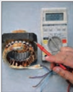
شکل ۷- آزمایش اتصال بدنه
