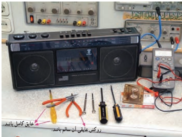
شکل ۱-۴۰- وسایل و ابزار مخصوص تعمیرات الکترونیکی
