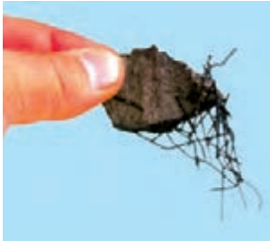
شکل ۱-۱- آهنربای طبیعی براده‌های آهن را جذب می‌کند.
