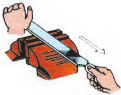
شکل ۲۵-۳ - حرکت به عقب بدون فشار
