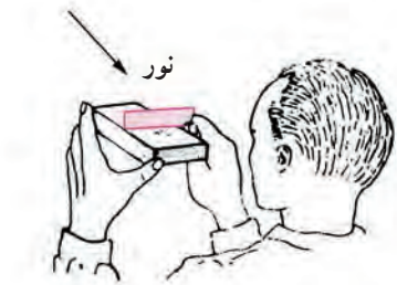
شکل ۱-۲۳- کنترل زاویه قائمه با گونیا
