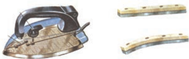
شکل ۳-۳۱ رشته حرارتی اتوی برقی به عنوان مقاومت الکتریکی نقش تولید حرارت و کنترل جریان را به عهده دارد.
