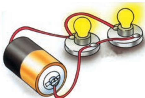
شکل ۵-۶۳ - اتصال دو لامپ به صورت موازی
