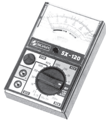
شکل ۹-۱ یک نمونه مولتی متر آنالوگ
