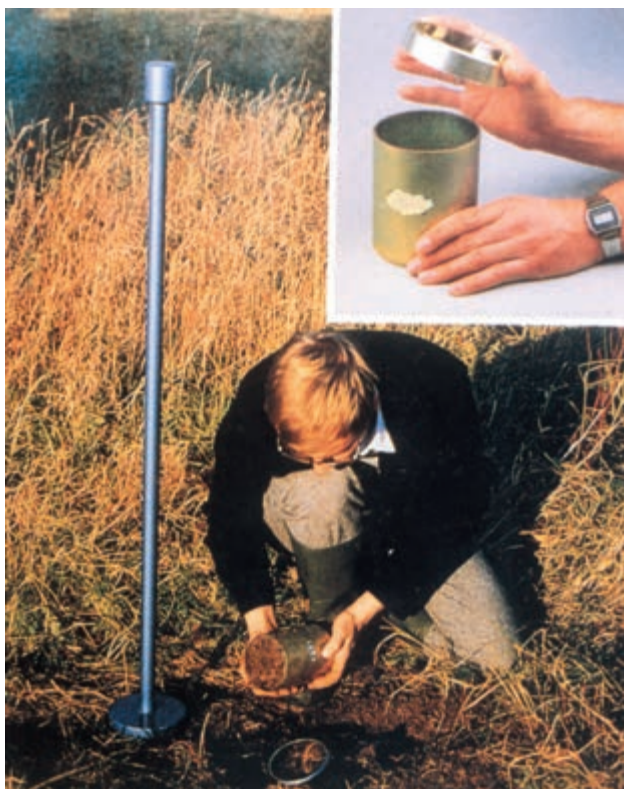
شکل ۱۶- ۱ نمونه برداری از خاک با سیلندر
