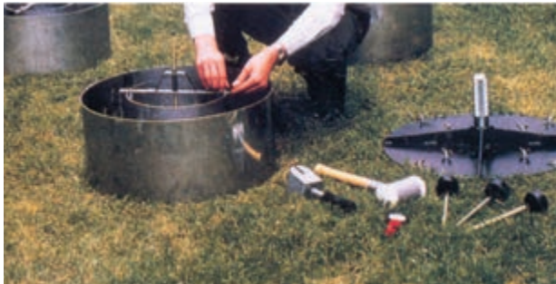
شکل ۳-۱ نحوه کار گذاشتن استوانه مضاعف
