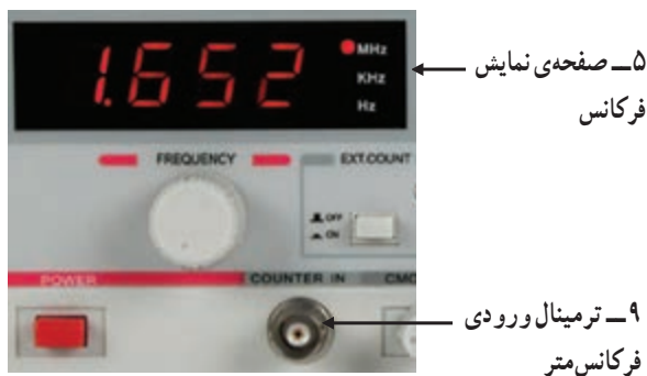
شکل ۱۰۳-۲ فرکانس متر و ترمینال ورودی آن
