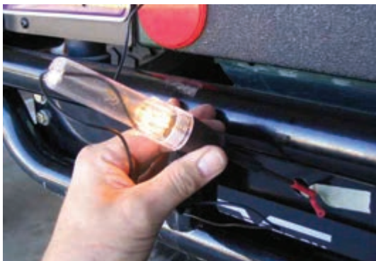
شکل ۸۶-۲ - استفاده از تستر لامپی
