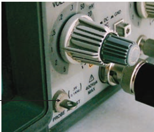
خروجی موج مربعی با فرکانس ۱ KHz و ۵/۰ ولت
