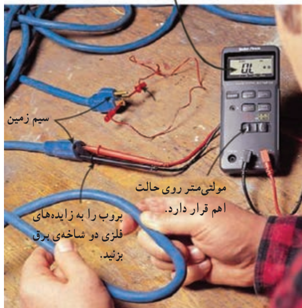
شکل ۲-۸۰ — آزمایش سیم رابط برق دستگاه.
