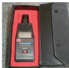
دورسنج دیجیتالی با محرک مکانیکی
