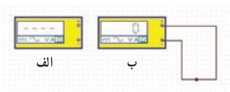
شکل ۲-۷۹ — آزمایش اطمینان از سلامت اهم متر
