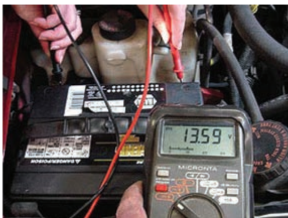
شکل ۱-۵۰ اندازه‌گیری ولتاژ با ولت‌متر دیجیتال
