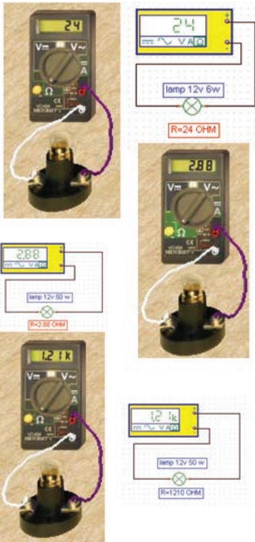
شکل ۸۹-۲ اندازه گیری مقاومت لامپ‌های روشنایی
