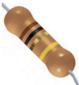
شکل ۲-۷- تصویر ظاهری مقاومت، علامت قراردادی همراه با نام مقاومت و مقدار آن در مدار
