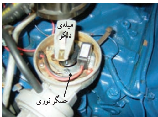
شكل ۲-۱۴۵- سه نمونه حسگر استفاده‌شده در سیستم جرقه‌زنی
