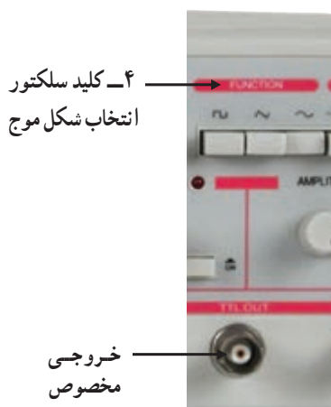
شکل ۲-۱۰۱ کلید سلکتور انتخاب شکل موج
