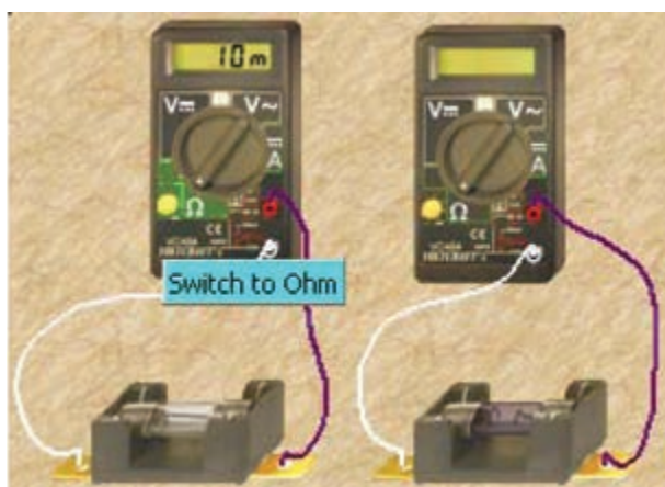
شکل ۸۱-۲ اتصال فیوز به اهم متر
