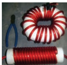
سلف پیچیده شده روی قرقره بدون هسته
