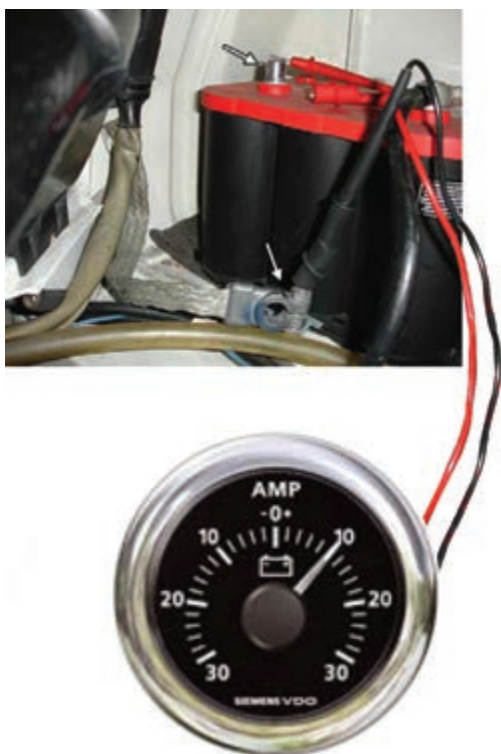
شکل ۱-۵۲ اتصال آمپر متر به صورت سری
