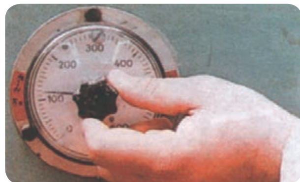
شکل ۷۹-۵ تنظیم فشارسنج پرس
