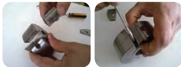
شکل ۲۷-۲- تنظیم و محکم کردن تیغه داخل تویی
