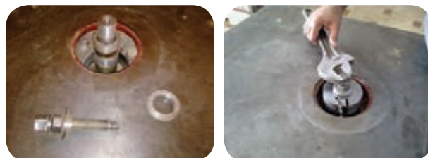
شکل ۲۸-۲- تنظیم کردن تویی در دستگاه فرز
