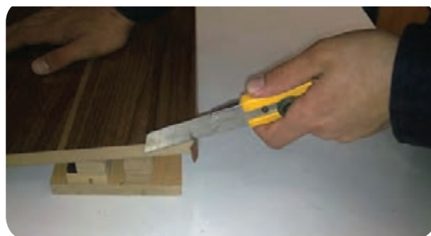
شکل ۴-۲۸ - قطع کردن سرو ته نوار با کاتر
