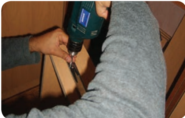
شکل ۱۷۶-۵ نصب ریل تکی به بدنه کشو
