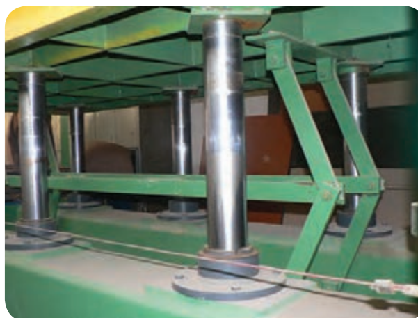
شکل ۸۹-۵- کنترل پیستون و سیلندرهای پرس
