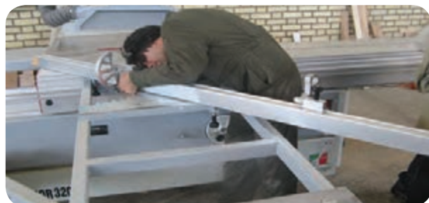
شکل ۵۰-۵- تنظیم دو کفشک کنترل اندازه گیری
