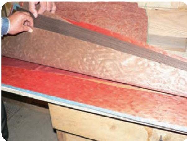
شکل ۷۱-۵- انتخاب روکش طبیعی مناسب
