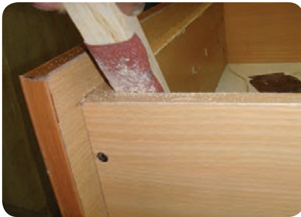
شکل ۵-۱۸۲- برطرف کردن لبه تیز صفحات با سوهان
