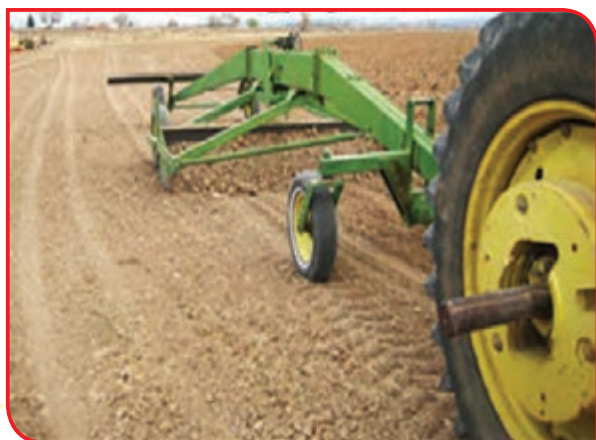
صاف و هموار کردن زمین با ماشین
