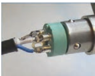
تصویر ۷۶- نقاط اتصال سیستم‌های سیم‌تریک
