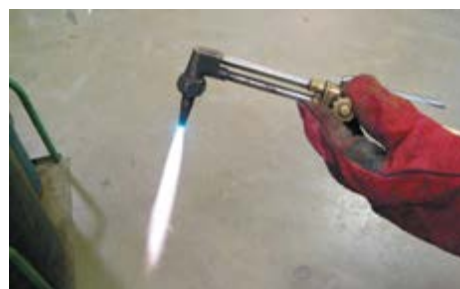
شکل ۱۲- مشعل جوش گاز
