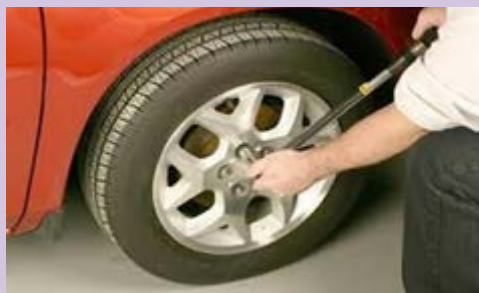
شکل ۵- گشتاور لازم برای سفت کردن چرخ
