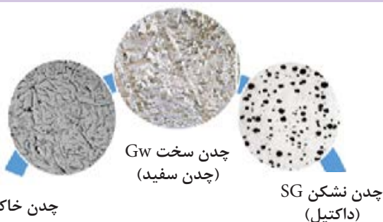
شکل ۱۴- انواع چدن و شکل متالوگرافی آنها
