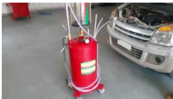
عوض کردن روغن موتور با ساکشن
