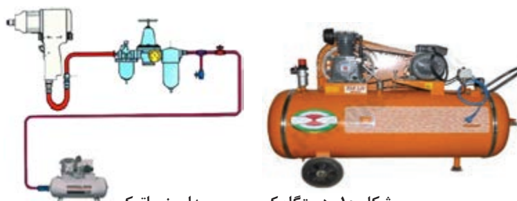
شکل ۱۰- دستگاه کمپرسور و مدار پنوماتیک
