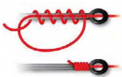
شکل ۲۴- دو نمونه گره برای بستن نخ مونوفیلament به قلاب ماهیگیری
