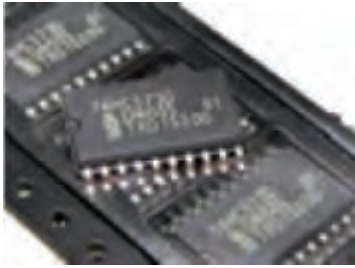
تصویر ظاهری انواع پکیج های SOIC
