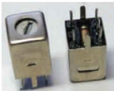
ترانس IF و خازن داخل آن
