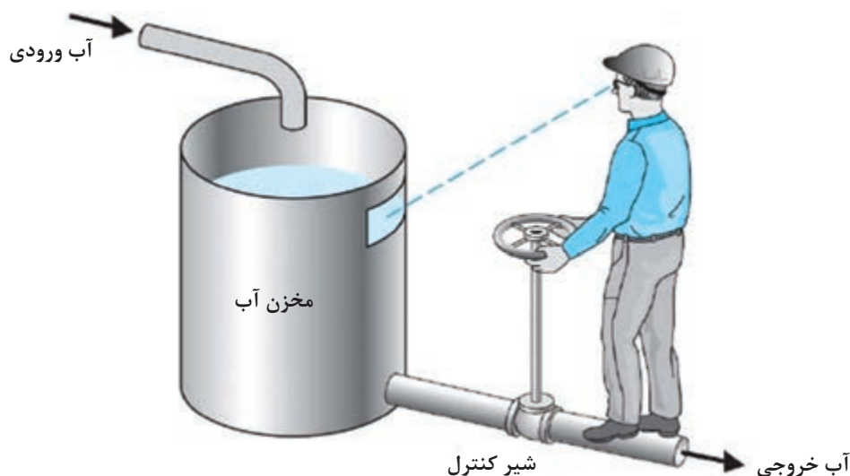
شکل ۵-۱- کنترل دستی ارتفاع آب
