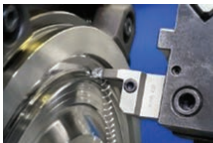
شکل ۶-۴: براده‌برداری به‌وسیله تیغه کاربیدی
