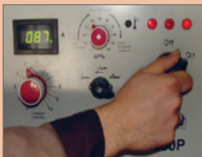
شکل ۴۱- اتصال کابل و روشن کردن دستگاه
