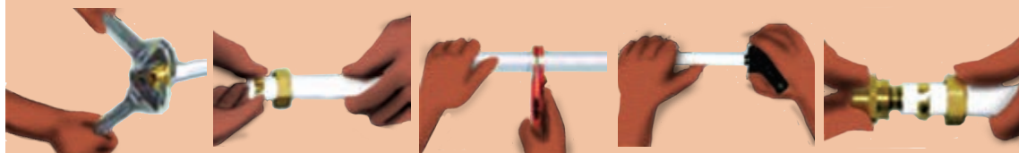
شکل ۴۴- مراحل اتصال لوله پکس
