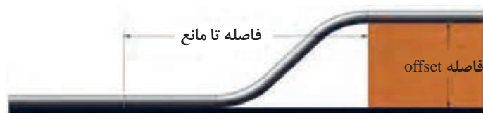
شکل ۳۵- هم‌راستا کردن امتداد لوله
