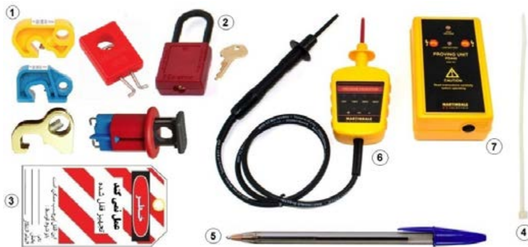
شکل ۵۱- تجهیزات لازم برای جداسازی ایمن
