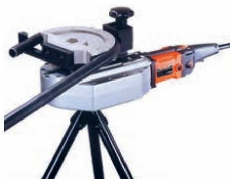
شکل ۱۷- خم کردن لوله
