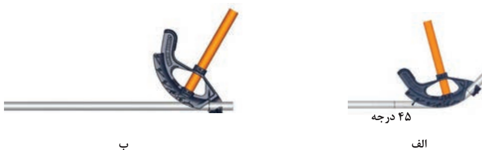
شکل ۳۳- خم انحرافی با لوله خم کن دستی
