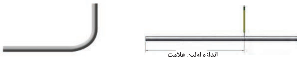
شکل ۳۶- روش تقریبی برای خم کاری
