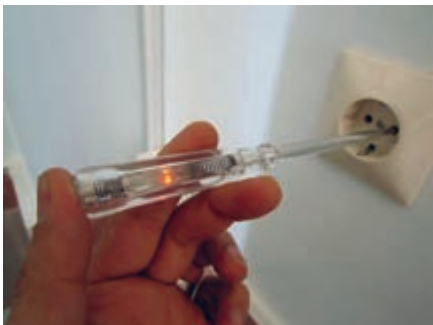
شکل ۴ - کاربرد صحیح فازمتر
