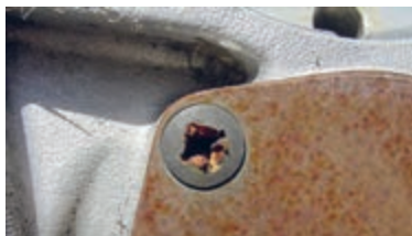
ب) استفاده ناصحیح از آچار پیچ گوشتی
