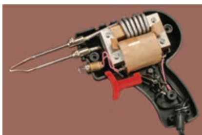
شکل ۵۰- هویه تفنگی (ترانسفورماتوری)
