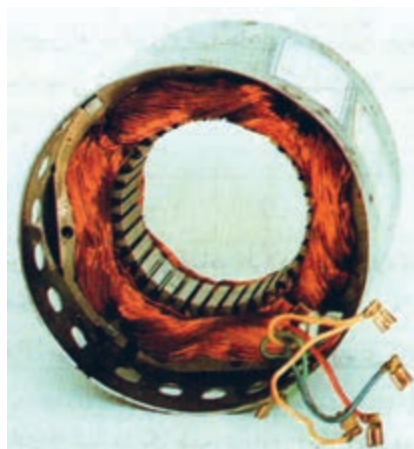
شکل ۷۰- سرسیم‌ها و سیم‌پیچی‌های موتور الکتریکی کولر آبی
