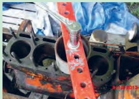
شکل ۹۰. جا زدن بوش با ابزار
