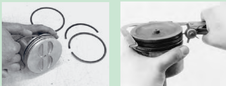
شکل ۵۸. روش های تمیز کردن شیار رینگ پیستون
