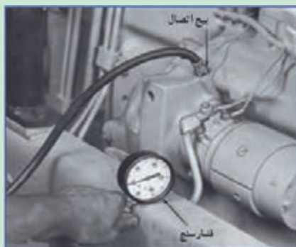
شکل ۵°. فشار سنجی مدار روغن کاری
