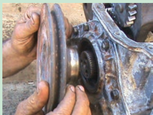
شکل ۱۱۲. جا زدن پولی سر میل لنگ
