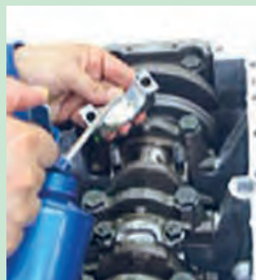
شکل ۱۰۱. روغن کاری کپه یاتاقان شاتون
