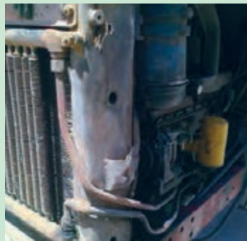
شکل ۱۳. رادیاتور روغن تراکتور U650
