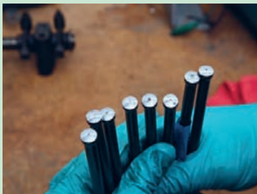
شکل ۴۷. خارج کردن میل تپت‌ها
