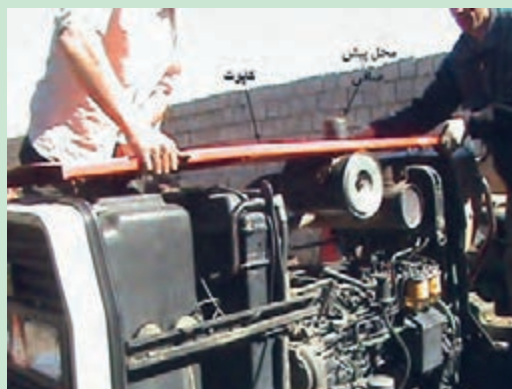
شکل ۴۰. برداشتن کاپوت تراکتور MF۳۹۹
