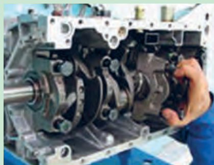
شکل ۴۸. برداشتن کپه های یاتاقان و چیدن آنها
