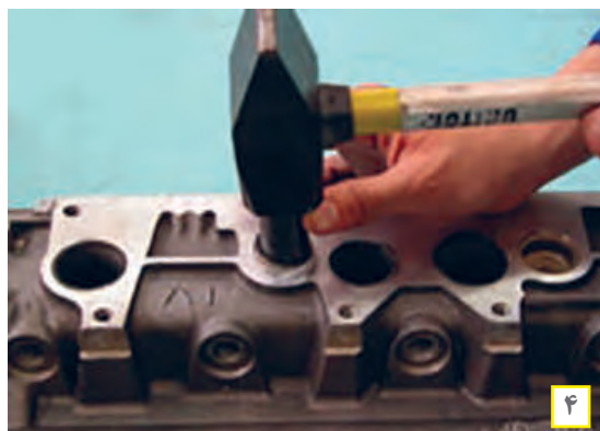
شکل ۶۹. روش تعویض پولک سر سیلندر
