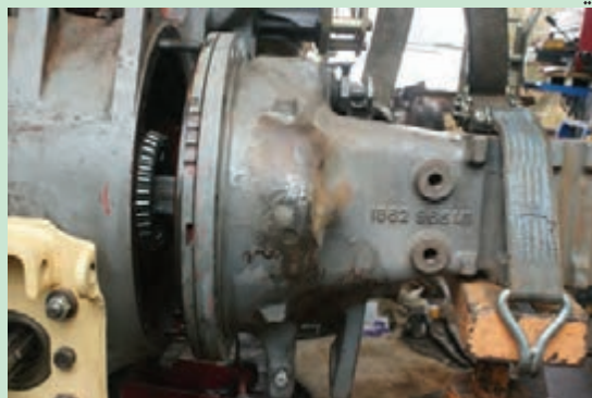
شکل ۷. باز کردن پوسته قیفی تراکتور MF285
