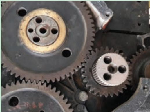
شکل ۱۰۹. علامت‌های تایمینگ روی چرخ دنده‌ها
