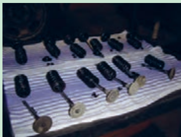
شکل ۵۹. چیدن اجزای سوپاپ به ترتیب باز شدن
