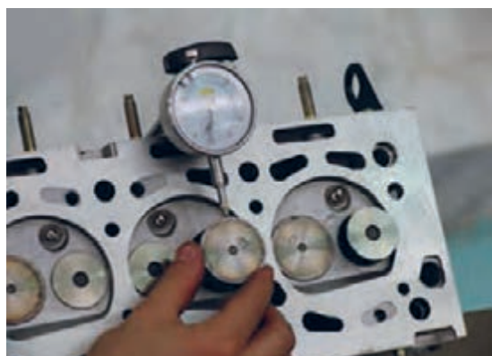
شکل ۷۳. روش کنترل لقی بین سوپاپ و گیت
