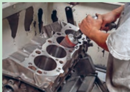
شکل ۳۹. ترمیم لبه بالای سیلندر
