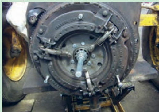
شکل ۳۷. سوار کردن مجموعه کلاچ روی فلاپیول
