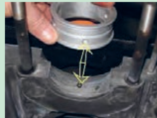
شکل ۹۳. قرار گرفتن سوراخ روغن مقابل هم
