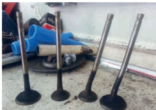
شکل ۶۷. کربن گرفتگی سرسیلندر و سوپاپ‌ها
