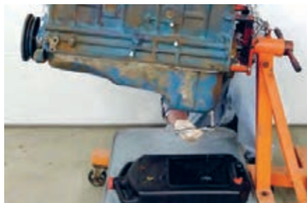
شکل ۳۳. موتور نصب شده روی استند
