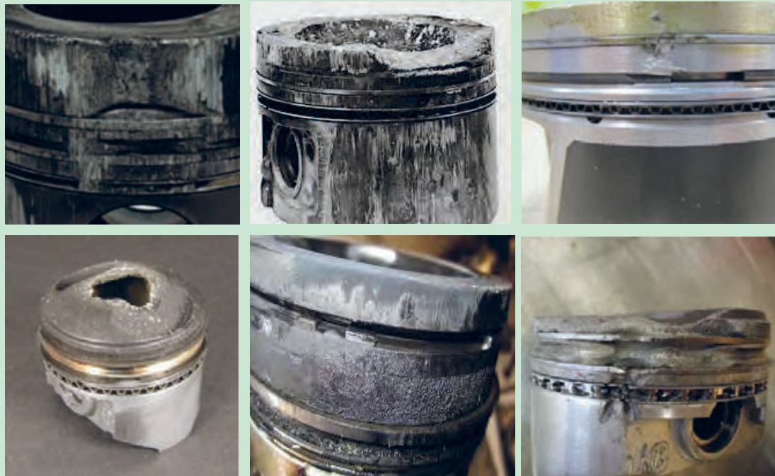
شکل ۷۴. نمونه ای از پیستون های معیوب
