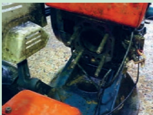
شکل ۵۶. برداشتن سر سیلندر
