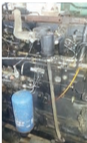
شکل ۳۹. تهویه محفظه کارتر در تراکتور MF399
