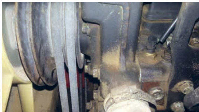
شکل ۱۰. محل فشنگی آب روی تراکتور MF۳۹۹
