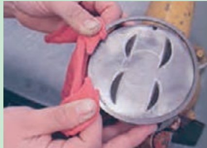
شکل ۵۳. خارج کردن رینگ بدون رینگ بازکن
