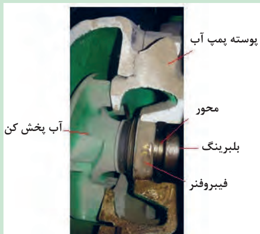
شکل ۱۶. مهره پایه پروانه و نمای برش خورده پمپ آب تراکتور MF۲۸۵
