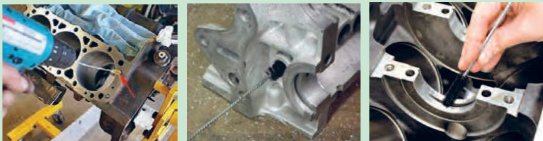
شکل ۵۹. تمیز کردن مجاری آب و روغن
