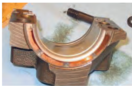
شکل ۷۳. نمونه بغل یاتاقانی معیوب
