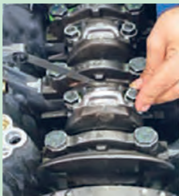
شکل ۱۰۲. کنترل لقی شاتون روی محور میل لنگ
