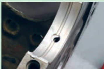
شکل ۹۳. قرار گرفتن سوراخ روغن مقابل هم
