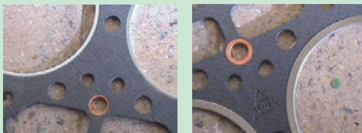
شکل ۸۷. تفاوت ضخامت قسمت‌های مسی روی واشر سرسیلندر
