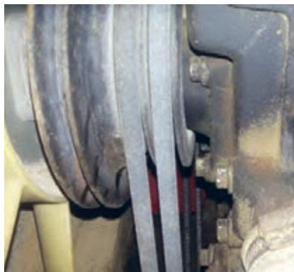
شکل ۷. استفاده از دو تسمه در تراکتور MF۳۹۹
