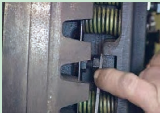
شکل ۳۹. تنظیم کلاچ محور تواندهی
