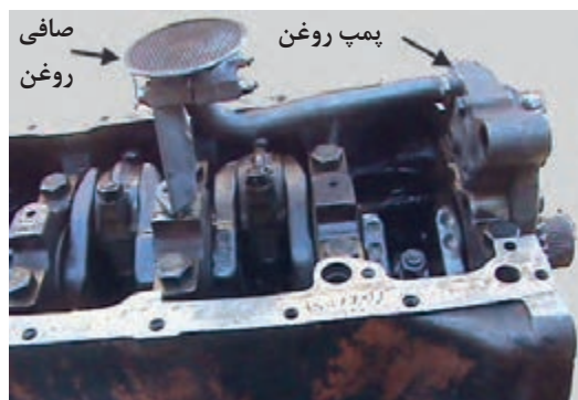
شکل ۴۱. پمپ روغن موتور و صافی آن
