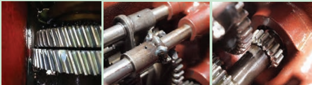
شکل ۴۰. برخی ایرادات قطعات جعبه دنده
