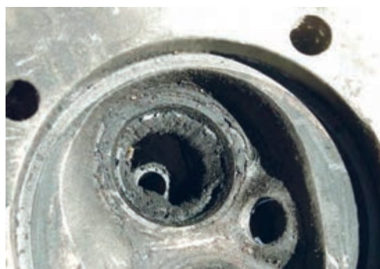
شکل ۶۷. کربن گرفتگی سرسیلندر و سوپاپ‌ها
