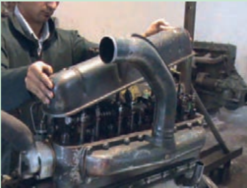
شکل ۴۴. برداشتن درپوش سوپاپ‌های تراکتور U650
