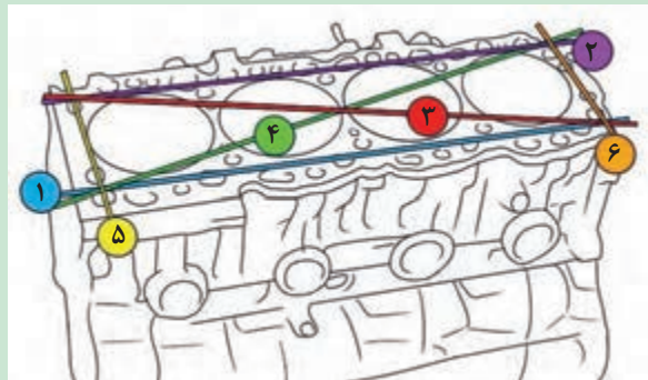
شکل ۶۸. تعیین میزان تاب برداشتن سطح بلوکه سیلندر با خط کش و فیلمر
