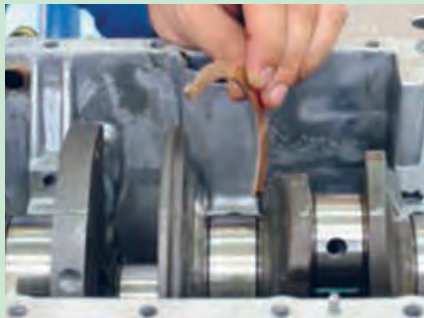
شکل ۵۰. برداشتن یاتاقان های ثابت و بغل یاتاقانی
