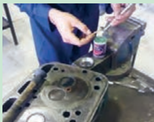
شکل ۷۸. زدن روغن سنباده به سوپاپها
