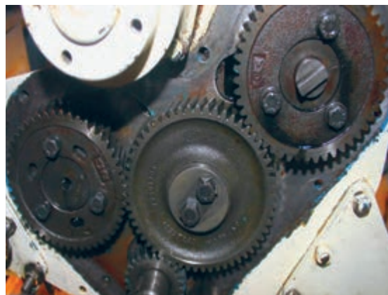
شکل ۲۷. چرخ دنده‌های تایمینگ در سینی جلو موتور
