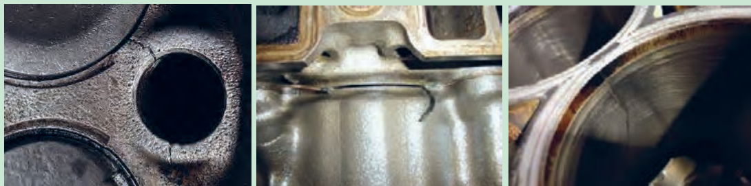
شکل ۶۲. ترک در سیلندر و بلوکه سیلندر
