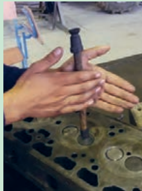
شکل ۷۹. چرخاندن سوپاپ به وسیله چوب سوپاپ گردان
