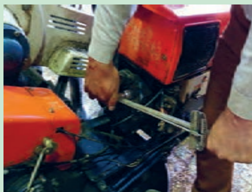
شکل ۵۵. باز کردن سر سیلندر
