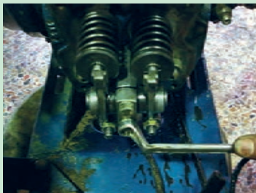
شکل ۵۴. باز کردن مجموعه اسبک‌ها
