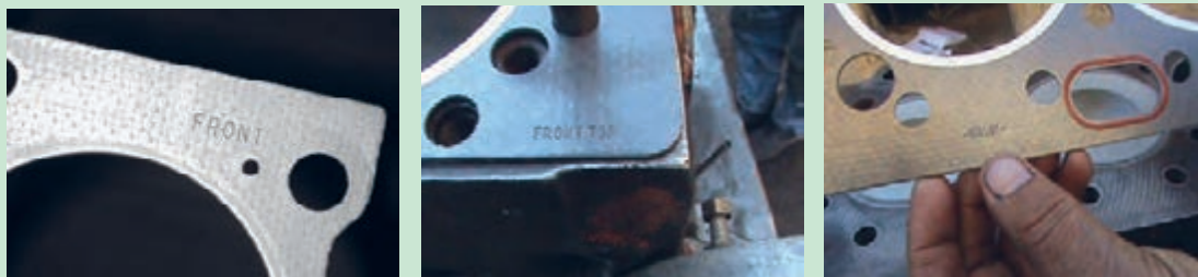
شکل ۸۶. علامت‌های روی واشر سرسیلندر
