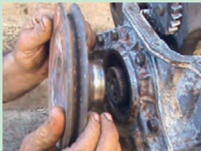
شکل ۳۵. پیاده کردن پولی میل لنگ
