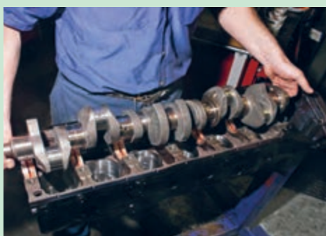
شکل ۴۹. برداشتن میل لنگ
