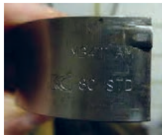
شکل ۲۳. تغییر ضخامت یاتاقان در سایزهای مختلف
