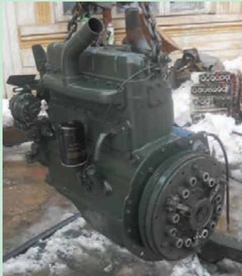
شکل ۲۴. پیاده کردن موتور تراکتور U650
