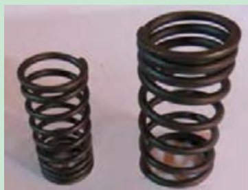
شکل ۱۸. فنرهای سوپاپ در تراکتور MF۲۸۵
