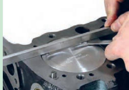
شکل ۱۰۳. کنترل سطح پیستون نسبت به سطح بلوکه سیلندر با فیلر و ساعت اندازه گیری
