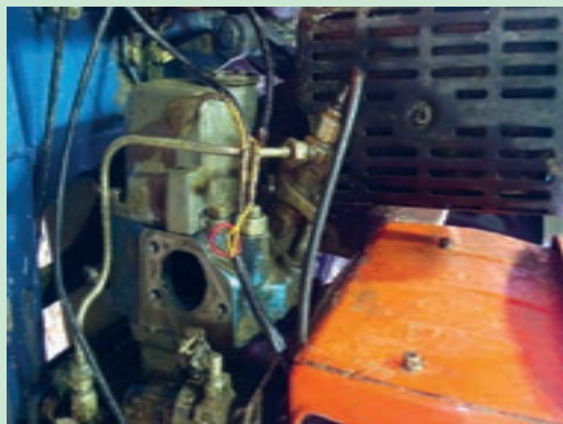
شکل ۵۲. باز کردن مانیفولد هوا
