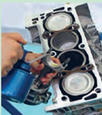
شکل ۱۰۱. روغن کاری کپه یاتاقان شاتون
