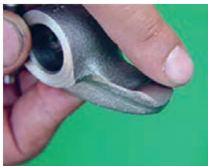
شکل ۷۵. فرسودگی سر اسبک
