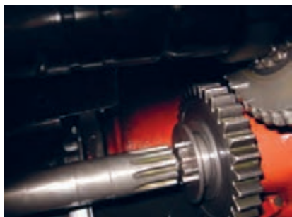
شکل ۲۰. محور تواندهی در حالت خلاص
