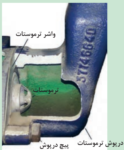
شکل ۱۷. نمای برش خورده ترموستات تراکتور MF۲۸۵
