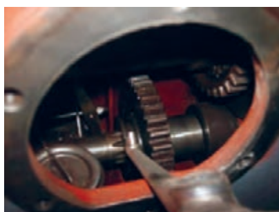
شکل ۲۱. محور تواندهی در حالت موتور گرد
