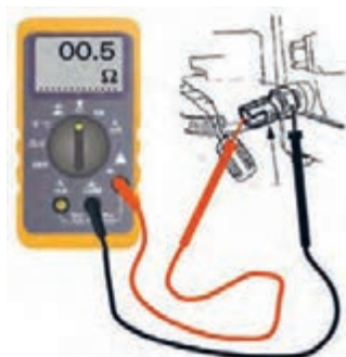
شکل ۴۹. کنترل فشنگی روغن
