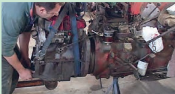
شکل ۳۲. جدا کردن موتور از جعبه دنده
