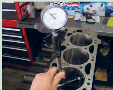
شکل ۷۶. اندازه‌گیری قطر سیلندر با میکرومتر داخلی
