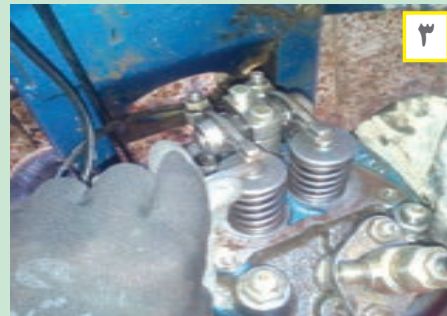
شکل ۳۷. فیلرگیری موتور تراکتور دوچرخ
