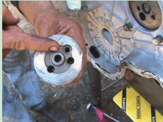
شکل ۱۰۸. واسط سر میل سوپاپ
