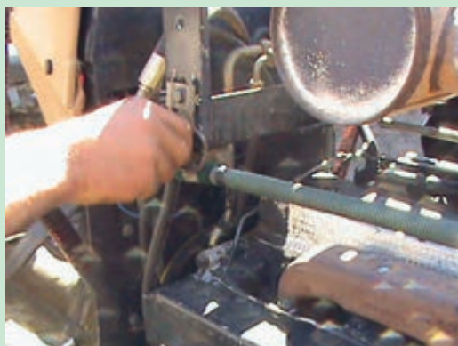
شکل ۴۱- باز کردن انباره اگزوز تراکتور MF۳۹۹
