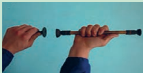
شکل ۷۷. اتصال سوپاپ به چوب سوپاپ گردان
