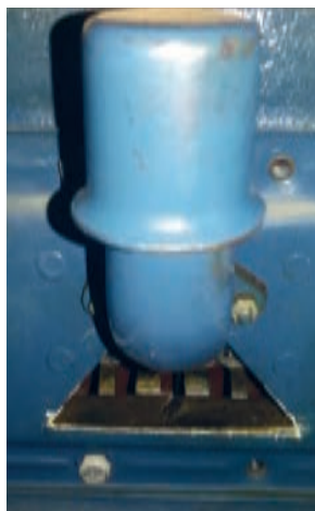
۴۰. تهویه محفظه کارتر در تراکتور U650
