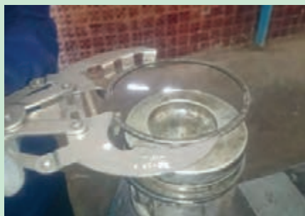
شکل ۵۲. نحوه خارج کردن رینگ از روی پیستون
