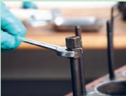
شکل ۵۱. باز کردن پیچ های دوسر دنده به وسیله دو عدد مهره
