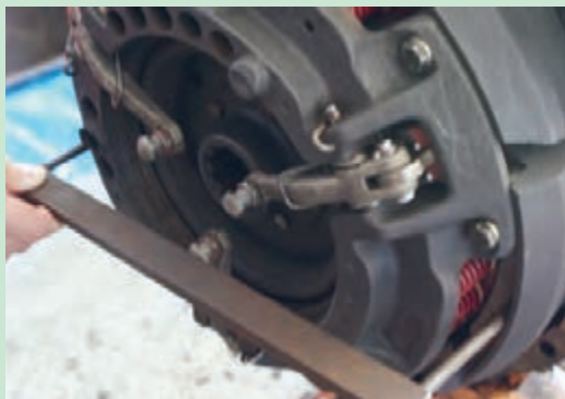
شکل ۳۸. تنظیم انگشتی‌های کلاچ
