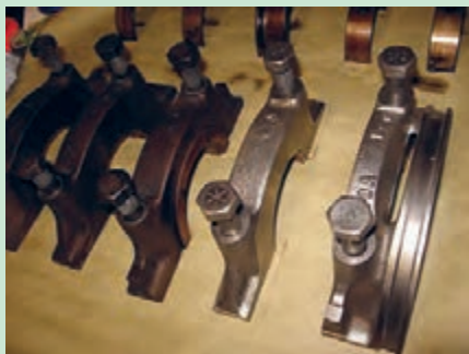
شکل ۴۸. برداشتن کپه های یاتاقان و چیدن آنها
