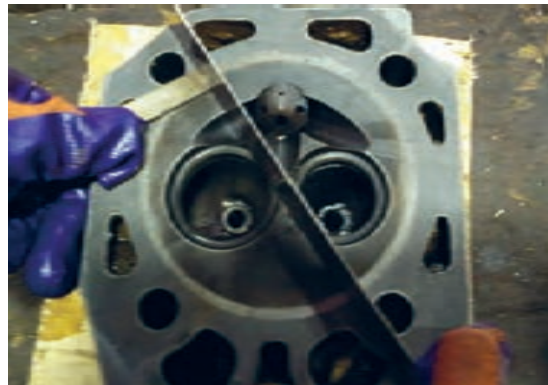
شکل ۶۵. کنترل تابیدگی سرسیلندر تراکتور دوچرخ
