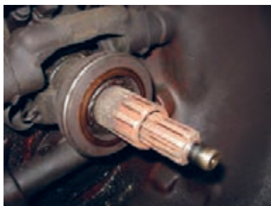
شکل ۱۹. موقعیت محور ورودی جعبه دنده و محور تواندهی
