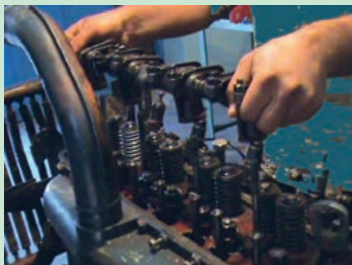
شکل ۴۶. برداشتن مجموعه اسبک از روی سرسیلندر
