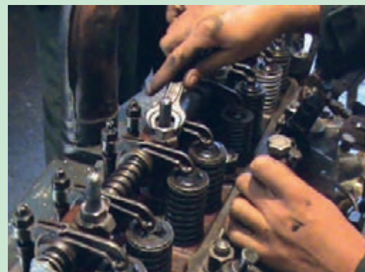
شکل ۴۵. باز کردن پیچ‌های پایه اسبک
