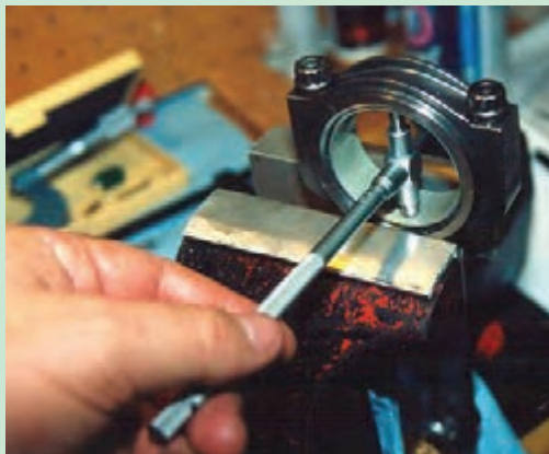
شکل ۸۳. کنترل بیضی شدن سر بزرگ شاتون
