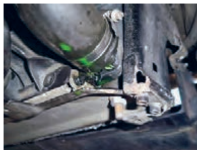
شکل ۵. نشتی از محل اتصالات
