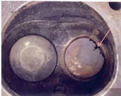
شکل ۷۰. عیوب ظاهری سوپاپ‌ها
