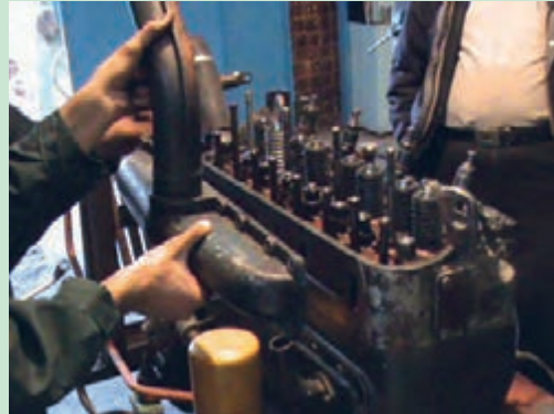
شکل ۴۳. باز کردن مانیفولد تراکتور U650
