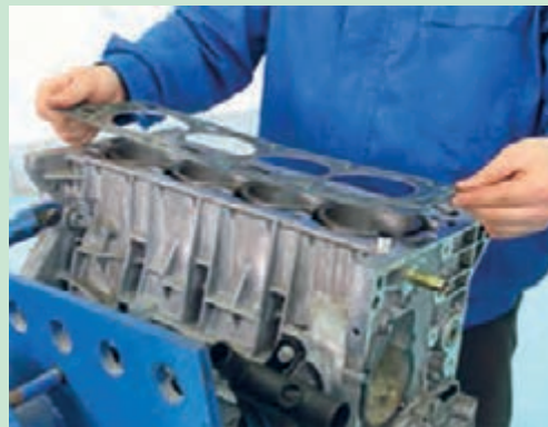
شکل ۵۰. برداشتن و اثر سر سیلندر
