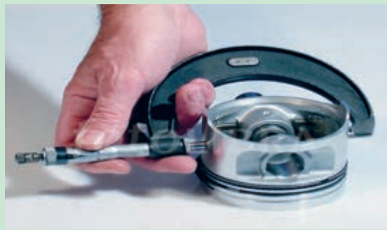
شکل ۷۵. اندازه‌گیری قطر پیستون با میکرو متر
