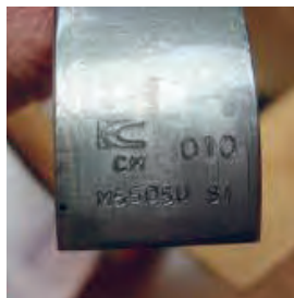
شکل ۲۳. تغییر ضخامت یاتاقان در سایزهای مختلف
