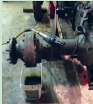
شکل ۳۲. کاهنده نهایی بعد از باز کردن چرخ
