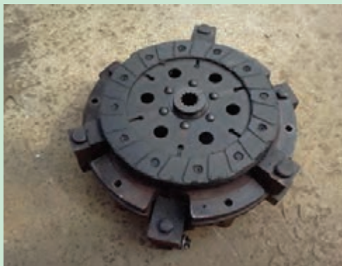
شکل ۲۵. جدا کردن مجموعه کلاچ از فلاپویل
