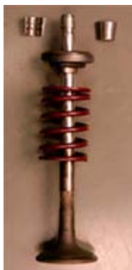
شکل ۱۷. فنر، کلاهیک و خار سوپاپ
