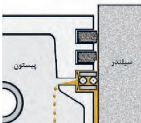
شکل ۱۲. بازگرداندن روغن اضافه توسط رینگ روغن
