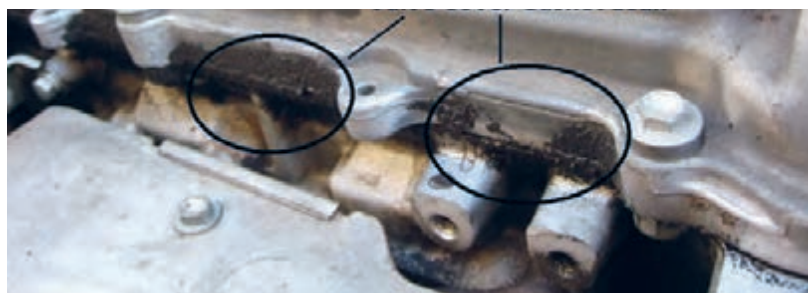
شکل ۲۷. نشستی روغن از درپوش سوپاپ‌ها
