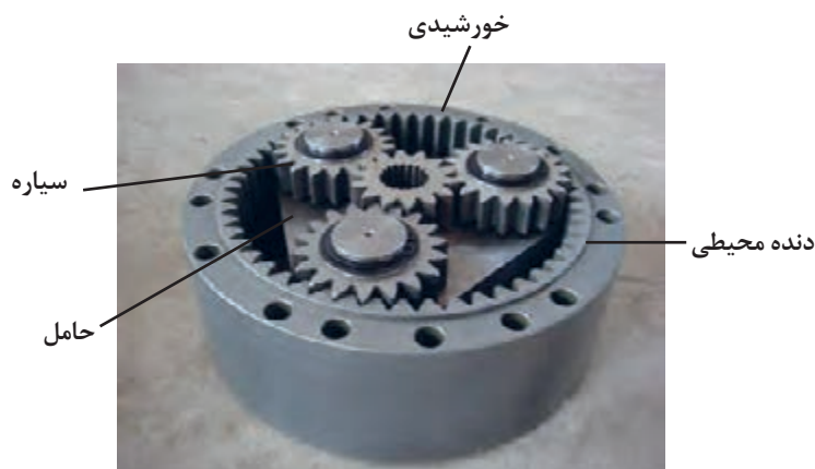
شکل ۱۱. جعبه دنده سیاره‌ای
