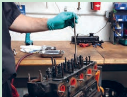
شکل ۴۷. خارج کردن میل تپت‌ها
