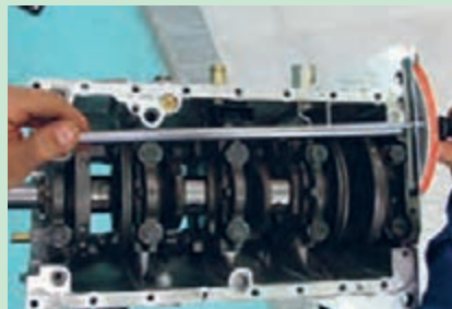
شکل ۴۶. باز کردن پیچ های یاتاقان
