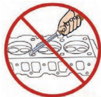
شکل ۶۳. برای تمیز کردن سر سیلندر از اجسام تیز و برنده استفاده نکنید.
