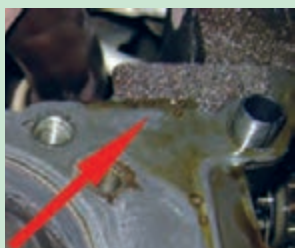
شکل ۶۷. پین روی بلوکه سیلندر
