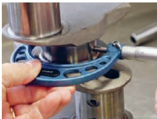
شکل ۷۱. اندازه‌گیری قطر میل‌لنگ
