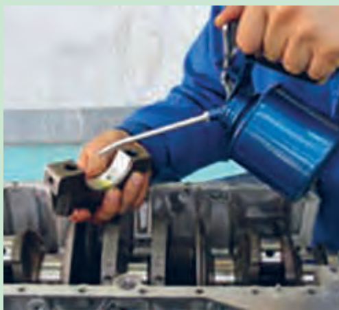
شکل ۹۵. روغنکاری یاتاقان ها قبل از نصب
