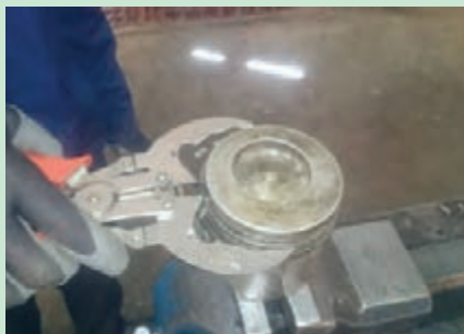
شکل ۵۲. نحوه خارج کردن رینگ از روی پیستون
