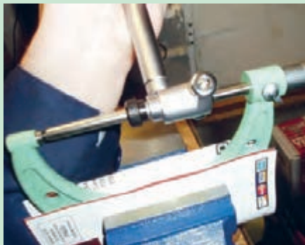
شکل ۷۶. اندازه‌گیری قطر سیلندر با میکرومتر داخلی
