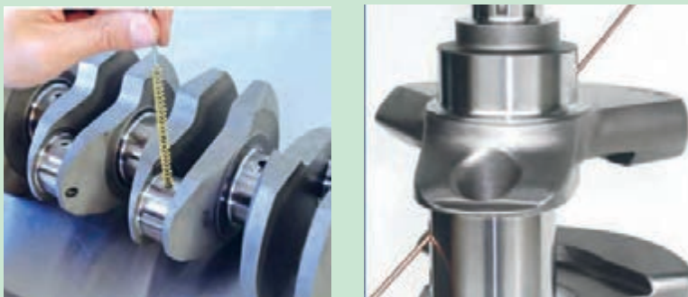
شکل ۶۰. تمیز کردن مجاری میل لنگ
