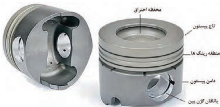
شکل ۶. پیستون و قسمت‌های مختلف آن
