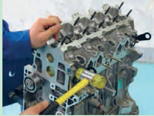
شکل ۴۹. آزاد کردن چسبیدگی سر سیلندر
