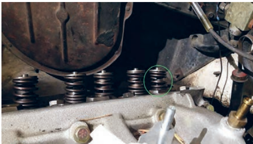
شکل ۷۱. شکستن فنر سوپاپ
