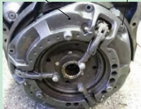
شکل ۲۵. جدا کردن مجموعه کلاچ از فلاپویل
