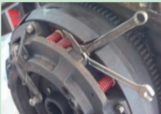
شکل ۳۹. تنظیم کلاچ محور تواندهی
