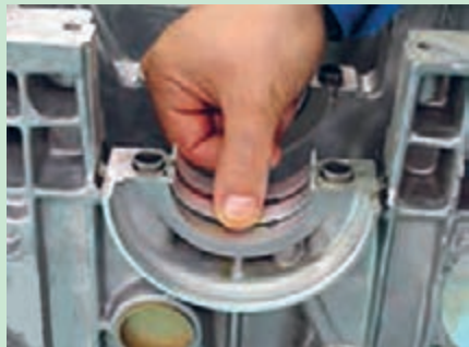
شکل ۵۰. برداشتن یاتاقان های ثابت و بغل یاتاقانی
