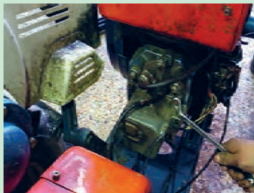
شکل ۵۳. باز کردن درپوش سوپاپ‌ها
