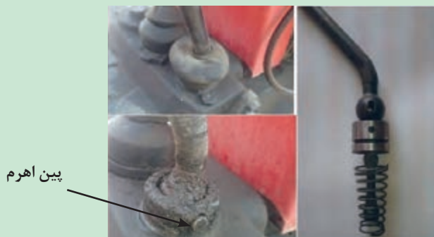
شکل ۲۹. خارج کردن اهرم‌های تعویض دنده
