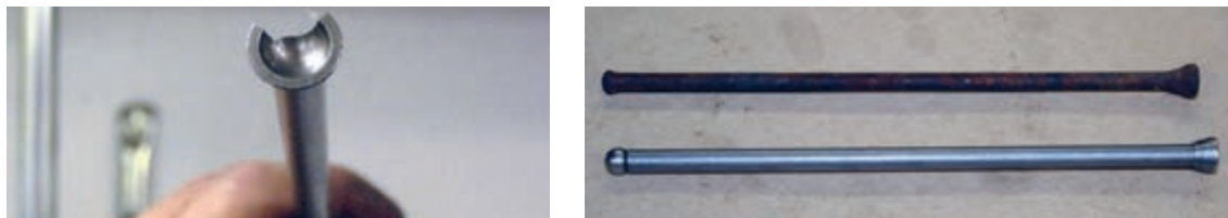
شکل ۷۶. زنگ زدن و شکستگی میل تپت
