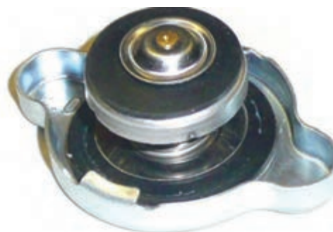
شکل ۱۲. درب رادیاتور و سوپاپ های آن
