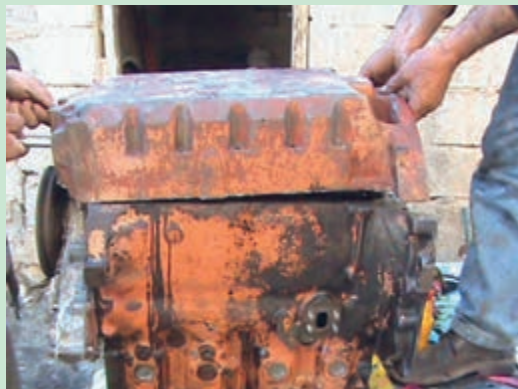
شکل ۱۱۵. نصب کارتر روی بلوکه سیلندر
