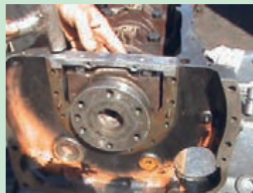
شکل ۹۷. جا زدن قطعه آب بندی کارتر
