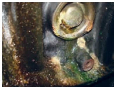
شکل ۷. نشتی از پولکی های موتور
