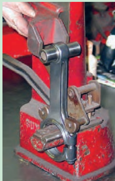
شکل ۸۲. پیچیدگی شاتون، اندازه گیری و اصلاح آن
