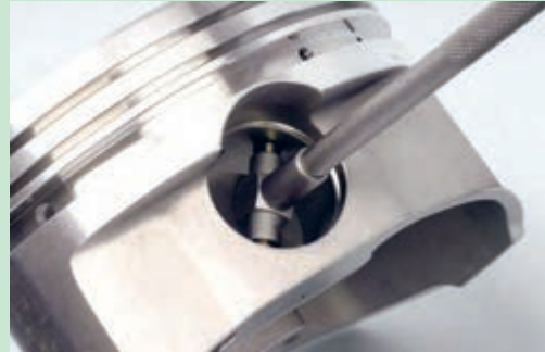
شکل ۸۱. اندازه گیری لقی گزن بین در پیستون
