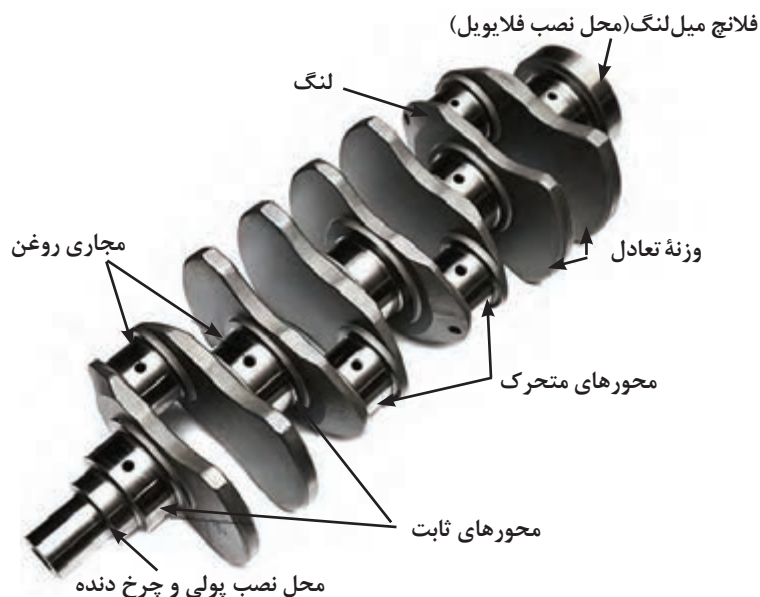
شکل ۱۶. اجزاء میل لنگ
