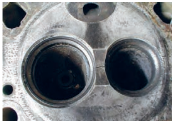
شکل ۶۶. ترک خوردگی سرسیلندر در محفظه احتراق
