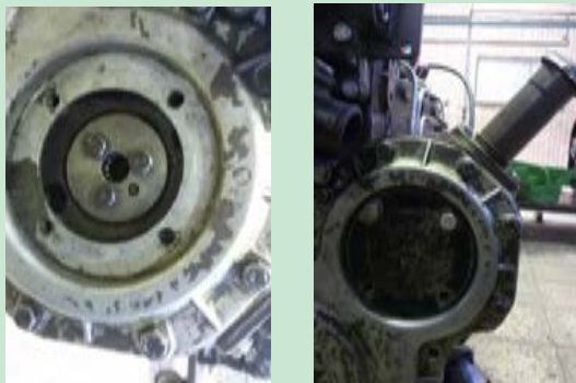
شکل ۳۲. پیچ های درپوش زمان بندی و چرخنده پمپ انژکتور تراکتور MF285
