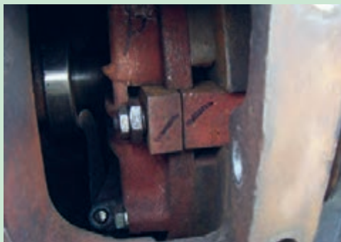
شکل ۲۶. علامتگذاری قطعات مجموعه کلاچ
