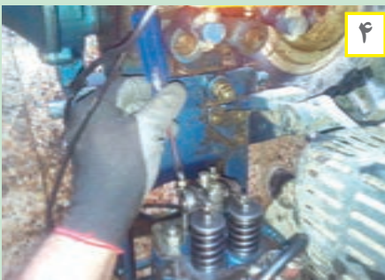
شکل ۳۷. فیلرگیری موتور تراکتور دوچرخ
