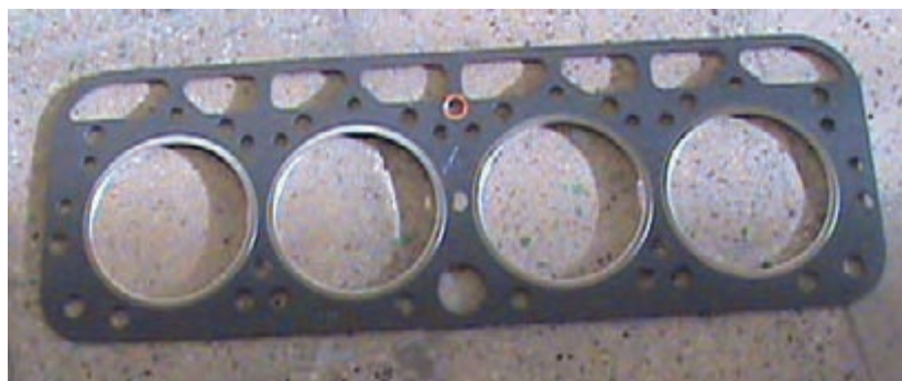
شکل ۱۳- واشر سر سیلندر تراکتور رومانی (U650)
