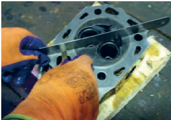
شکل ۶۵. کنترل تابیدگی سرسیلندر تراکتور دوچرخ
