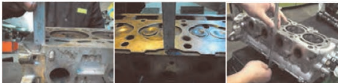
شکل ۸۳. کنترل ارتفاع مجاز کف تراشی سر سیلندر
