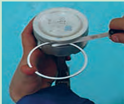
شکل ۷۸. اندازه گیری خلاصی رینگ‌ها در شیار پیستون با فیلر
