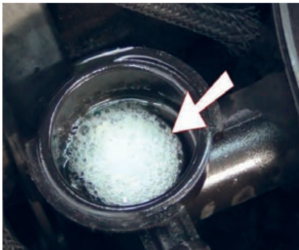
شکل ۳۳. خروج حباب از رادیاتور
