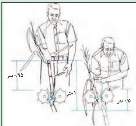
شکل ۲۷-۱- سعی در رفع گیر کردن ماشینی که در حال کار است یک مخاطره شدید محسوب می شود
