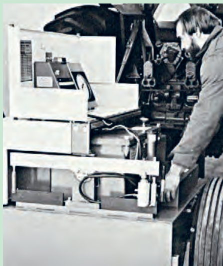
شکل ۳۶- اندازه‌گیری توان یک تراکتور با دینامومتر
