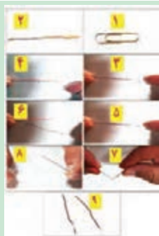
شکل ۴-۱۳- آزمایش بارگذاری روی یک مفتول گیره کاغذ
