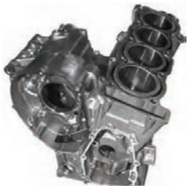
شکل ۲۰-۵- بدنه موتور (چدن خاکستری)
