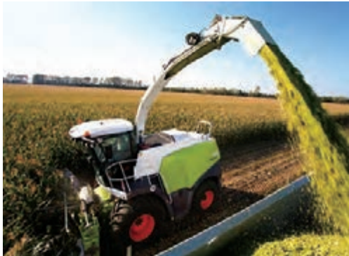
شکل ۲-۳- در ماشین های برداشت جرم ماده برداشت شده معیار محاسبه ظرفیت ماشین است.
