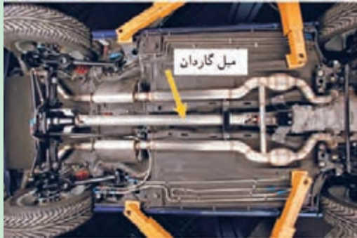
شکل ۴-۳۶- میل‌گاردان بارگذاری پیچشی را برای انتقال گشتاور تحمل می‌نماید.
