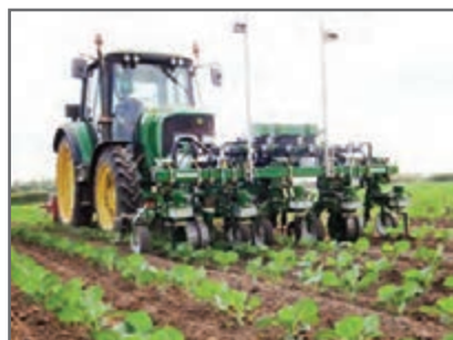
ماشین تمام خودکار هوشمند، عمل تنک مکانیزه را بسیار دقیق انجام می‌دهند.
