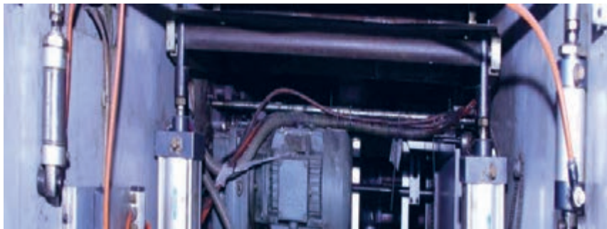
شکل ۳۸- جک های هیدرولیک سیلندر ضربه زننده
