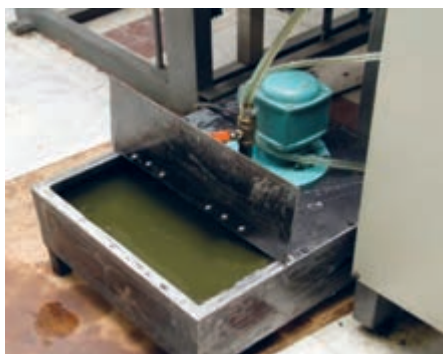
شکل ۲۰- مخزن ورنی و سیستم ورنی‌زنی
