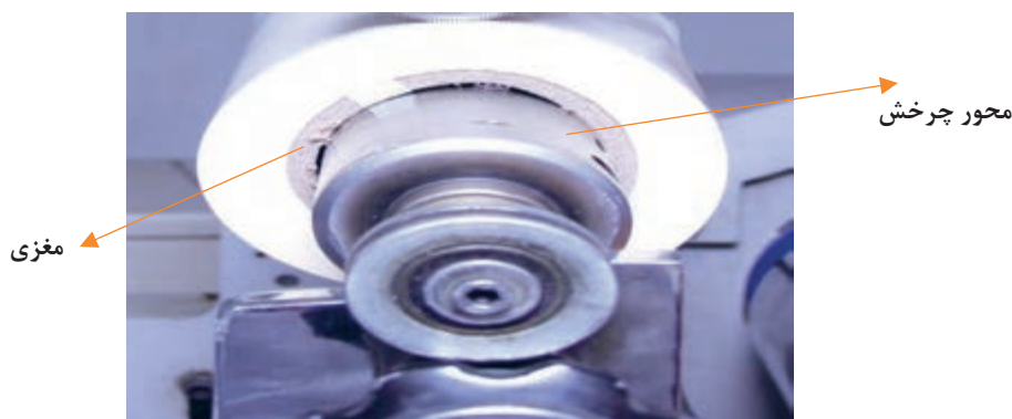
شکل ۲۹- تناسب مغزی سلفون با محور چرخشی دستگاه
