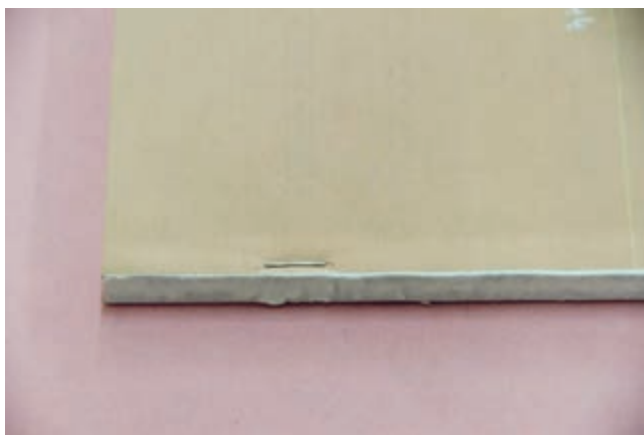
شکل ۱۶- رعایت فاصله مناسب مفتول تا انتهای عطف
