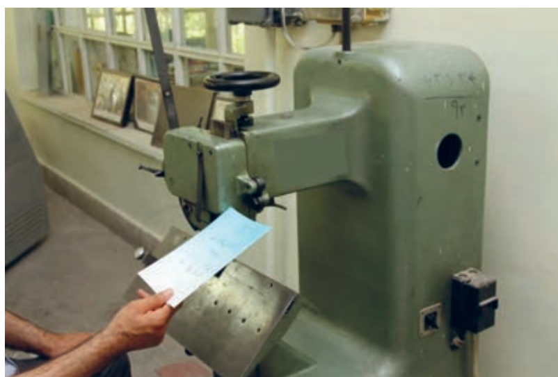
شکل ۳۸- تنظیم‌کننده ضخامت بلوک و طول مفتول
