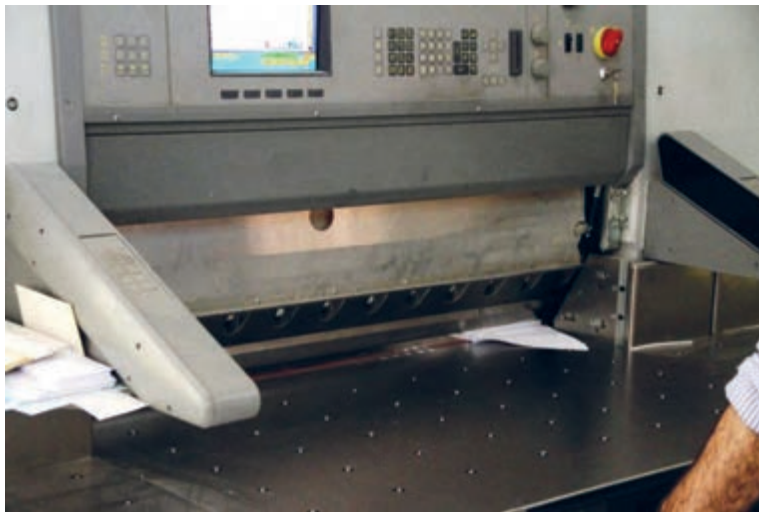
شکل ۷- برش گیوتینی در حال برش بلوک
