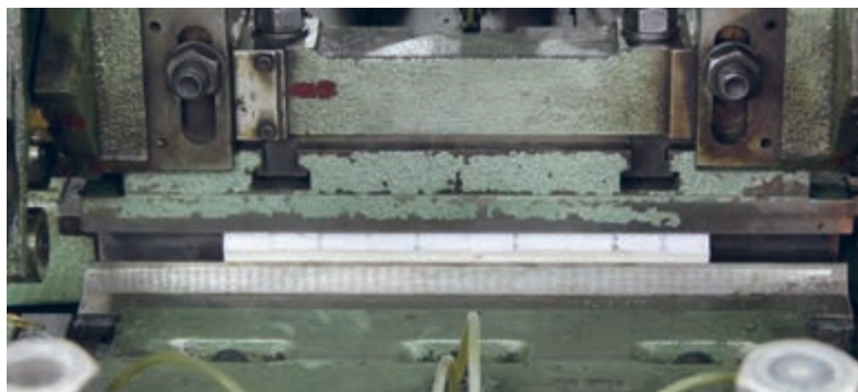
شکل ۵۹- عمل ته‌کوبی عطف بلوک توسط قالب
