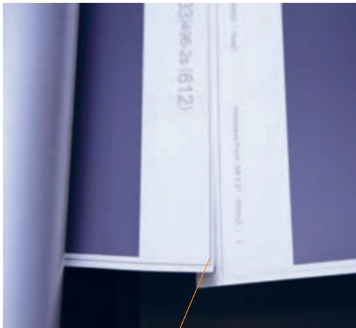
شکل ۳۵ - اورلب کارچاپی و درجه تنظیم آن
