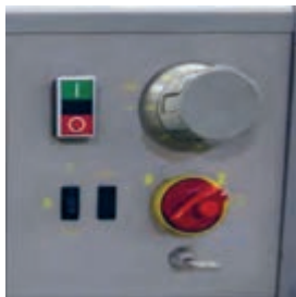
شکل ۳۸- درجه تنظیم فشار دستگاه برش
