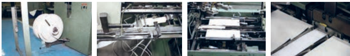
شکل ۴۹- گذاشتن باریکه عطف و برش طولی و عرضی آن
