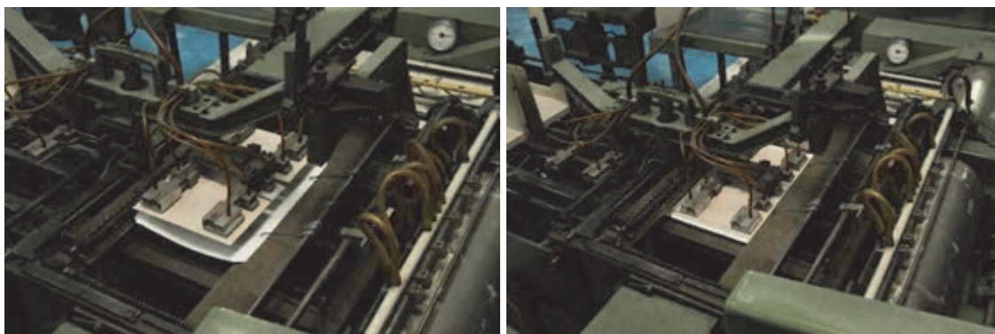
شکل ۵۱- قرار دادن باریکه عطف و لتهای مقوا روی پوشش
