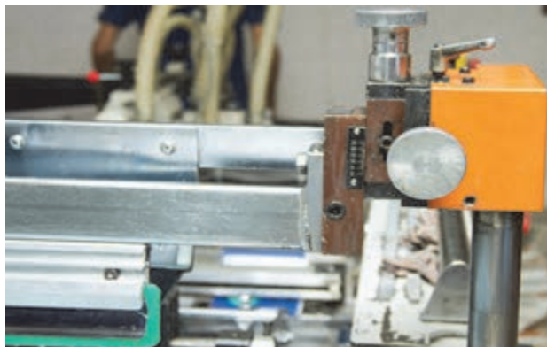
شکل ۱۳- چگونگی تنظیم فشار لبه اسکوییچی
