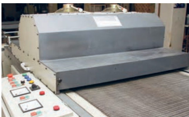
شکل ۱۰- تنظیم به‌کارگیری تعداد لامپ‌های خشک‌کن
