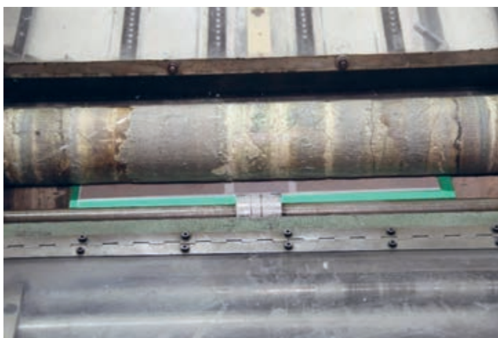
شکل ۵۳- صاف کردن پوشش‌های پرس شده
