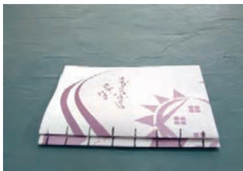
شکل ۱- ایجاد شکاف با فاصله مناسب در عطف کتاب
