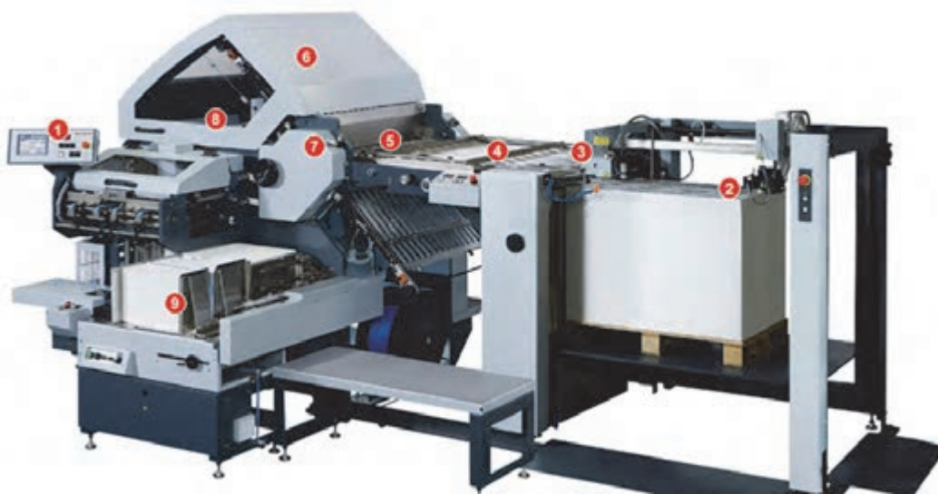
شکل ۵۰- قسمت های اصلی ماشین ورق تاکنی
