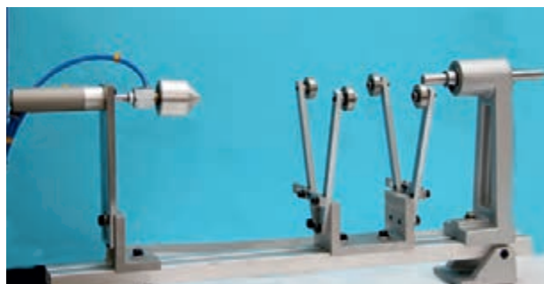
شکل ۱۳-۵ سیستم گرد زن جهت نمونه گیری بر سطوح استوانه ای
