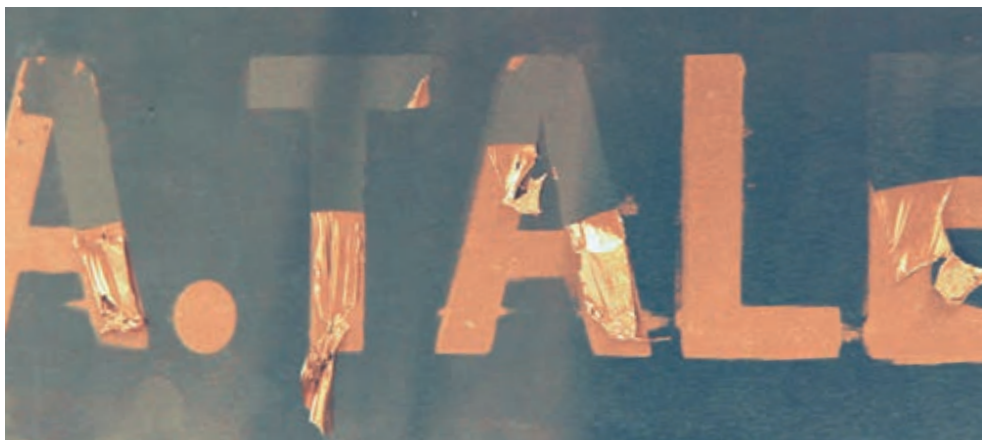
شکل ۱۵-۲ ورقه های نازک مرکب از روی سطح چاپ جدا شده است
