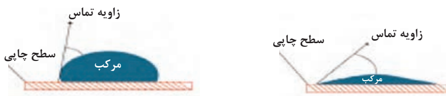
شکل ۳-۴۰ رابطه انرژی سطحی و زاویه تماس
