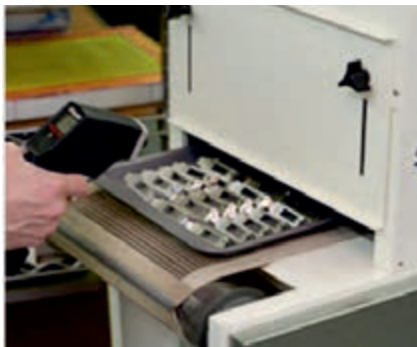
شکل ۳-۶۷- سنجش میزان حرارت خشک کن شکل
