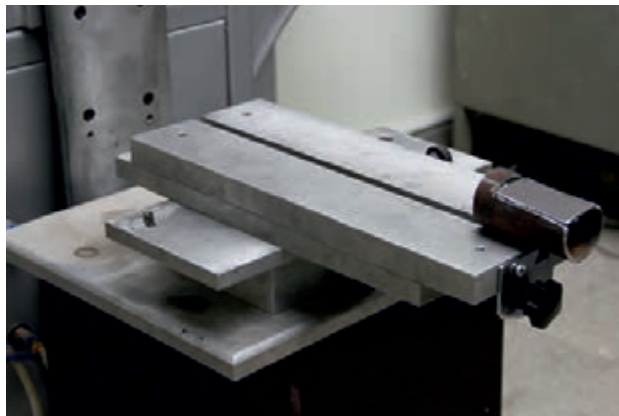
شکل ۵-۸ بستن قالب جای میز دستگاه
