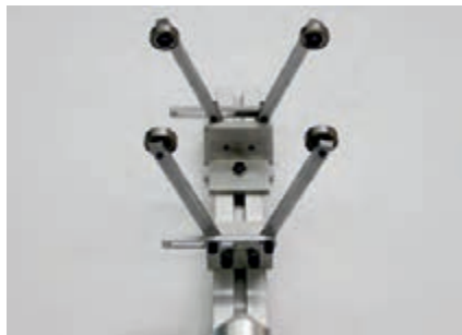
شکل ۵-۱۵ سیستم حرکتی قالب
