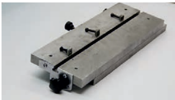
شکل ۲۶-۵ میز شیاردار- فیکسچر به همراه مهره های
