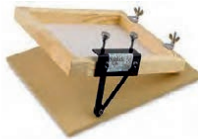
شکل ۲۴ - ۴ پیچ و لولا با پایه نگهدارنده شابلون
