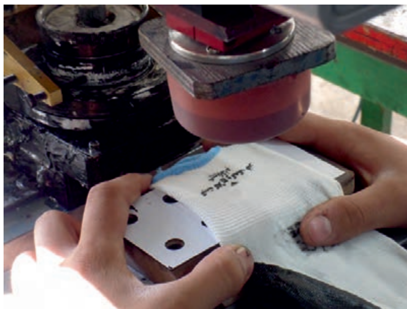
شکل ۳-۳۷ چاپ یک دستکش کار به روش بالشتکی
