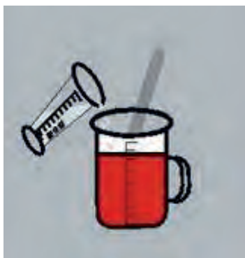
شکل ۴-۹۲ اضافه کردن سخت کننده به ترکیب روغن و مایع سیلیکونی
