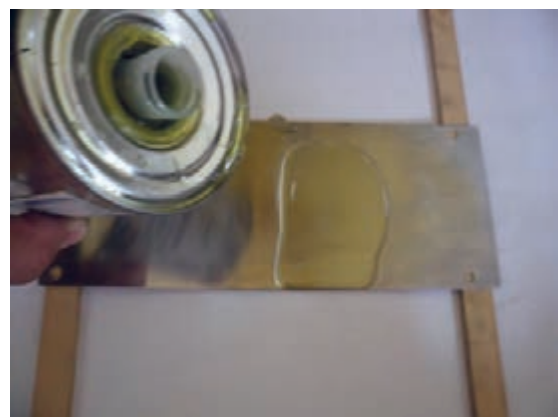
شکل ۴-۱۴- حساس کردن کلیشه خام
