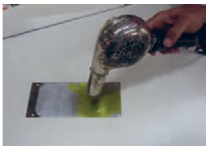
شکل ۴-۲۲- حرارت دادن کلیشه
