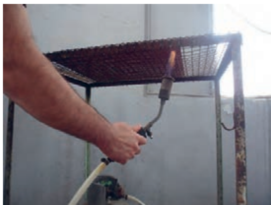
شکل ۴۷-۴- حرارت دادن کلیشه
