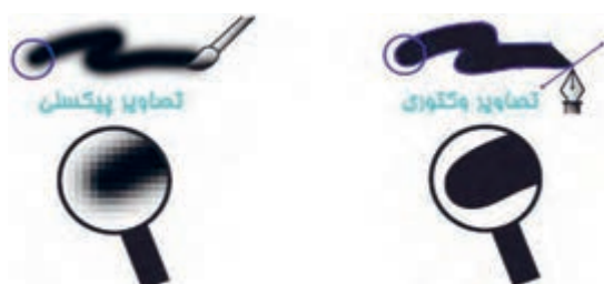
شکل ۵-۲- تفاوت تصویر رستری و وکتوری
