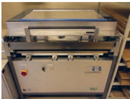
شکل ۱۷-۲ دستگاه قید کپی با نوردهی از پایین
