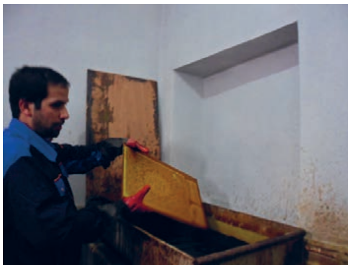
شکل ۴-۴۶- حرارت دادن کلیشه
