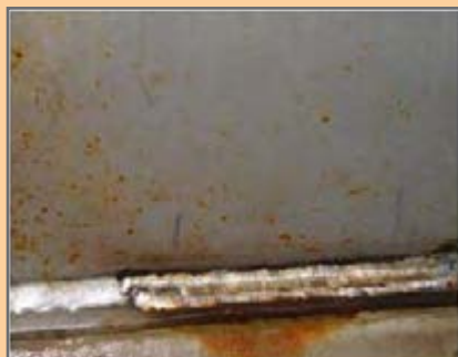
شکل ۴-۶- چگونگی سطوح خورده شده
