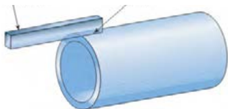
شکل ۲-۳۱- نگهداشتن لوله در حمل جوشکاری
