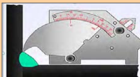
شکل ۱۲-۳- اندازه ساق جوش
