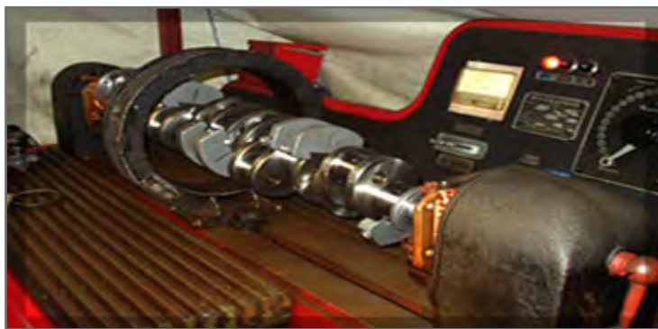
شکل ۵-۱۱ دستگاه ثابت بازرسی با ذرات مغناطیسی در حال بازرسی میل لنگ
