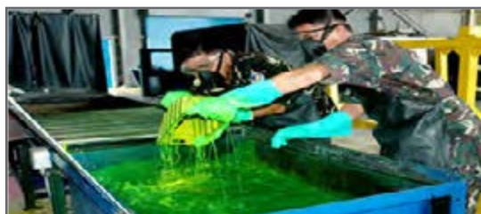
روش غوطه‌وری در مخزن مایع نافذ
