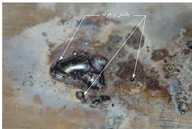
شکل ۴-۳۵: پاشش سخت شده بر روی فلز پایه
