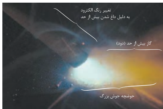
شکل ۴-۳۴- جوشکاری با آمپر بسیار بالا
