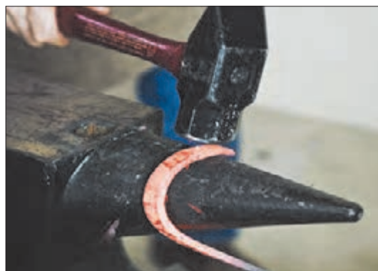
شکل ۳-۴- خمکاری دستی به کمک قالب و چکش
