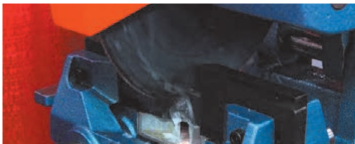
شکل ۱-۱۹- برشکاری با اره آب صابونی
