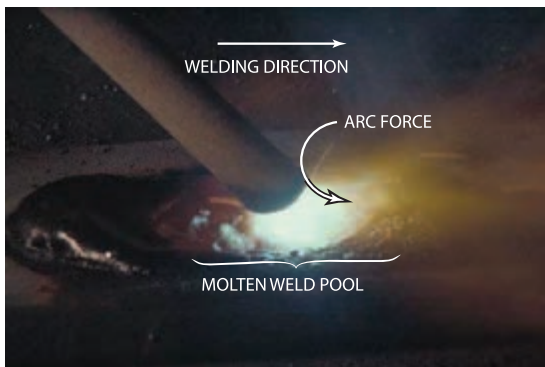
شکل ۴-۴۸- جوشکاری با زاویه پیشران
