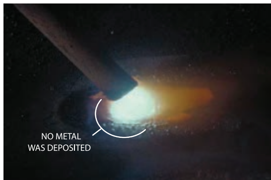
شکل ۴-۵۴- الکتروود نمی‌تواند فلز پایه را ذوب کند و در جوش رسوب نماید.
