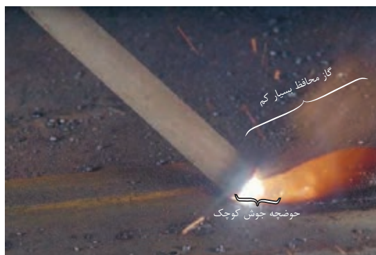
شکل ۴-۳۳- جوشکاری با آمپر بسیار پایین
