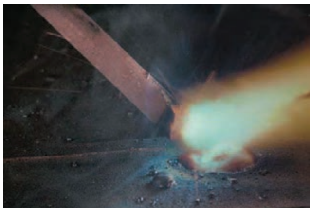
شکل ۴-۳۱- برقراری قوس با الکترودی که روکش آن کنده شده (عدم برقراری قوس پایدار)
