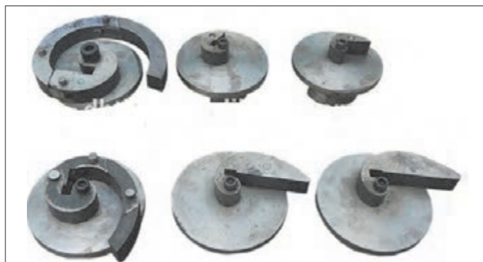
شکل ۳-۲۵- چند نمونه قالب خمکاری با شعاع‌های گوناگون
