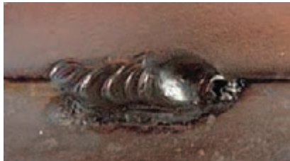
شکل ۴-۵۹- مقطعی باید کوچک و یکنواخت باشد تا تأثیر به جوش نهایی نداشته باشد.
