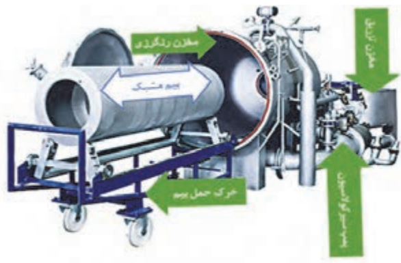
شکل ۱۲ تصویر قسمتهایی از ماشین رنگریزی بیم
