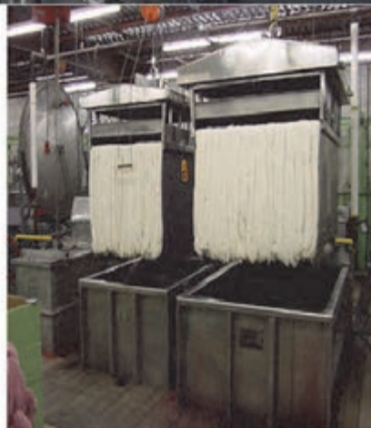
شکل ۲۶ دو ماشین با قابلیت رنگرزی کلاف با ویژگی کالا ثابت و محلول متحرک
