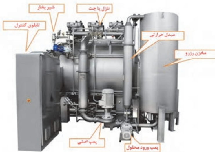
شکل ۷ تصویر قسمت‌های اصلی یک ماشین رنگری جت
