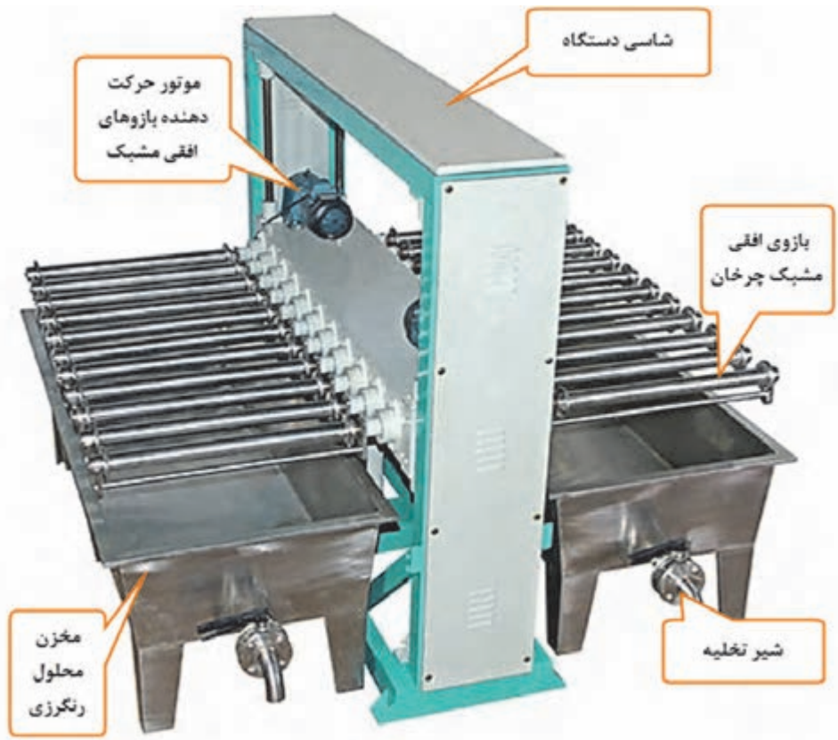
شکل ۲۴ تصویر یک نمونه دستگاه کلاف رنگ‌کنی با بازوهای مشبک چرخان
