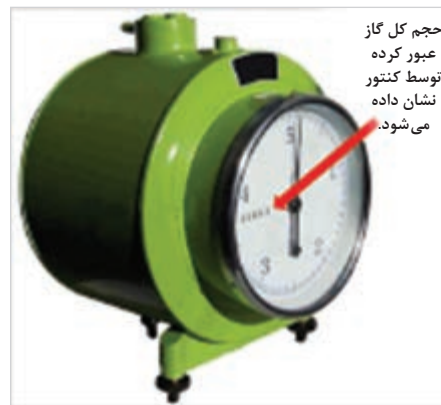
شکل ۲۷- نمای بیرونی جریان سنج گاز به روش تر (که در آزمایشگاه‌ها کاربرد دارد- با یکای لیتر بر ثانیه)
