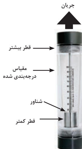
شکل ۷ - یک نمونه روتامتر معمولی
