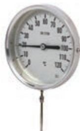
شکل ۴۳- نشانگر عقربه ای دما
