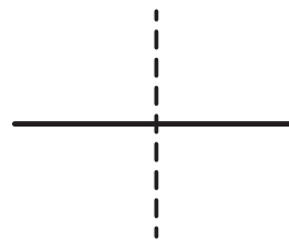
شکل ۱۵- تقاطع دو جریان فرایندی در نمودار جریان فرایند
