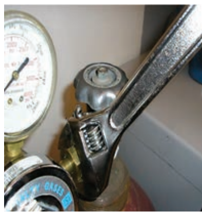
بازکردن شیر تنظیم از کپسول
