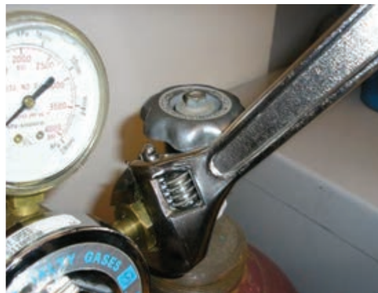
شیوه بستن شیر تنظیم به کپسول
