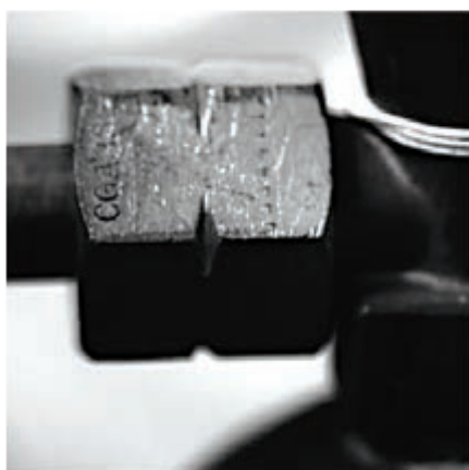
چپ گرد (شیر تنظیم گازهای اشتعال پذیر)
