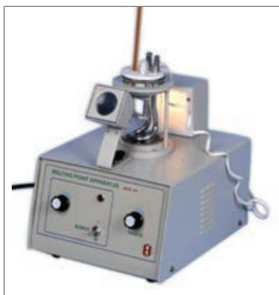
شکل ۳-۷- دو نمونه دستگاه الکتریکی برای اندازه‌گیری نقطه ذوب
