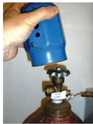
شیوه بازکردن درپوش از کپسول
