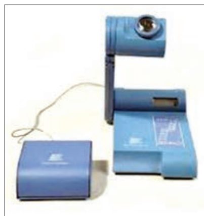
شکل ۳-۷- دو نمونه دستگاه الکتریکی برای اندازه‌گیری نقطه ذوب
