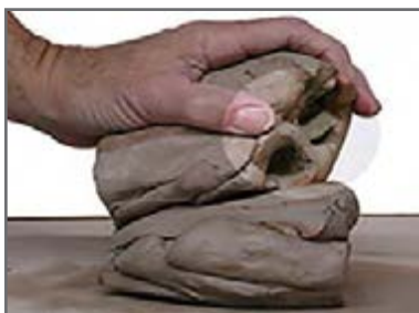
شکل ۴ - بررسی ظاهر گل در هنگام ورز دادن
