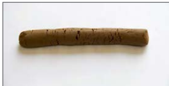
گل با شکل‌پذیری نامناسب – دارای ترک
