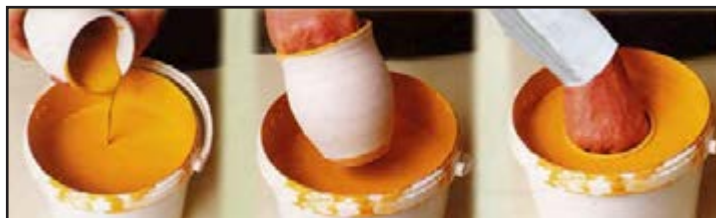
شکل ۱۹- لعاب‌زنی دستی و کارگاهی
