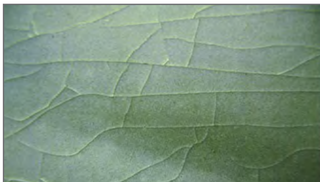
شکل ۲۶- عیب ترک برداشتن لعاب
