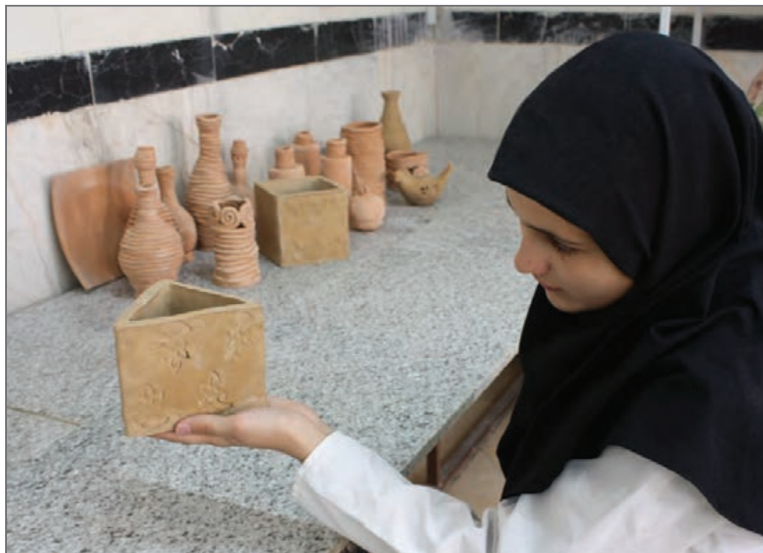
شکل ۱۳- کنترل چشمی فراورده‌های سرامیکی تولید شده به روش دستی
