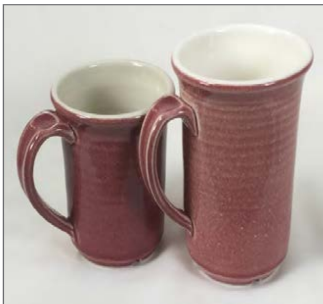
شکل ۲۵- لعاب با دمای پخت نامناسب
