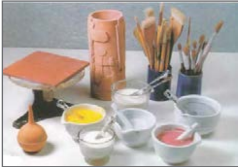
شکل ۱۰- تجهیزات مورد استفاده جهت لعاب‌زنی با قلم‌مو
