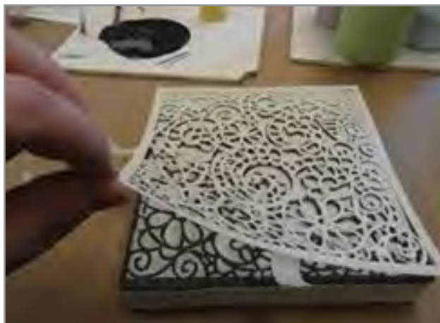
شکل ۳۴- لعاب‌زنی با روش چاپ استنسیل
