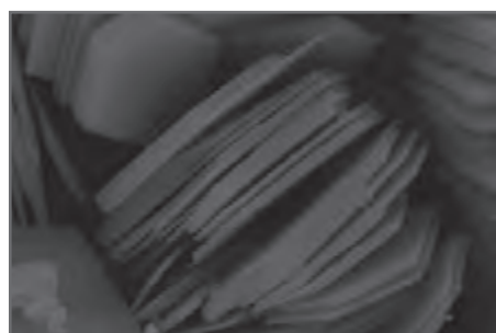
شکل ۱۴ - تصویر میکروسکوپی ذرات رس
