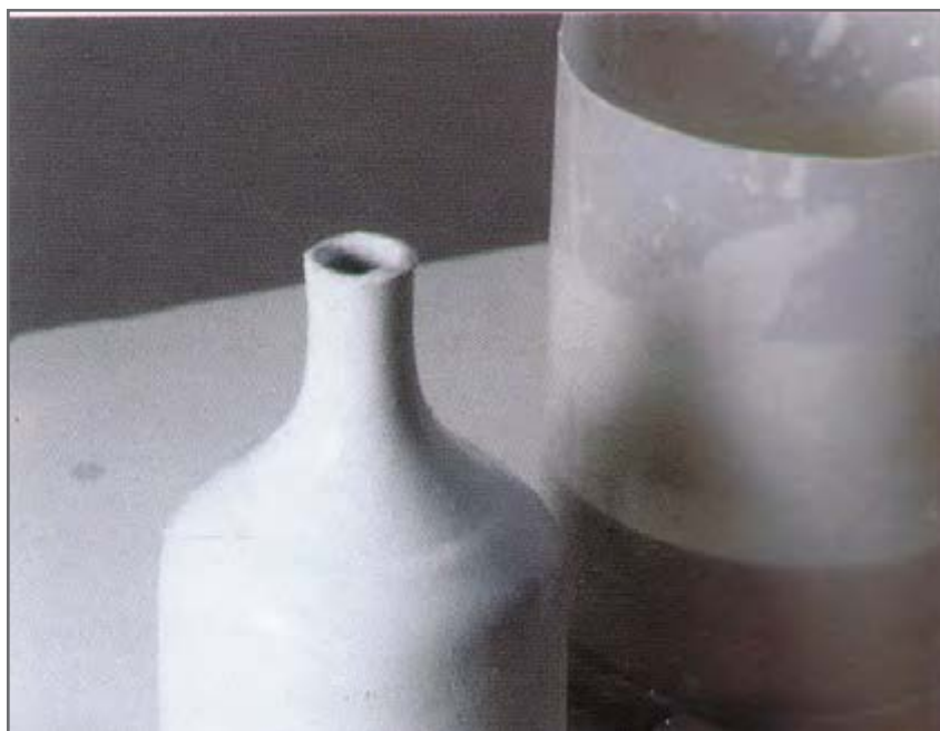
شکل ۱۸- قطعه لعاب زده شده به روش غوطه‌وری
