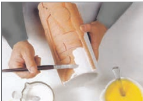
شکل ۱۱- اعمال لعاب بر روی سطح بیرونی قطعه
