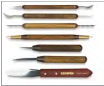
شکل ۱۰- ابزارهای برشی برای ایجاد نقش بریده
