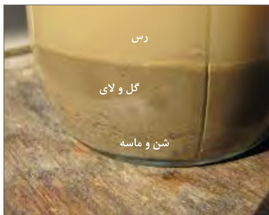
شکل ۱۷- لایه های مختلف دوغاب رس
