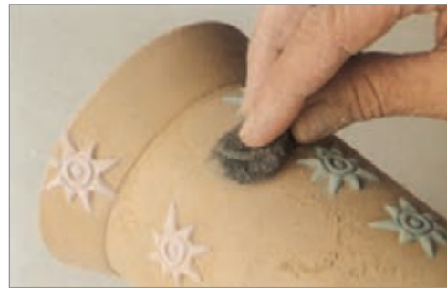
شکل ۱۴- پرداخت بدنه پس از قرار دادن طرح
