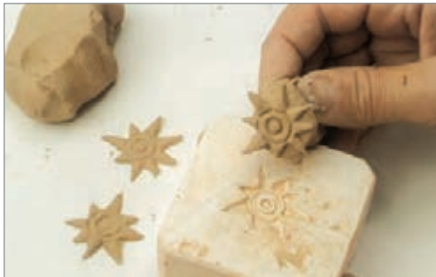
شکل ۱۳- فشار دادن مقداری گل درون قالب
