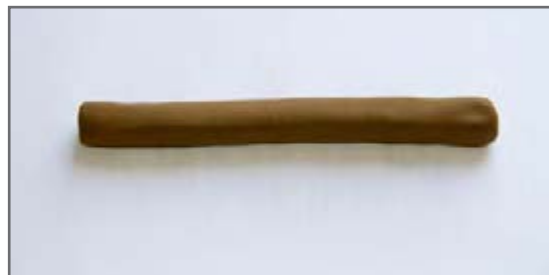
گل با شکل‌پذیری مناسب – بدون ترک
