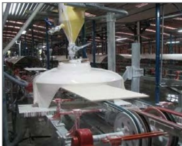
شکل ۲۳- لعاب‌زنی به روش آبشاری
