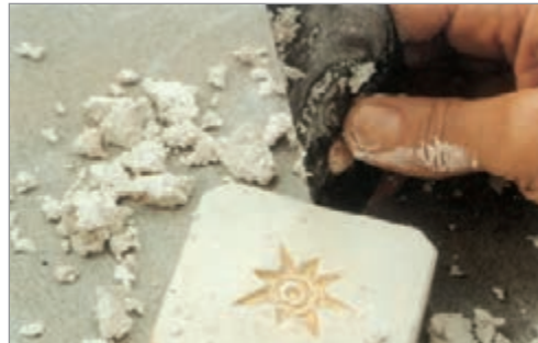
شکل ۱۲- تراشیدن طرح بر روی قالب گچی
