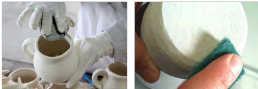
شکل ۹ - پرداخت خشک قطعه با اسکاچ و سنباده
