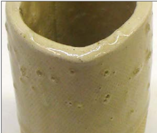
شکل ۳۴- عیب تاول زدن لعاب
