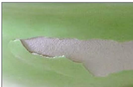
شکل ۲۷- عیب پوسته شدن لعاب
