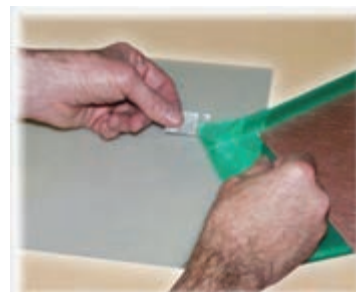
شکل ۳-۱۱- جدا کردن روکش لمینت
