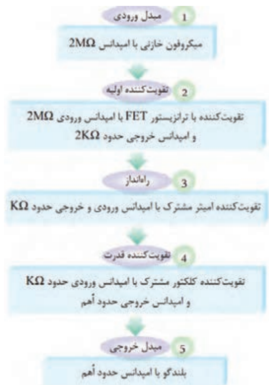
شکل ۳-۴- بلوک دیاگرام اتصال چند طبقه تقویت‌کننده به‌هم
