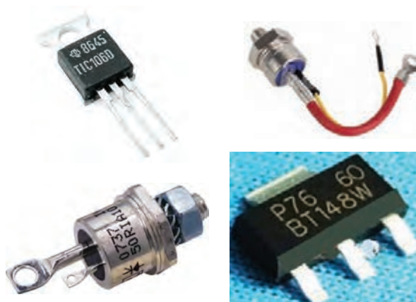
شکل ۸-۷ بسته‌بندی چند نمونه SCR
