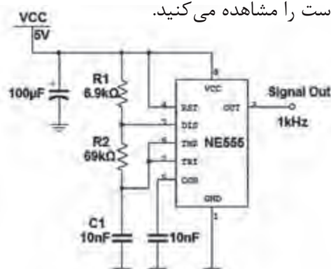
شکل ۲-۲۷- مدار مولد موج مربعی با آی سی ۵۵۵
