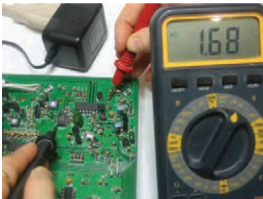
شکل ۵-۵- ولتاژگیری در مدار
