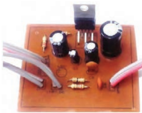
شکل ۴-۹۰- مدار مونتاژ شده تقویت کننده
