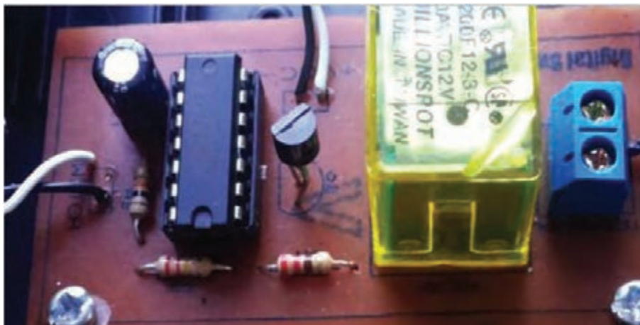
شکل ۴-۹۶- مدار مونتاژ شده کلید الکترونیکی
