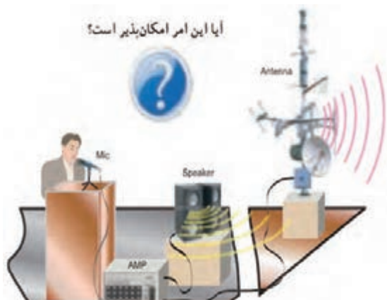
شکل ۶-۴۷ تبدیل امواج صوتی به امواج الکترومغناطیس
