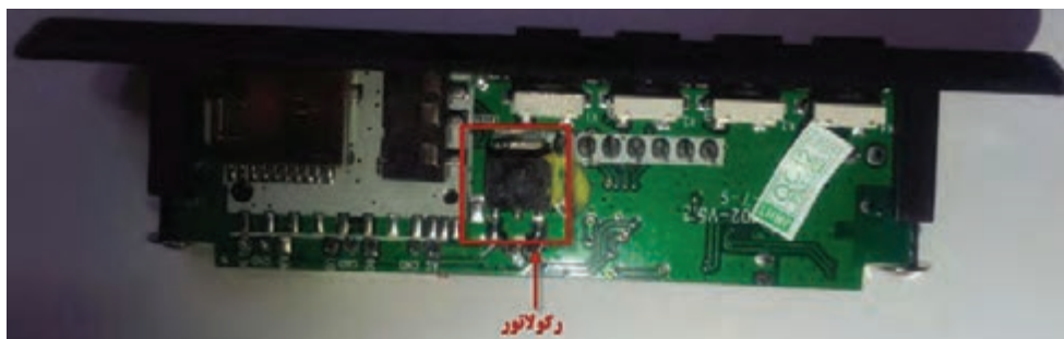
شکل ۵-۸- برد MP۳ با رگولاتور ۷۸۰۵ داخلی
