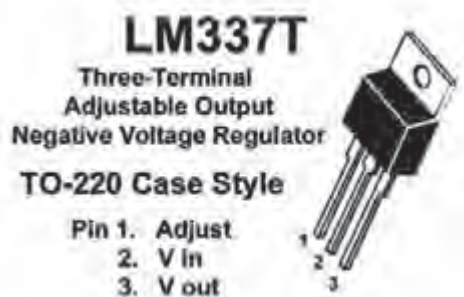
شکل ۱۶-۲: شکل ترانسفورماتور کاهنده ۲۲۰ به ۱۸ ولت دوبل شکل ۱۷-۲: ترتیب پایه های آی سی رگولاتور LM337
