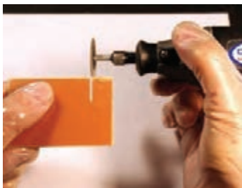
شکل ۳-۸- بریدن فیبر با مینی فرز
