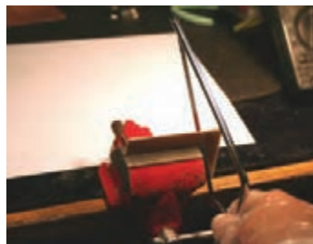
شکل ۳-۷- بریدن فیبر با اره آهن بر
