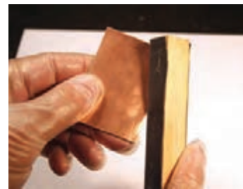
شکل ۳-۶- پرداخت کردن لبه فیبر
