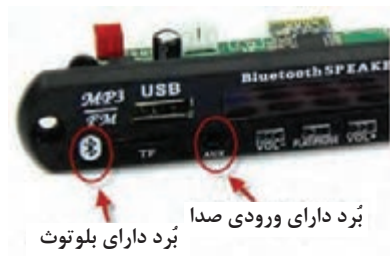
شکل ۵-۷- بُرد دارای بلوتوث و ورودی صدا
