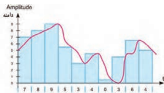
شکل ۶-۷۰ نمونه‌برداری از سیگنال آنالوگ
