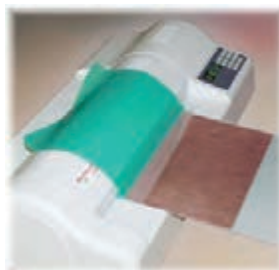
شکل ۱۵-۳ ورود فیبر به لمینتور
