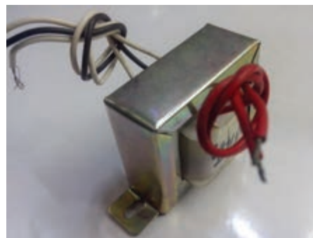
شکل ۱۶-۲: شکل ترانسفورماتور کاهنده ۲۲۰ به ۱۸ ولت دوبل شکل ۱۷-۲: ترتیب پایه های آی سی رگولاتور LM337
