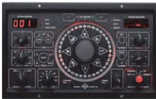
شکل ۲۷- قسمت قرار دادن راه (Set Course Unit)
