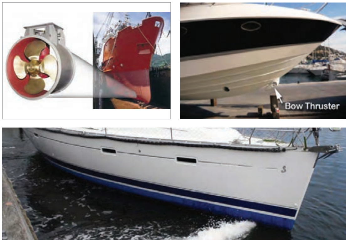
شکل ۶- پروانه‌های جانبی سینه شناور (Bow Thruster)
