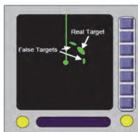
شکل ۱۶- نمایش پژواک‌های جانبی در صفحه نشانگر رادار
