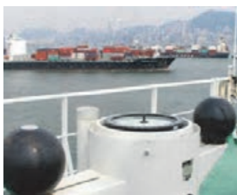
شکل ۲- پایه و گوی‌های تنظیم‌کننده قطب‌نما
