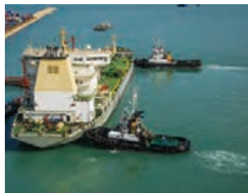
شکل ۲۹- عملیات یدک‌کشی پهلوبه‌پهلوی
