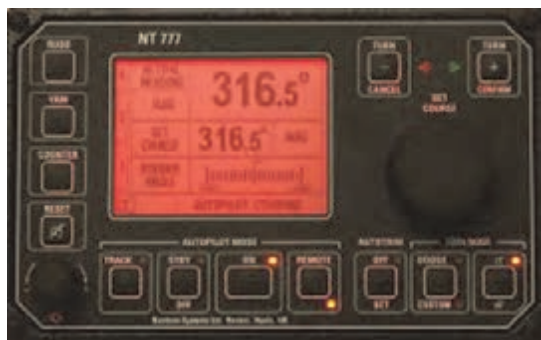
شکل ۲۷- قسمت قرار دادن راه (Set Course Unit)
