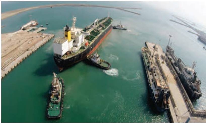
شکل ۲۰- عملیات پهلو دهی کشتی به اسکله
