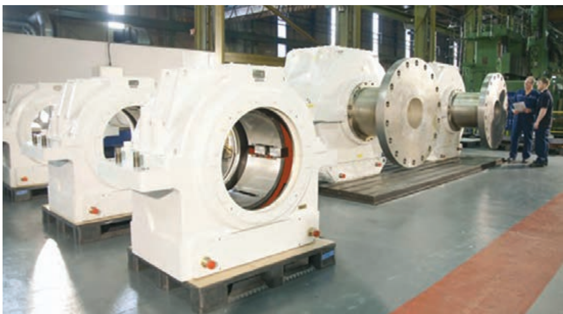
شکل ۲۴- یاتاقان‌های مورد استفاده جهت تکیه‌گاه محور پروانه
