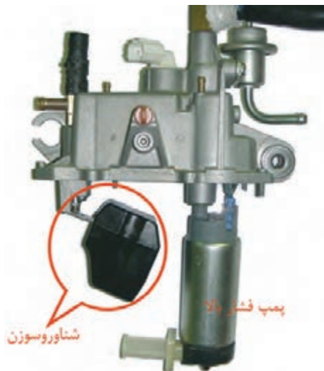
شکل ۸- مجموعه داخل مخزن تفکیک بخار
