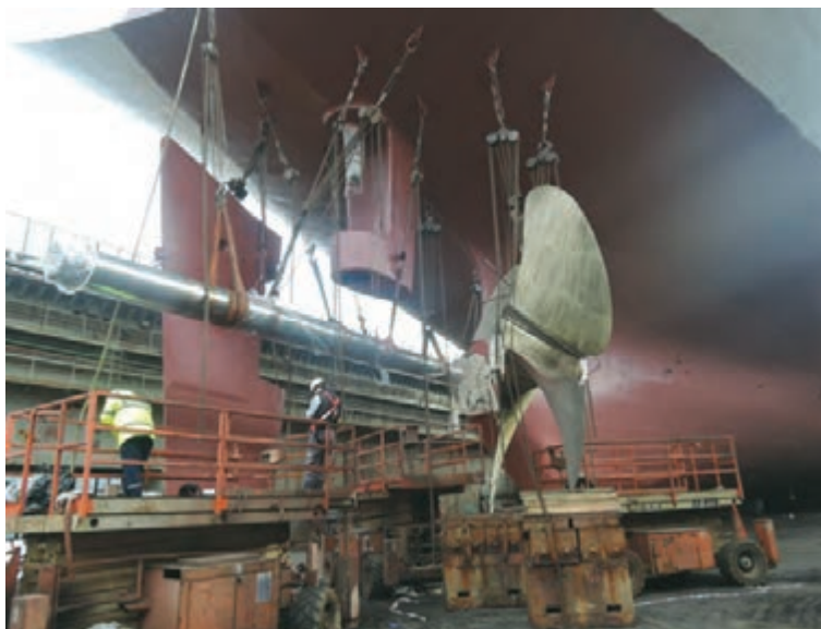
شکل ۲۰- طریقه خارج‌سازی محوره‌های پروانه در نوع معمولی
