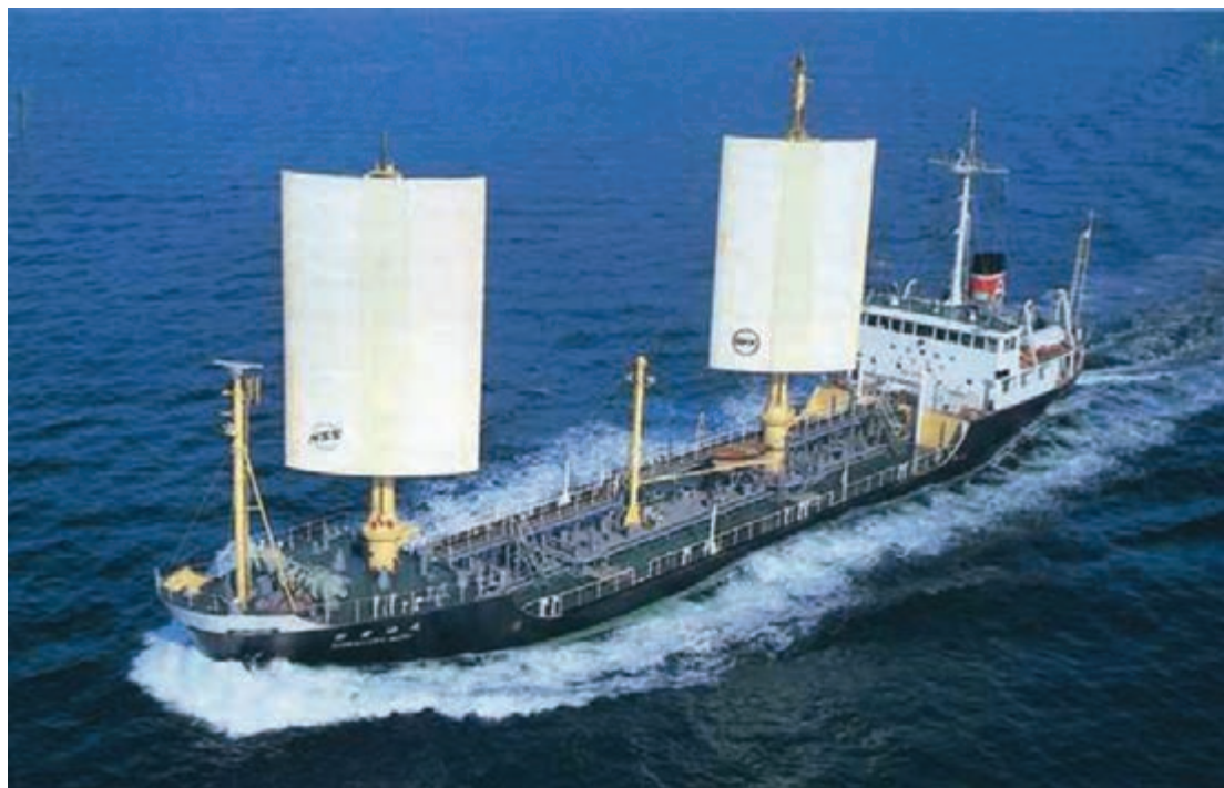
شکل ۴- استفاده از انرژی باد در حرکت کشتی‌ها
