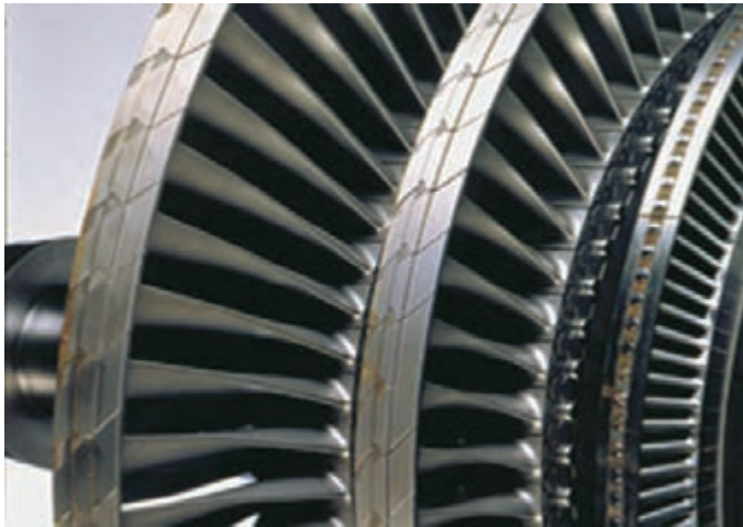
شکل ۷- محل اتصال پره‌ها با چرخ
