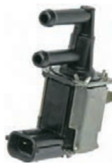
شکل ۱۴- شیر برقی کنیستر
