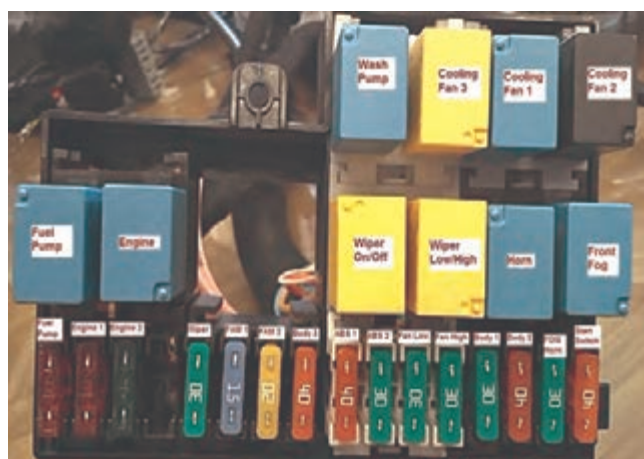
شکل ۲۰- جعبه فیوز یک خودرو
