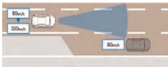
شکل ۳۳- کنترل سرعت شتاب در سرعت‌های کم
