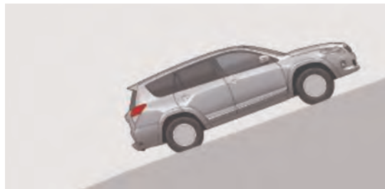
شکل ۲۵- سیستم HAC کمک می‌کند تا کنترل پایداری در سطوح شیب‌دار را افزایش دهد و از پس روی خودرو جلوگیری کند.
