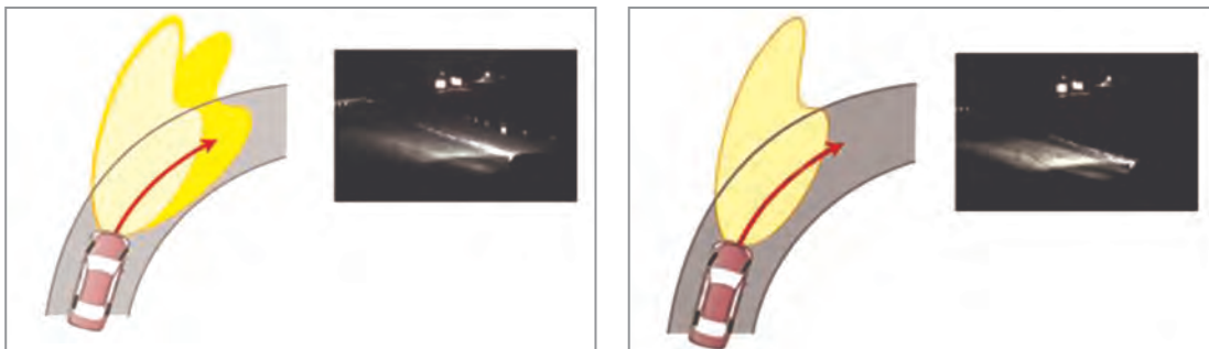
شکل ۴۲- خودروی دارای سیستم AFS
