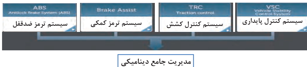
شکل ۲۴- مدیریت جامع دینامیکی خودرو
