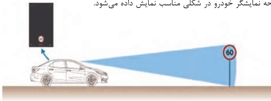
شکل ۴۰- سیستم تشخیص علائم جاده
