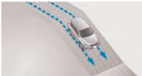
شکل ۲۷- سیستم DAC هنگام حرکت رو به پایین روی سطوح شیب‌دار و لغزنده، کنترل خودرو را بهبود می‌بخشد.
