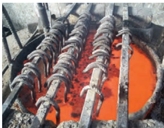
شکل ۲۰- وارد کردن قطعات سیم‌بندی شده در حمام نمک
