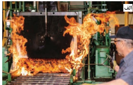
شکل ۱۷- نمونه‌ای از ورود قطعات در کوره‌ها با اتمسفر کنترل شده، (الف) روشن شدن مشعل در کوره هنگام وارد کردن قطعات، (ب) بسته شدن در کوره بعد از وارد شدن قطعات
