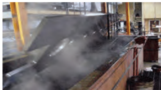
شکل ۲۰- عملیات سیاه کاری
