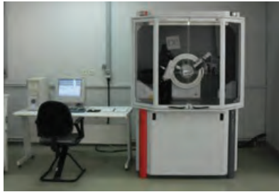
شکل ۹- دستگاه آنالیز اشعه X جهت بررسی ساختار شبکه‌ای فلزات
