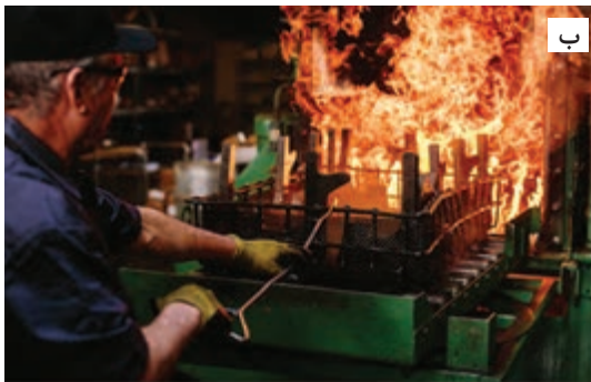
شکل ۱۷- نمونه‌ای از ورود قطعات در کوره‌ها با اتمسفر کنترل شده، (الف) روشن شدن مشعل در کوره هنگام وارد کردن قطعات، (ب) بسته شدن در کوره بعد از وارد شدن قطعات
