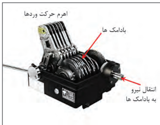
شکل ۱۱- مکانیزم بادامک خارجی
