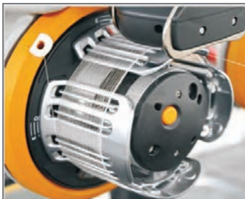
شکل ۲۸- یک مکانیزم ذخیره نخ پود استوانه‌ای
