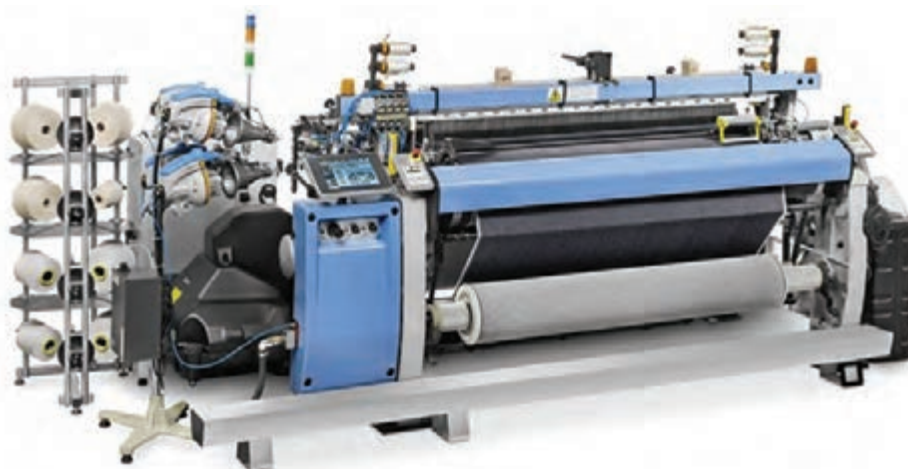
شکل ۲۱- یک دستگاه بافندگی با مکانیزم ایرجت
