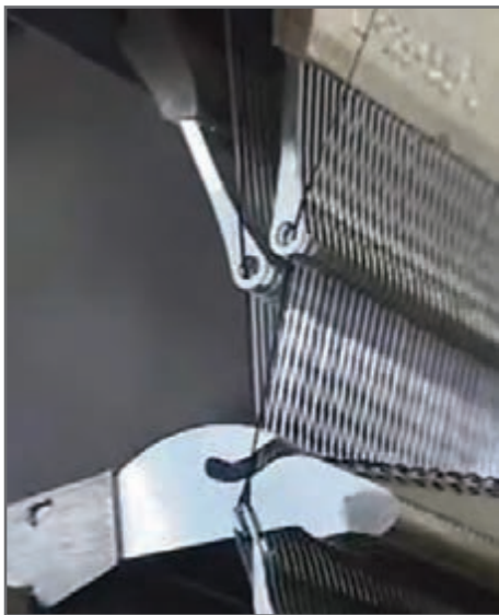
شکل ۴۵- حرکت سوزن به پایین ترین نقطه در تشکیل حلقه
