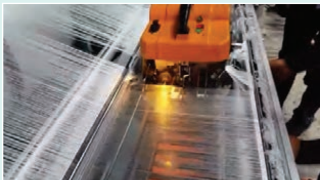
شکل ۲۵ - گره زدن نخ‌های لایه زیر (نخ‌های روی ماشین) با نخ‌های لایه رو (نخ‌های روی قرقره جدید)
