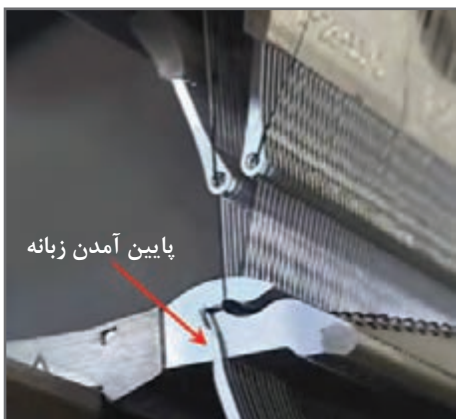
شکل ۴۶- مرحله دهم پایین آمدن زبانه و حرکت به بالای سوزن
