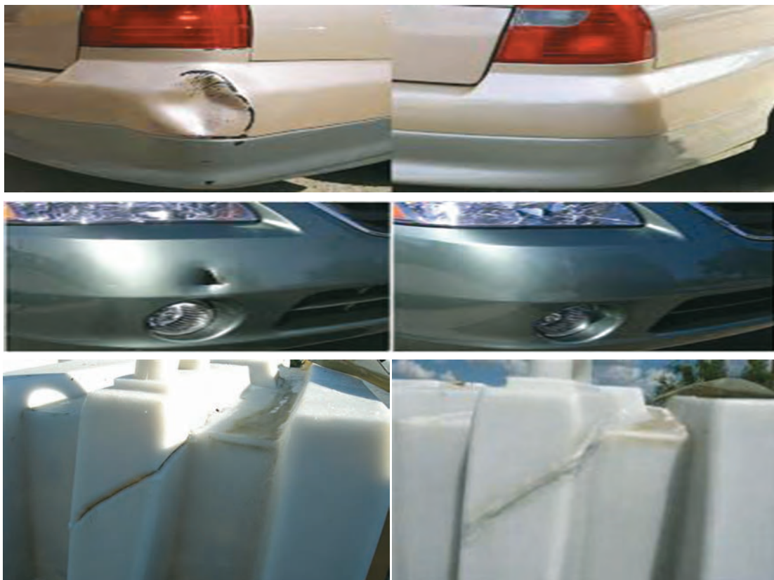
شکل ۲۴- نمونه‌هایی از جوش تعمیراتی قبل و بعد از جوشکاری
