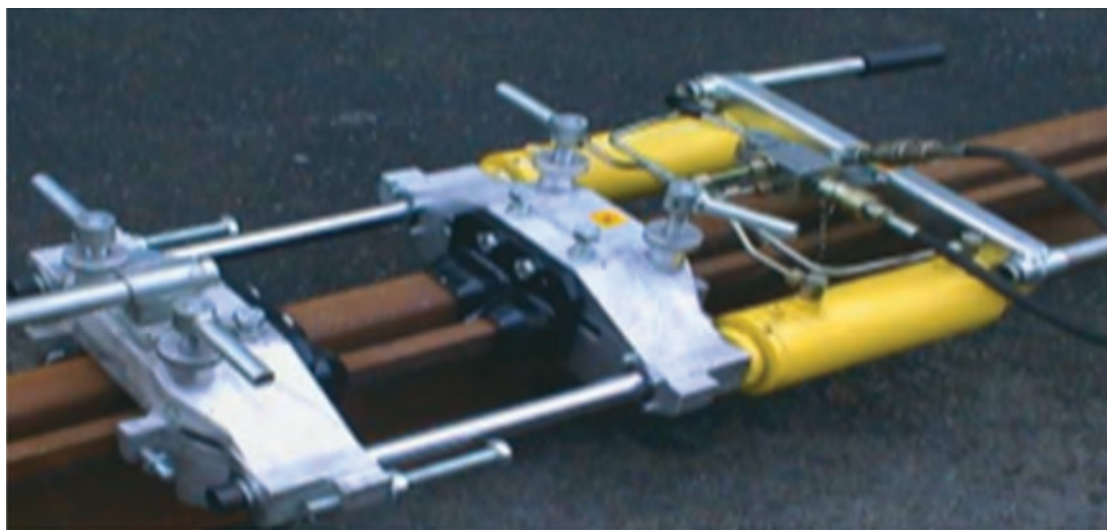
شکل ۱۲- ماشین هیدرولیک برش گرده اضافه جوش
