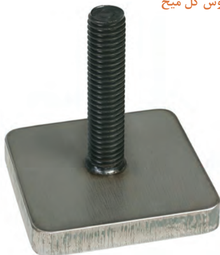
شکل ۲- اتصال ایجاد شده به روش گل میخ
