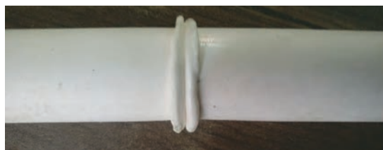
شکل ۲۱- سمت راست) جوشکاری لوله بدون بوشن - سمت چپ) جوشکاری لوله با استفاده از بوشن
