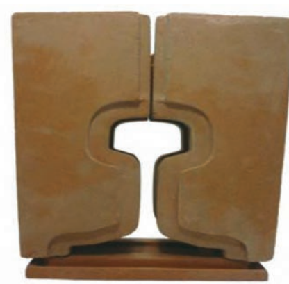
شکل ۷- قالب جوشکاری ترمیت و قرارگیری آن در اطراف ناحیه اتصال
