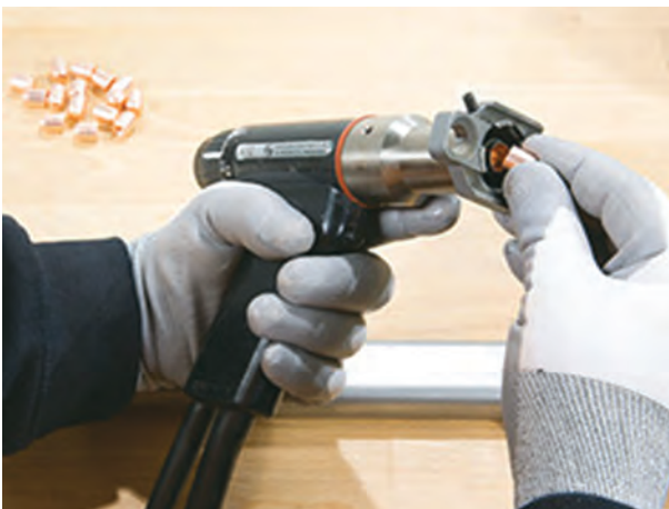
شکل ۲۰- قرار دادن محافظ سرامیکی
