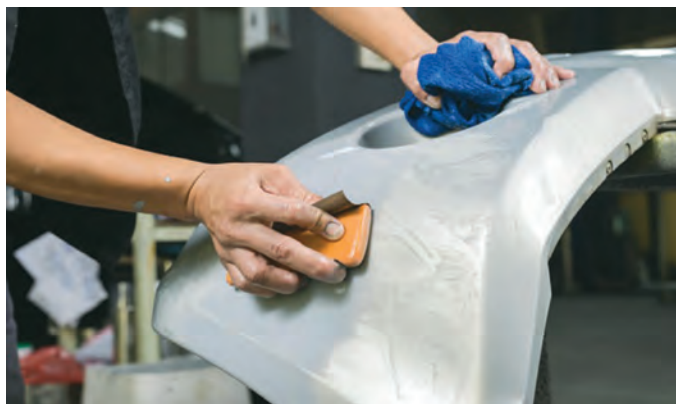
شکل ۳۱- پولیش قطعه کار پس از تعمیر
