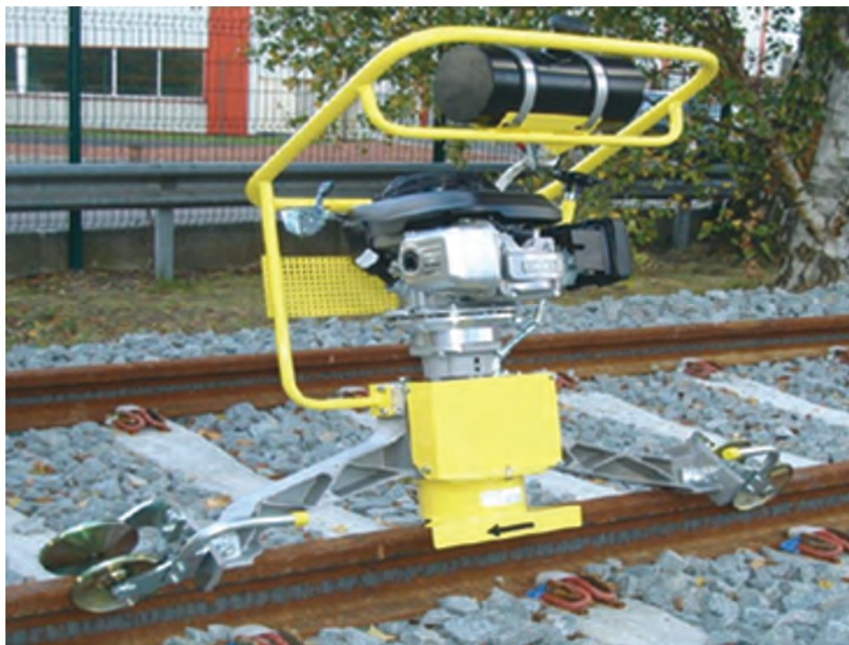
شکل ۱۳- ماشین اتوماتیک سنگ زنی گرده اضافی جوش
