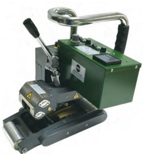
شکل ۷- جوشکاری با غلتک‌های داغ (Hot Rollers Welding) و دستگاه جوش آن
