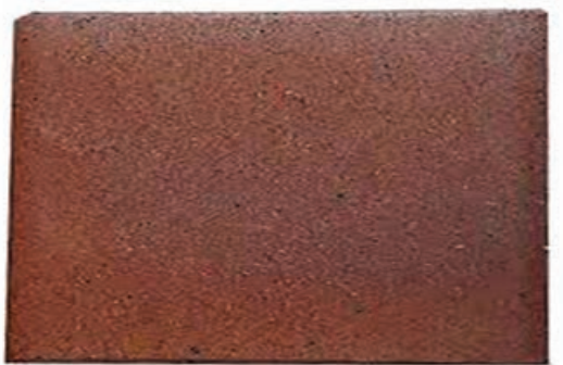
شکل ۸- سینی و آجر نسوز قالب جوشکاری
