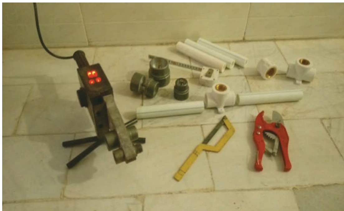
شکل ۲۰- تجهیزات جوشکاری لوله های پلاستیکی
