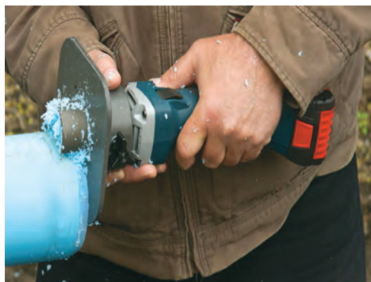
شکل ۲۵- پخ زدن قطعات پلاستیکی برای جوشکاری
