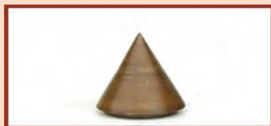
شکل ۱۰- قطعه مخروطی برای باز دهانه لوله
