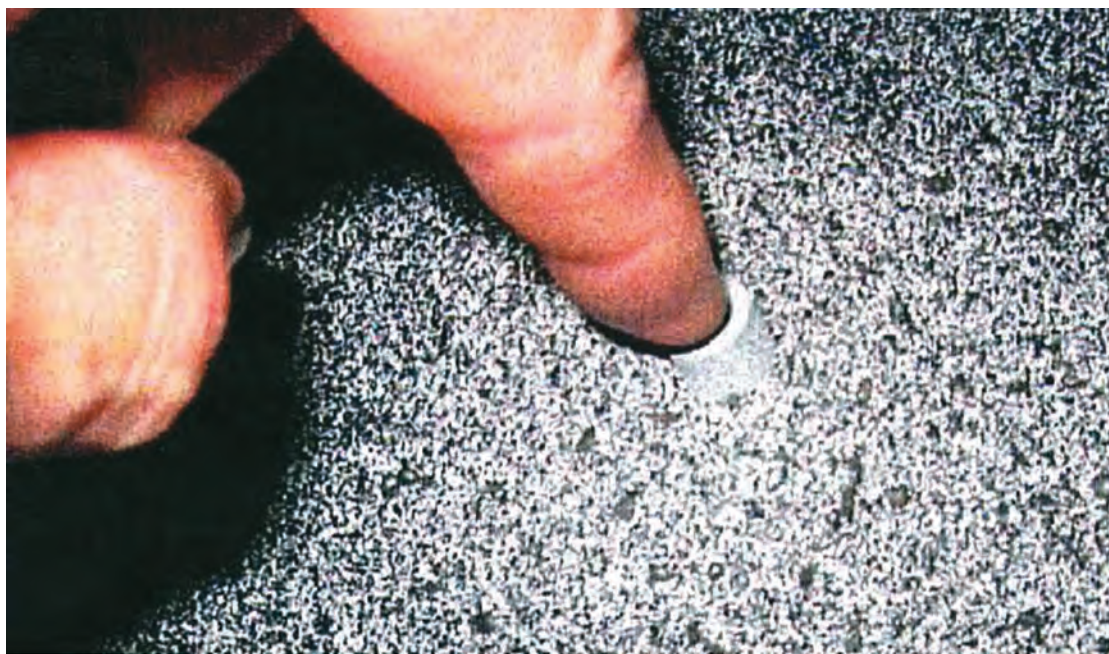
شکل ۲۲- شارژ بوته و استقرار فعال کننده بر روی آن
