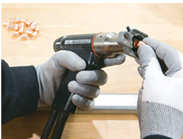
شکل ۱۹- قرار دادن گل میخ در داخل نگهدارنده
