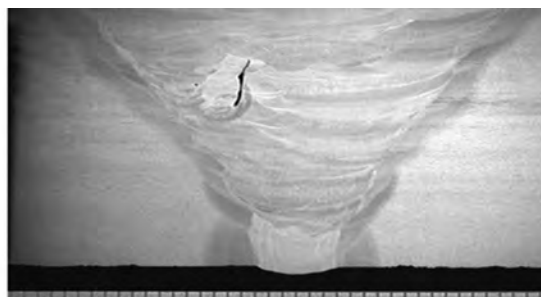
شکل ۳۳- ترک های داخلی درون جوش
