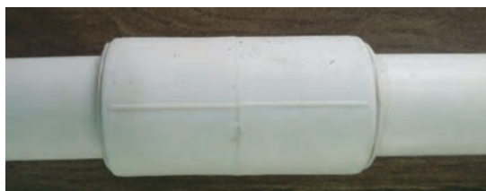
شکل ۲۱- سمت راست) جوشکاری لوله بدون بوشن - سمت چپ) جوشکاری لوله با استفاده از بوشن
