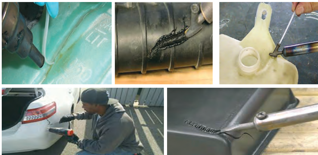
شکل ۲۳- جوشکاری تعمیراتی قطعات پلاستیکی
