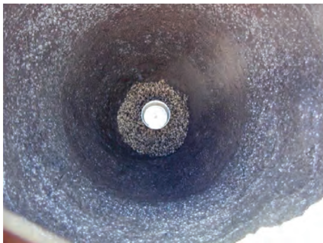
شکل ۲۱- استقرار دیسک ذوب شونده در انتهای بوته
