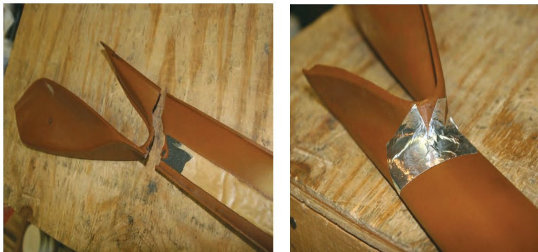
شکل ۲۹- هم‌تراز کردن قطعه به کمک فویل آلومینیومی
