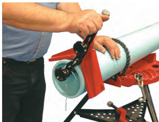
شکل ۲۵- پخ زدن قطعات پلاستیکی برای جوشکاری
