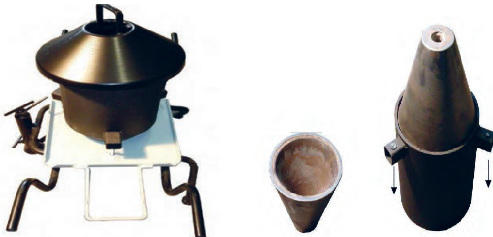
شکل ۶- بوتله نگهدارنده مذاب
