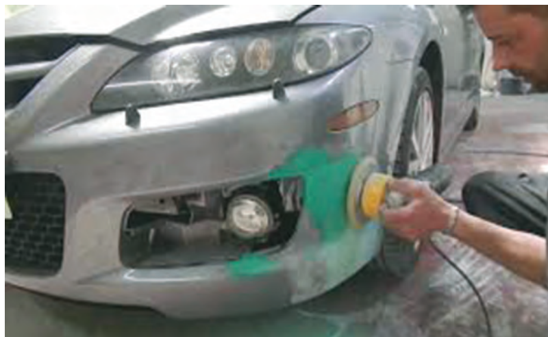
شکل ۲۸- تمیزکاری سپر خودرو
