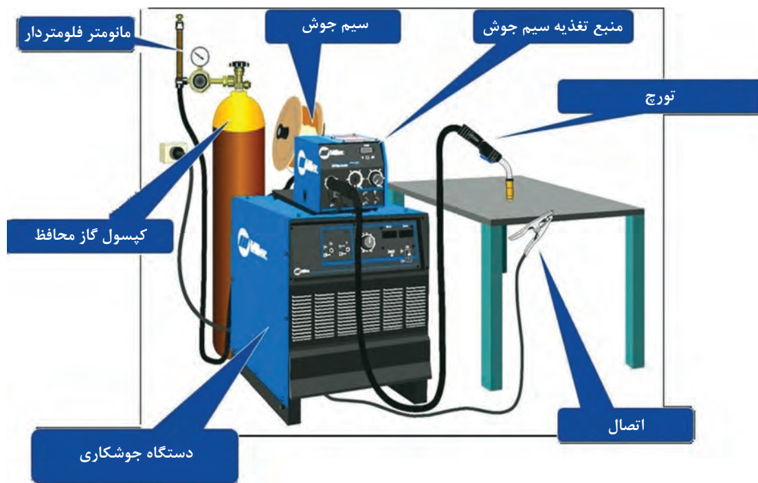
شکل ۶- قسمت های مختلف دستگاه جوشکاری FCAW
