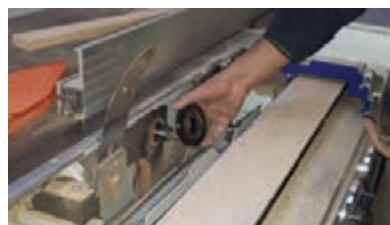
شکل ۶۲- باز کردن مهره و فلنج جلوی تیغه
