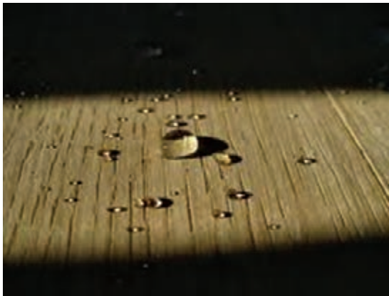
شکل ۷۲- نمونه چوب ضدآب شده با کمک نانوذرات
