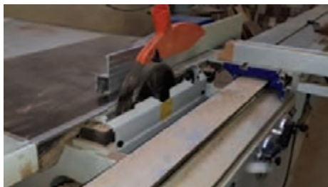
شکل ۶۷- بستن حفاظ و کاور روی تیغه ااره
