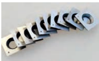
شکل ۲۵- تیغه‌های قابل تعویض که به جای تیغه‌های سراسری روی توپی رنده قرار می‌گیرد
