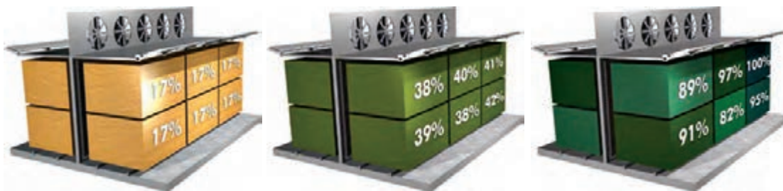
شکل ۶۸- مراحل مختلف خشک کردن چوب در کوره
