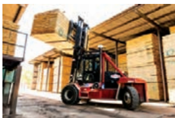
شکل ۱۶- جابه جا کردن واحد دسته بندی به وسیله لیفتراک (سمت چپ) و جرثقیل (سمت راست)
