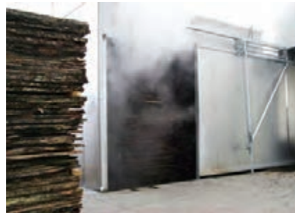
شکل ۶۹- خروج چوب‌های خشک شده از کوره
