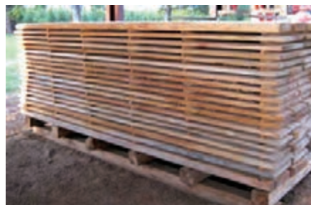
شکل ۱۳- روش چوب‌دستک‌گذاری در دسته‌های چوب
