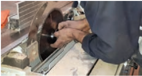
شکل ۶۵- بستن تیغه نو و نصب فلنج جلوی تیغه ااره
