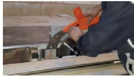
شکل ۶۷- بستن حفاظ و کاور روی تیغه ااره
