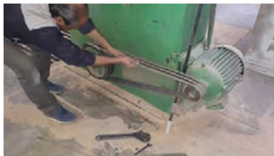
شکل ۶۰- تعویض و جایگزین کردن تسمه
