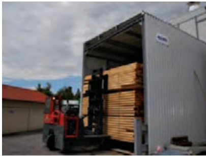
شکل ۷۰- تخلیه واحدهای دسته‌بندی پس از پایان خشک کردن
