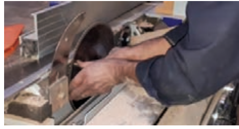
شکل ۶۵- بستن تیغه نو و نصب فلنج جلوی تیغه ااره
