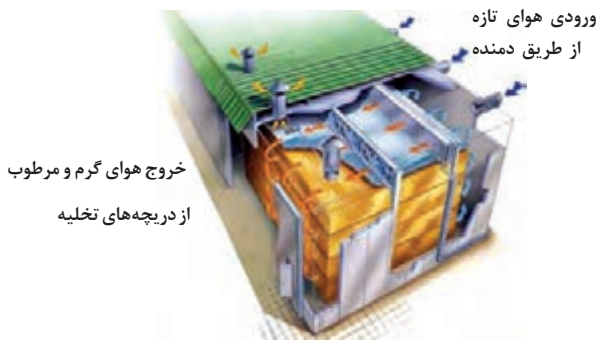
شکل ۴۵- کوره چوب خشک‌کنی مجهز به سیستم جریان اجباری هوا با دمنده خارجی
