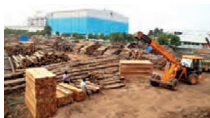
شکل ۱۶- جابه جا کردن واحد دسته بندی به وسیله لیفتراک (سمت چپ) و جرثقیل (سمت راست)
