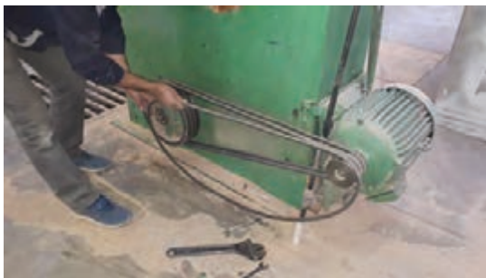
شکل ۶۰- تعویض و جایگزین کردن تسمه
