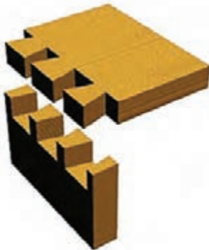
شکل ۲۷- تصویر سه بعدی از اتصال گوشه‌ای دم چلچله با سه زبانه و چهار فاق
