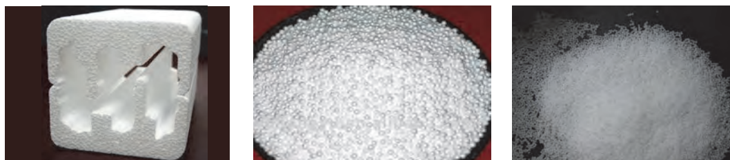
شکل ۱۳- از راست به چپ: گرانول پلی‌استیرن انبساطی، گرانول منبسط شده و محصول نهایی که با نام یونولیت می‌شناسید.
